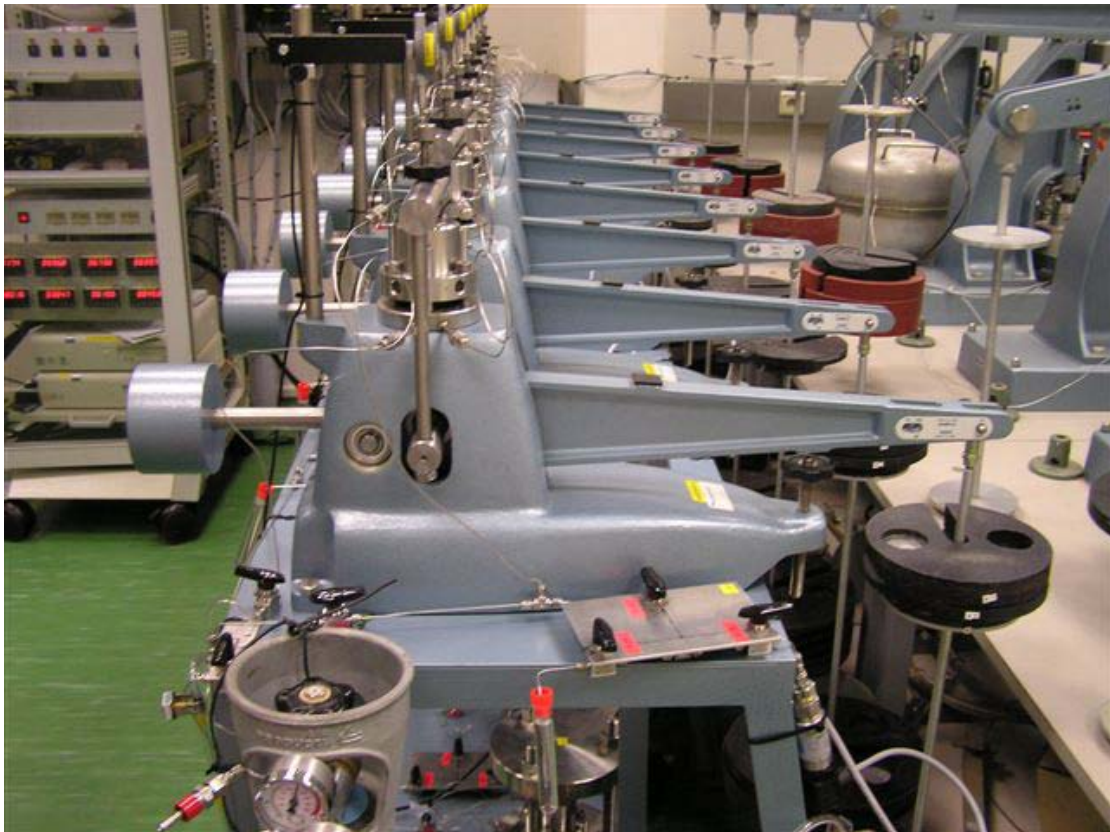
ΕΙΚΟΝΑ 4.4 Η ΣΥΣΚΕΥΗ ΤΟΥ ΣΥΜΠΙΕΣΟΜΕΤΡΟΥ
