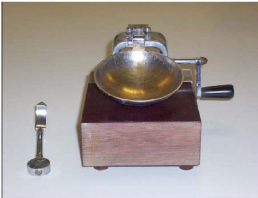
ΕΙΚΟΝΑ 4.1 ΣΥΣΚΕΥΗ CASAGRANDE ΓΙΑ ΤΟΝ ΠΡΟΣΔΙΟΡΙΣΜΟ ΤΩΝ ΟΡΙΩΝ ΥΔΑΡΟΤΗΤΑΣ
