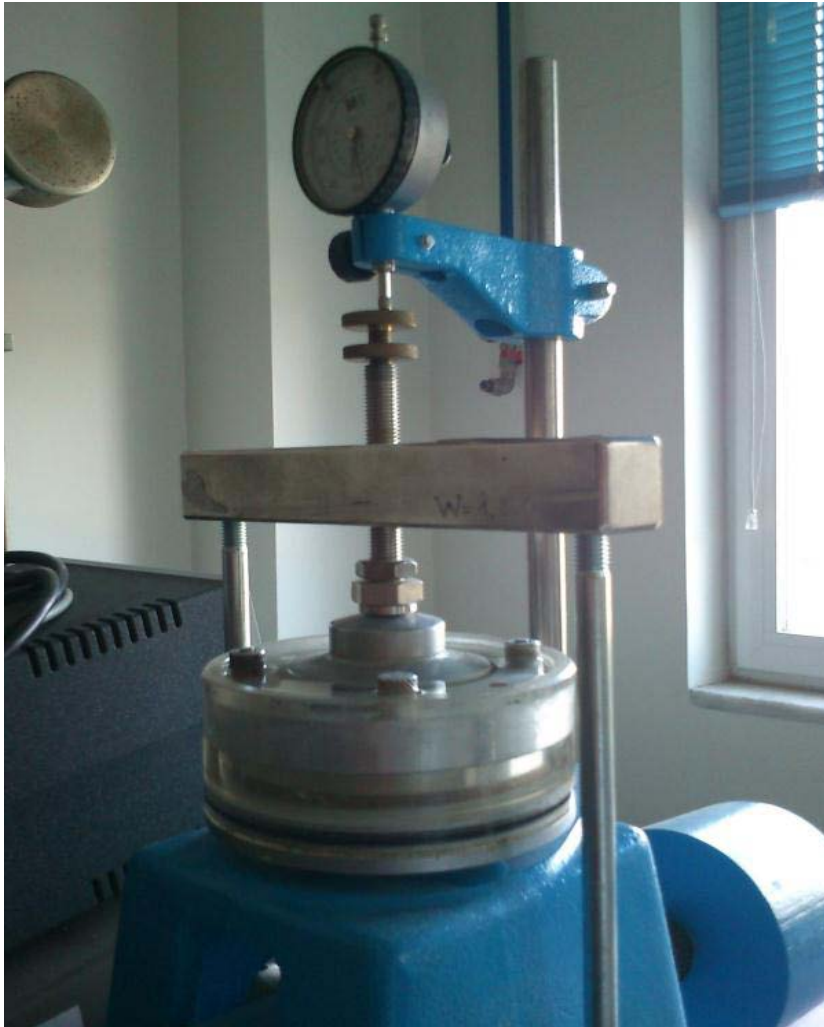
ΕΙΚΟΝΑ 4.5 ΚΥΨΕΛΗ ΠΛΗΡΩΜΕΝΗ ΜΕ ΝΕΡΟ ΚΑΙ ΤΟΠΟΘΕΤΗΜΕΝΗ ΣΤΗ ΣΥΣΚΕΥΗ ΦΟΡΤΙΣΗΣ
