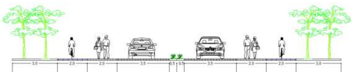
Εικόνα 5.1: Διατομή (Δ1) δρόμου 22 μέτρων
