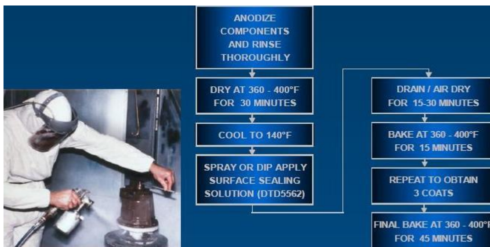
Διάγραμμα 7.5: Διαδικασία Surface sealing (DTD 935) για ανοδική προστασία
