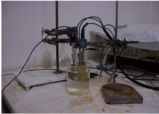
Εικόνα 9.4 : Διάταξη μεθόδου Tafel analysis
