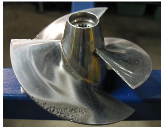
Σχήμα 1.4: Μηχανισμός δημιουργίας σπηλαιώσης Εικόνα1.7 : Σπηλαιώση σε προπέλα
