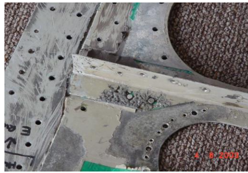
Εικόνα: Διάβρωση χαραγής σε πάνελ αεροσκάφους
