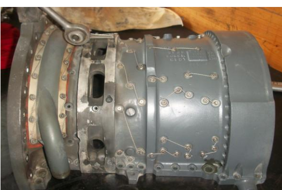
Εικόνα 4.19 : Διάβρωση εξωτερικής επικάλυψης
