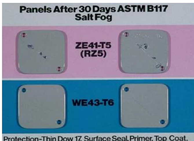
Εικόνα 6.32 : Σύγκριση κραμάτων ως προς τη διάβρωση.
