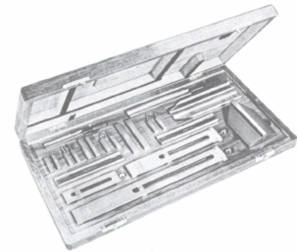
Σχ. 4-7: Συνήθεις χρησιμοποιούμενοι τύποι εξαρτημάτων πλακιδίων τοποθετημένοι σε σετ, που περιλαμβάνει ράμφη, χαράκτες, κεντρικά σημεία, βάσεις πλακιδίων και στηρίγματα διαφόρων μεγεθών.
