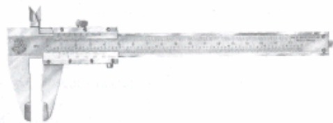
Σχ. 2-9: Διεθνή παχύμετρα με βερνιέρο με άκρα ραμφών όμοια με την κόψη του μαχαιριού για εσωτερικές μετρήσεις και βοηθητική ράβδο για μετρήσεις βάθους.
