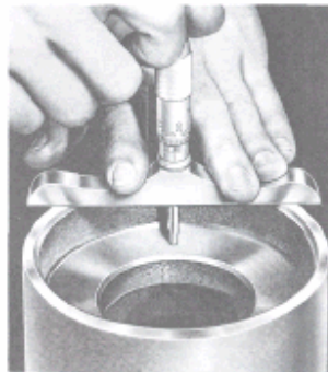
Σχ. 2-31: Μικρόμετρο βάθους για τη μέτρηση της απόστασης εξέχοντων επιφανειών από επίπεδη επιφάνεια Αναφοράς.
