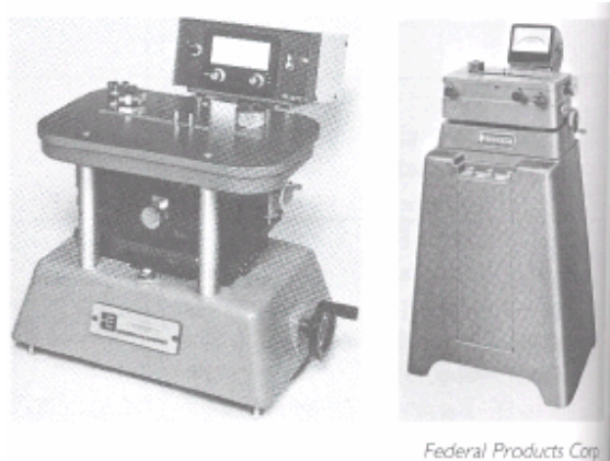
Σχ. 7-15: (Αριστερά) Ηλεκτρονικό συγκριτικό όργανο Σχ. 7-16: (Δεξιά) Ηλεκτρονικό συγκριτικό όργανο για εργαστηριακές εφαρμογές βαθμονόμησης με μεγεθύνσεις μεγαλύτερες από 60.000X. Η αρχική του χρήση είναι για εσωτερικές μετρήσεις, άλλα είναι συμβατό και με εξωτερικές.
