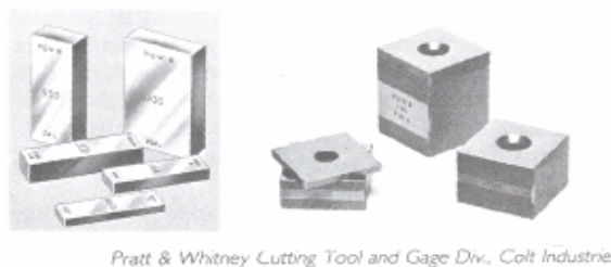
Σχ. 4-1: (Αριστερά) Ορθογώνια παραλληλεπίπεδα πλακίδια πρότυπου μήκους. Σχ. 4-2: (Δεξιά) Κυβικά πλακίδια πρότυπου μήκους με κεντρική οπή.
