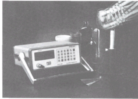
Σχ. 7-25: Ψηφιακό όργανο μέτρησης πάχους με τη βούθεια του φαινομένου Hall.
