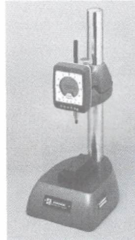
Σχ. 5-32: Συγκριτικό όργανο με τραπέζι εργασίας και ηλεκτρονικό ενδεικτικό όργανο.
