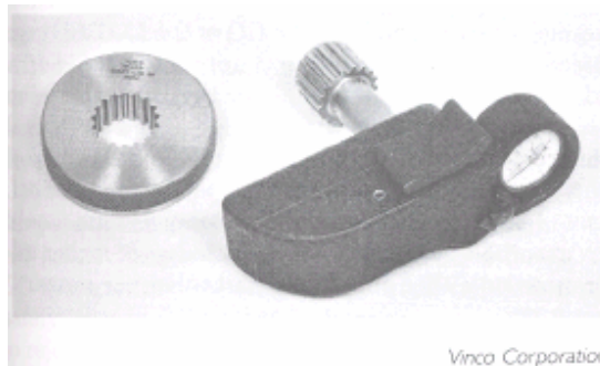
Σχ. 3-22: (Αριστερά) Σταθερός ελεγκτήρας τύπου δακτυλίου συγκεκριμένου ονομαστικού μεγέθους με αυλακώσεις. Τέτοιοι ελεγκτήρες μπορούν να χρησιμοποιηθούν για τον άμεσο έλεγχο κατασκευασμένων τεμαχίων, ως ελεγκτήρες ορίων. (Δεξιά) Ή μπορούν να λειτουργήσουν ως ρυθμιστικά πρότυπα ελεγκτήρων τρυμμάτων με ενδεικτικό όργανο, όπως αυτό του σχήματος.
