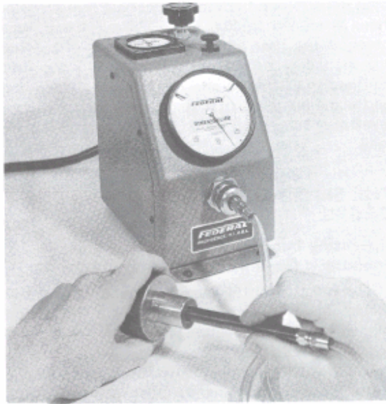
Σχ. 6-16: Μονάδα ελέγχου συνεπούς ενίσχυσης πνευματικού οργάνου. Η ανάγκη ενός μόνο ρυθμιστικού προτύπου φαίνεται από το μοναδικό ρυθμιστικό δακτύλιο που υπάρχει στην πλαϊνή πλευρά του οργάνου.
