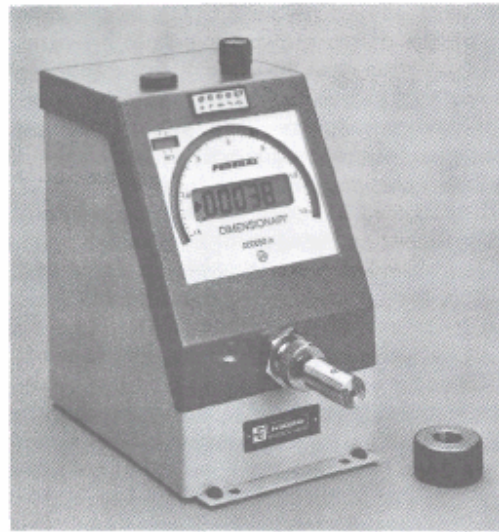
Σχ. 6-16: Ψηφιακή και αναλογική μονάδα ελέγχου πνευματικού οργάνου.
