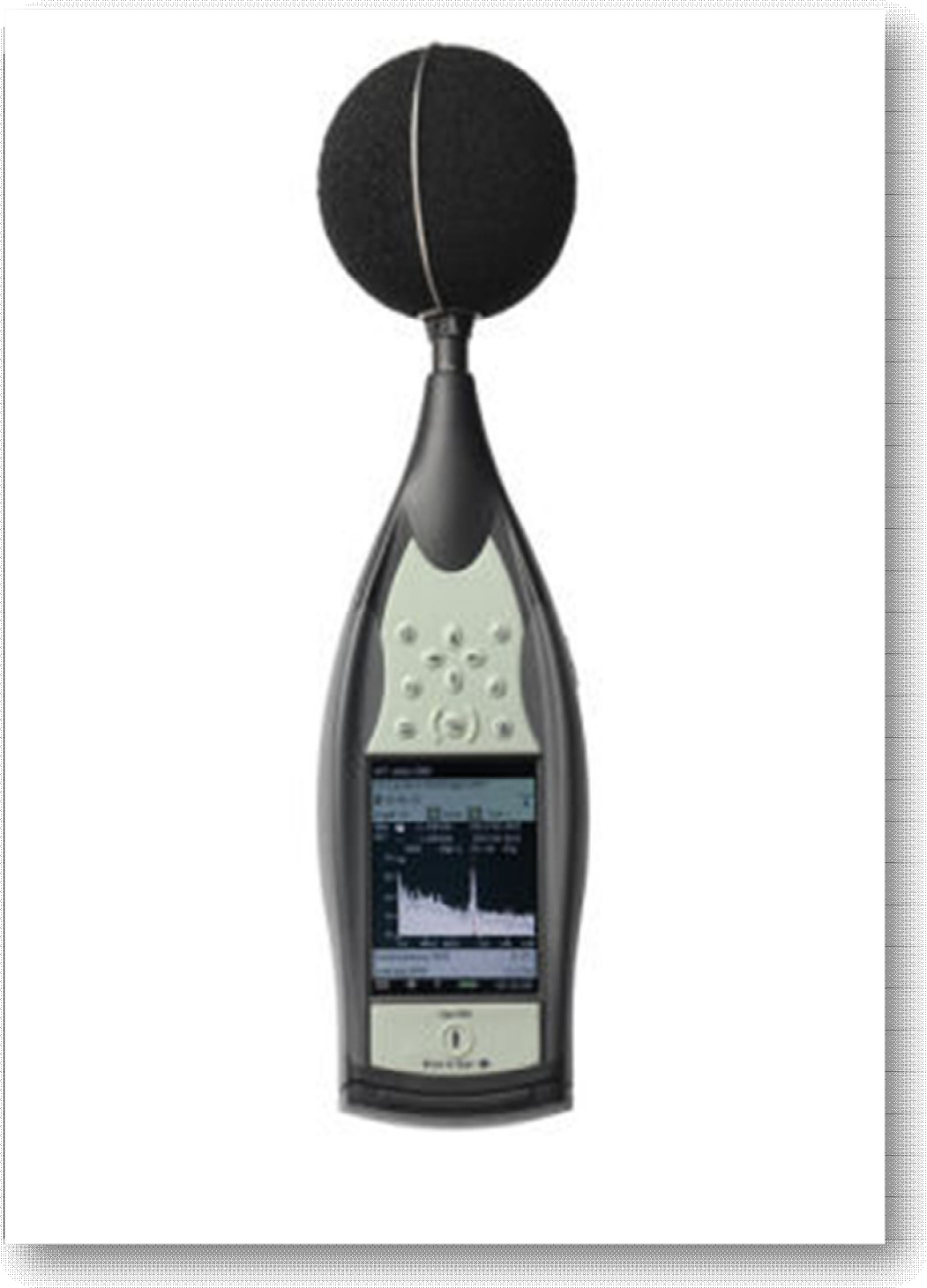
Εικόνα 4.2 : Ηχόμετρο της εταιρείας Brüel&Kjær, Type 2250
