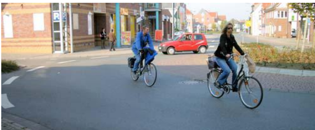
Σχήμα 2.45. Αν η Μ.Η.Κ. δεν ξεπερνά τα 15000 οχ./ημ. τα ποδήλατα εντάσσονται στην κυκλοφορία των μηχανοκίνητων οχημάτων (Brilon, 2011).
