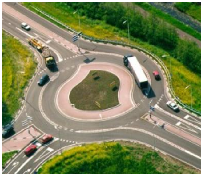
Σχήμα 2.63. Ολλανδία: Τετρασκελής (πάνω) και Τρισκελής (κάτω) Σπειροειδής Κόμβος με υπερυψωμένα διαχωριστικά λωρίδων (Fortuijn, 2011).
