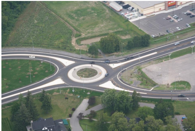
Σχήμα 2.25. Απλός Κυκλικός Κόμβος (μίας λωρίδας) (Brilon, 2011).
