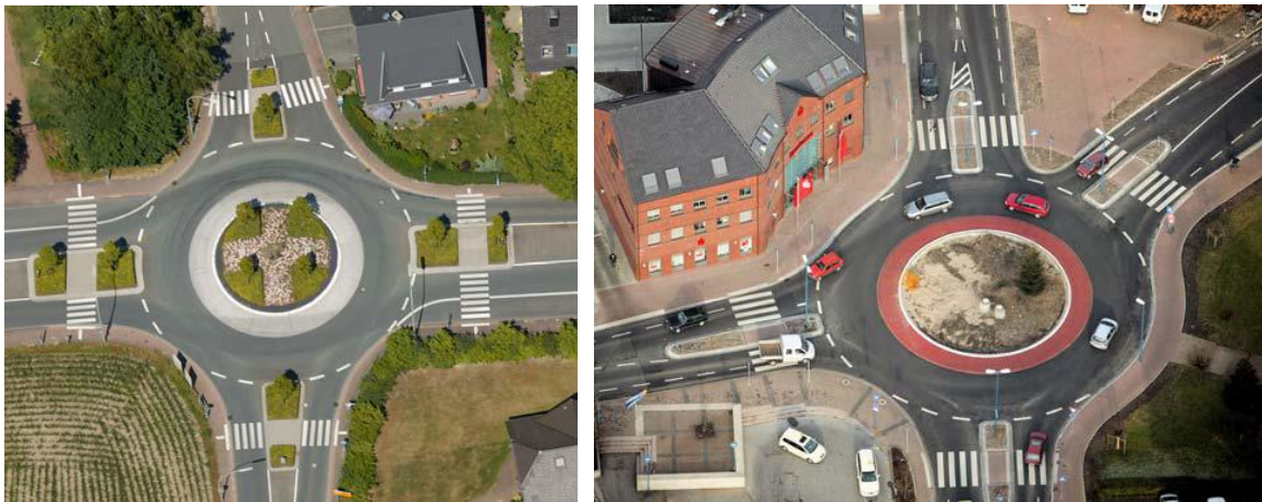
Σχήμα 2.41. Αστικοί Κυκλικοί Κόμβοι Μίας Λωρίδας (διαθέτουν κατάλληλα διαμορφωμένη περιμετρική ζώνη για φορτηγά) (Brilon, 2011).
