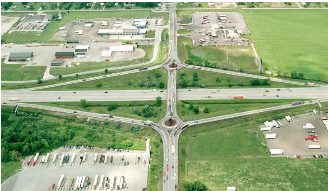
Σχήμα 2.24. Διπλός Κυκλικός Κόμβος μορφής «Αλτήρα» (dumbbell interchange) (NCHRP & FHWA, 2010).
