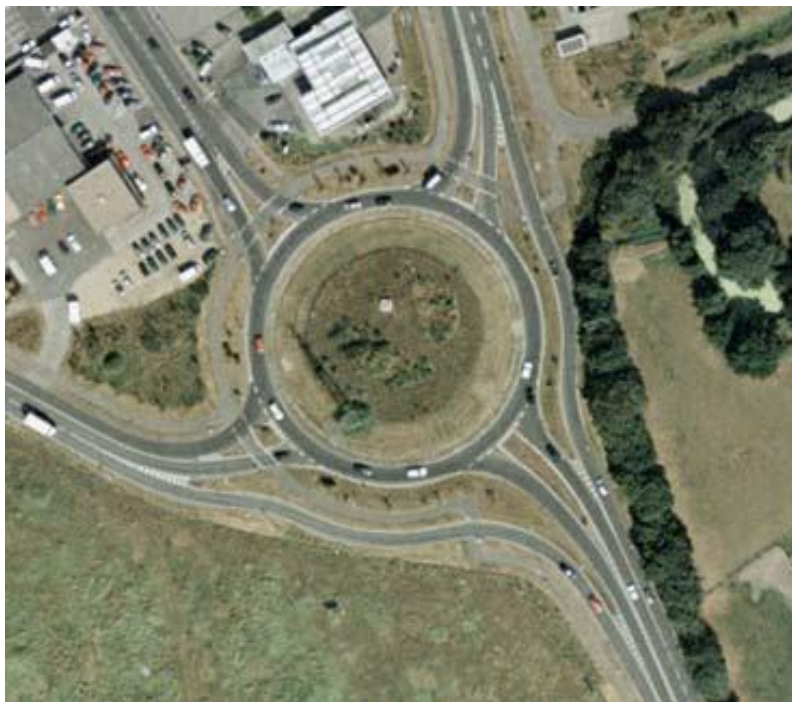
Σχήμα 2.48. Τετρασκελής υπεραστικός κυκλικός κόμβος μίας λωρίδας με δύο παρακαμπτήριες λωρίδες (Brilon, 2011).
