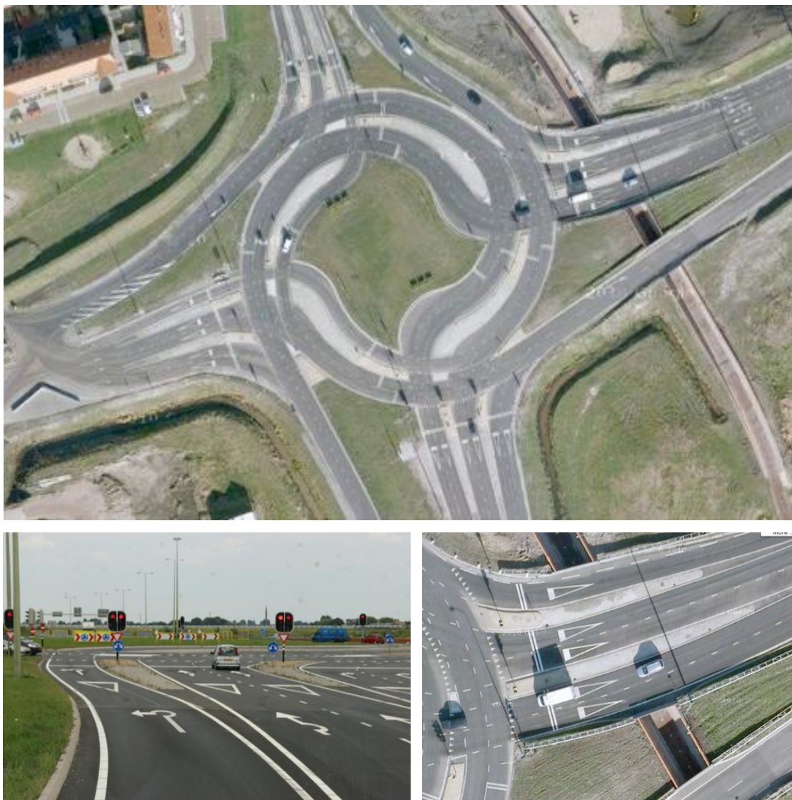
Σχήμα 2.65. Ολλανδία: Σηματοδοτημένος Τετρασκελής Σπειροειδής Κόμβος τύπου «Ρότορας». Πεζοί και Ποδηλάτες διέρχονται ανενόχλητοι από υπόγεια διάβαση (Fortuijn, 2011).
