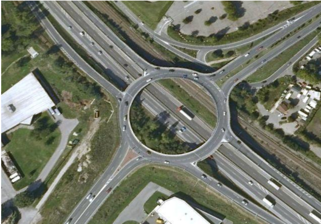
Σχήμα 2.22. Κυκλικός Κόμβος Δύο Επιπέδων (The Highways Agency et al., 2007).
