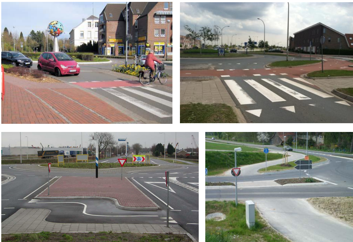
Σχήμα 2.47. Πάνω: Ποδηλατόδρομος σε συνδυασμό με διάβαση πεζών σε αστικό κόμβο. Κάτω: Ποδηλατόδρομος σε υπεραστικό κόμβο (Brilon, 2011).
