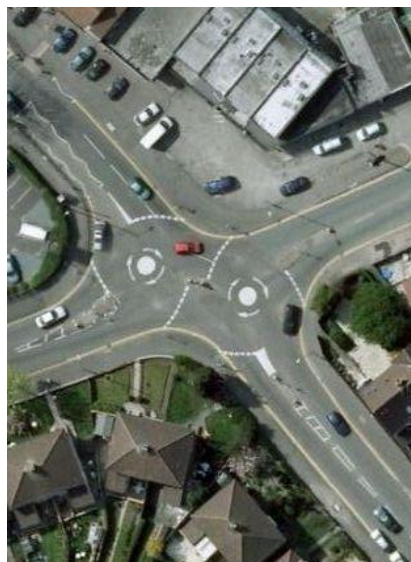
Σχήμα 2.25. Απλός Κυκλικός Κόμβος (μίας λωρίδας) (Brilon, 2011).
