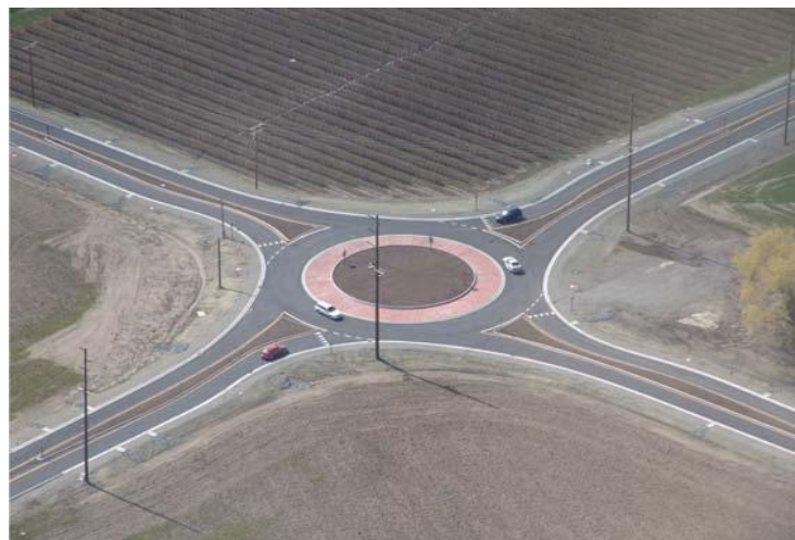
Σχήμα 2.28. Κυκλικός Κόμβος Μίας Λωρίδας (NCHRP & FHWA, 2010).
