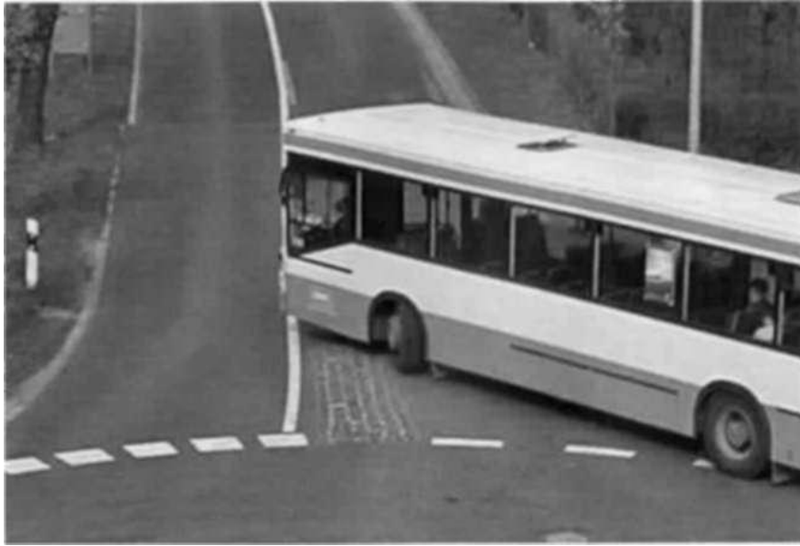
Σχήμα 3.69. Ελαφρώς υπερυψωμένη κατευθυντήρια νησίδα, προσπελάσιμη για τα βαρέα οχήματα (FGSV, 2006).
