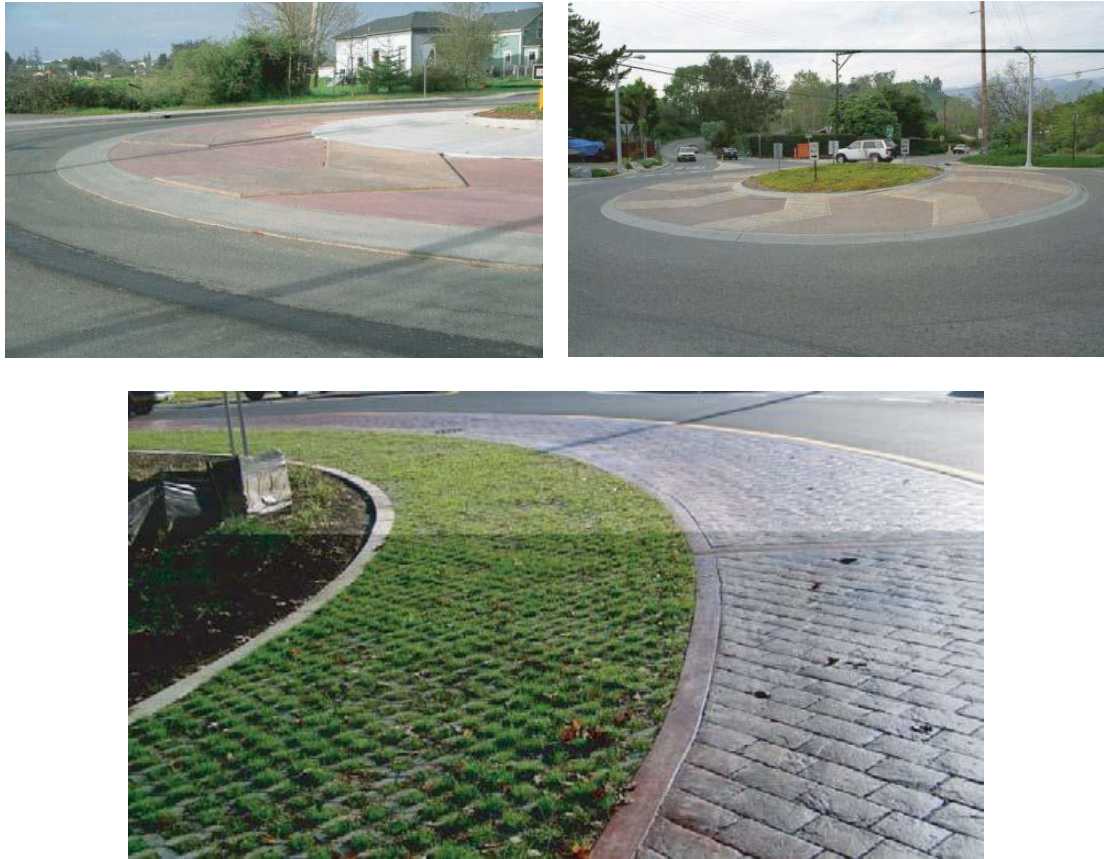
Σχήμα 3.13. Προσπελάσιμη περιμετρική ζώνη της κυκλικής κεντρικής νησίδας για βαρέα οχήματα (NCHRP & FHWA, 2010).
