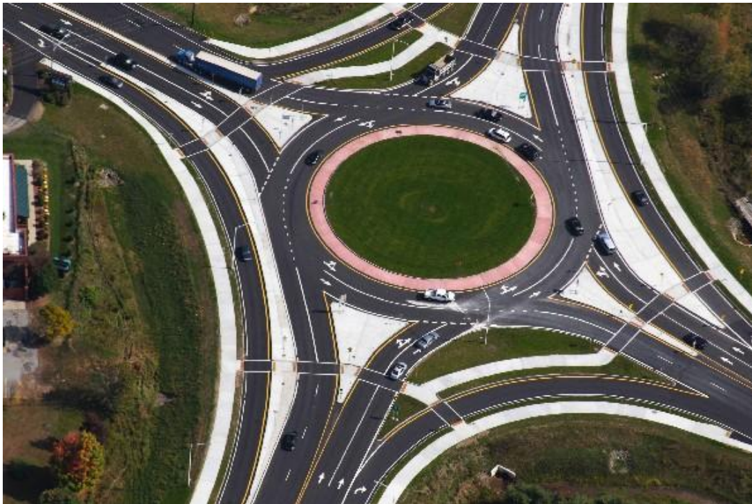
Σχήμα 2.20. Κυκλικός Κόμβος δύο λωρίδων με παρακαμπτήριες λωρίδες ( http://www.roundaboutsusa.com/ ).
