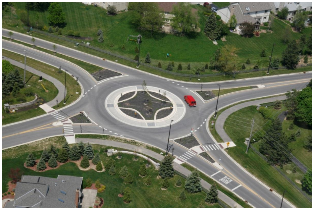
Σχήμα 2.19. Τυπικός κυκλικός κόμβος μιας λωρίδας (Brilon, 2011).
