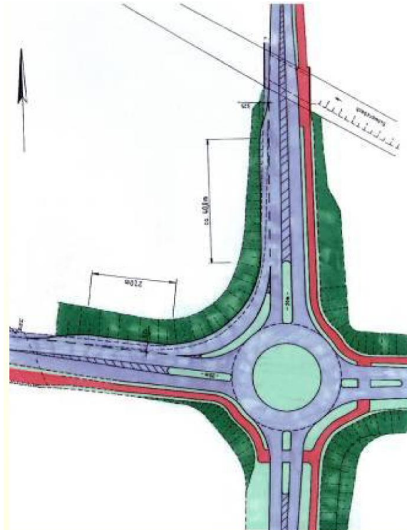
Σχήμα 3.68. Παρακαμπτήρια λωρίδα δεξιάς στροφής (από Βορρά προς Δύση) (Brilon et al., 2006).
