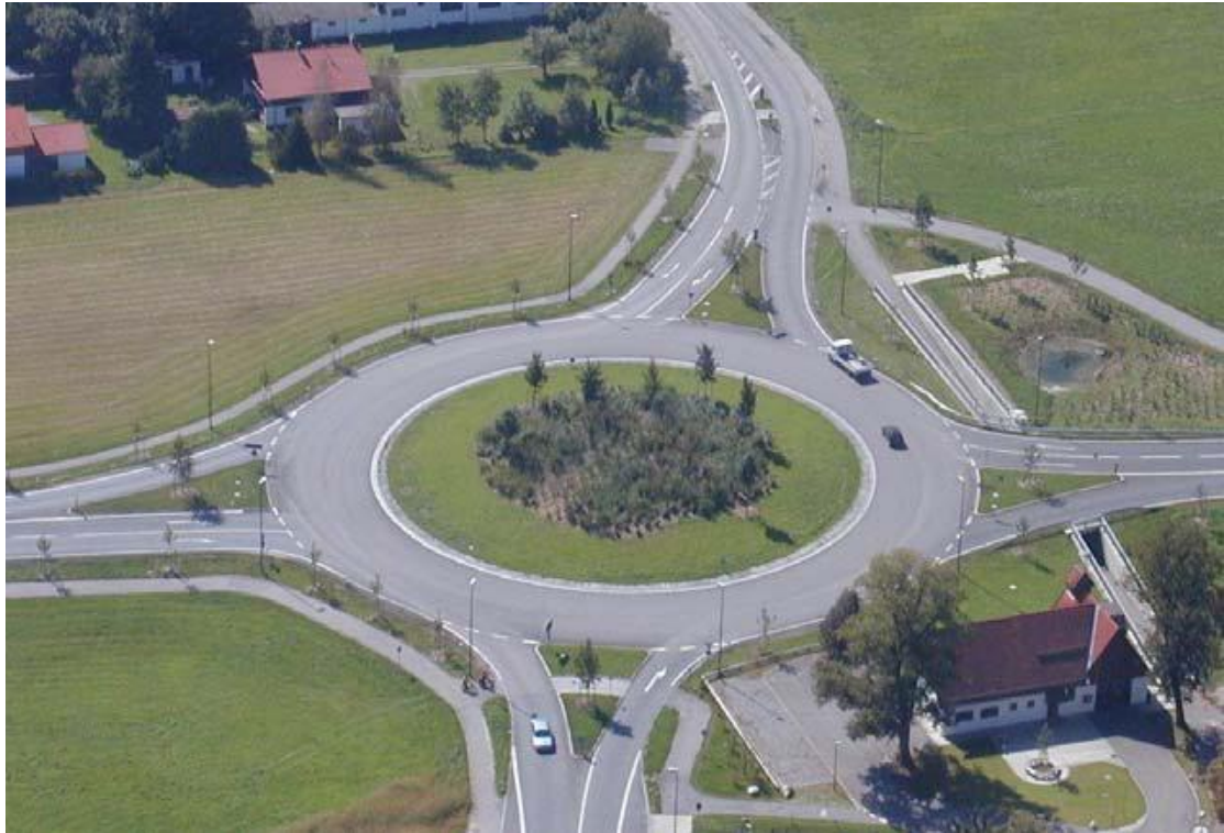
Σχήμα 3.63. Μικρός Κυκλικός Κόμβος Δύο Λωρίδων (Zweistreifig Befahrbarer Kreisverkehr) (Brilon et al., 2006).
