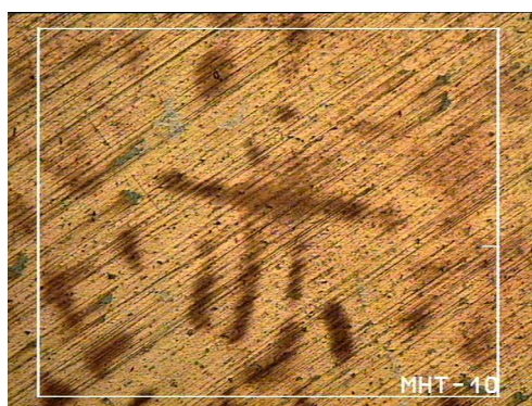
Σχήμα 4.5: Φωτογραφία οπτικού μικροσκοπίου ενός δενδρίτη που ανιχνεύτηκε στην επιφάνεια του δοκιμίου Α1
