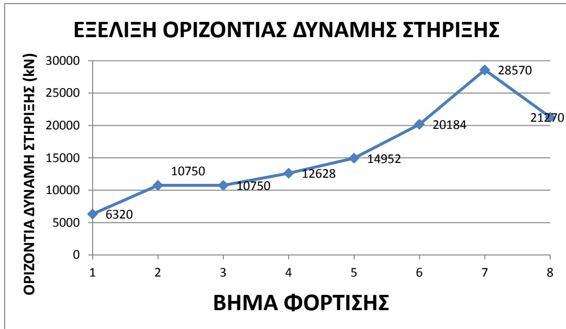
Σχήμα 4.53 Εξέλιξη οριζόντιας δύναμης στήριξης
