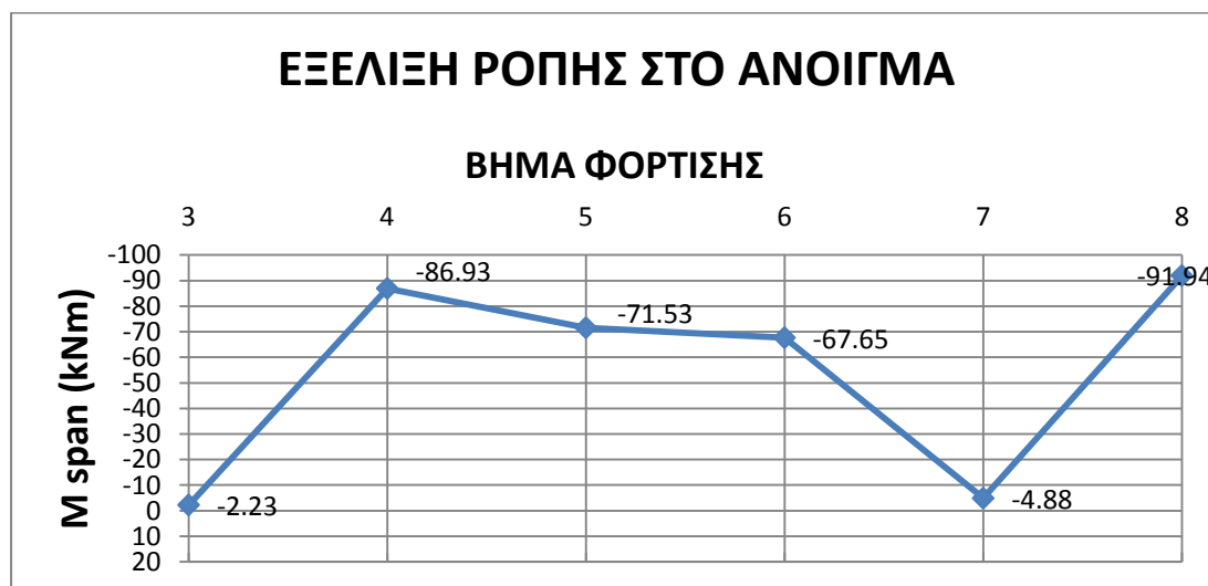
Σχήμα 4.51 Εξέλιξη ροπής μεσαίας διατομής στα βήματα της φόρτισης
