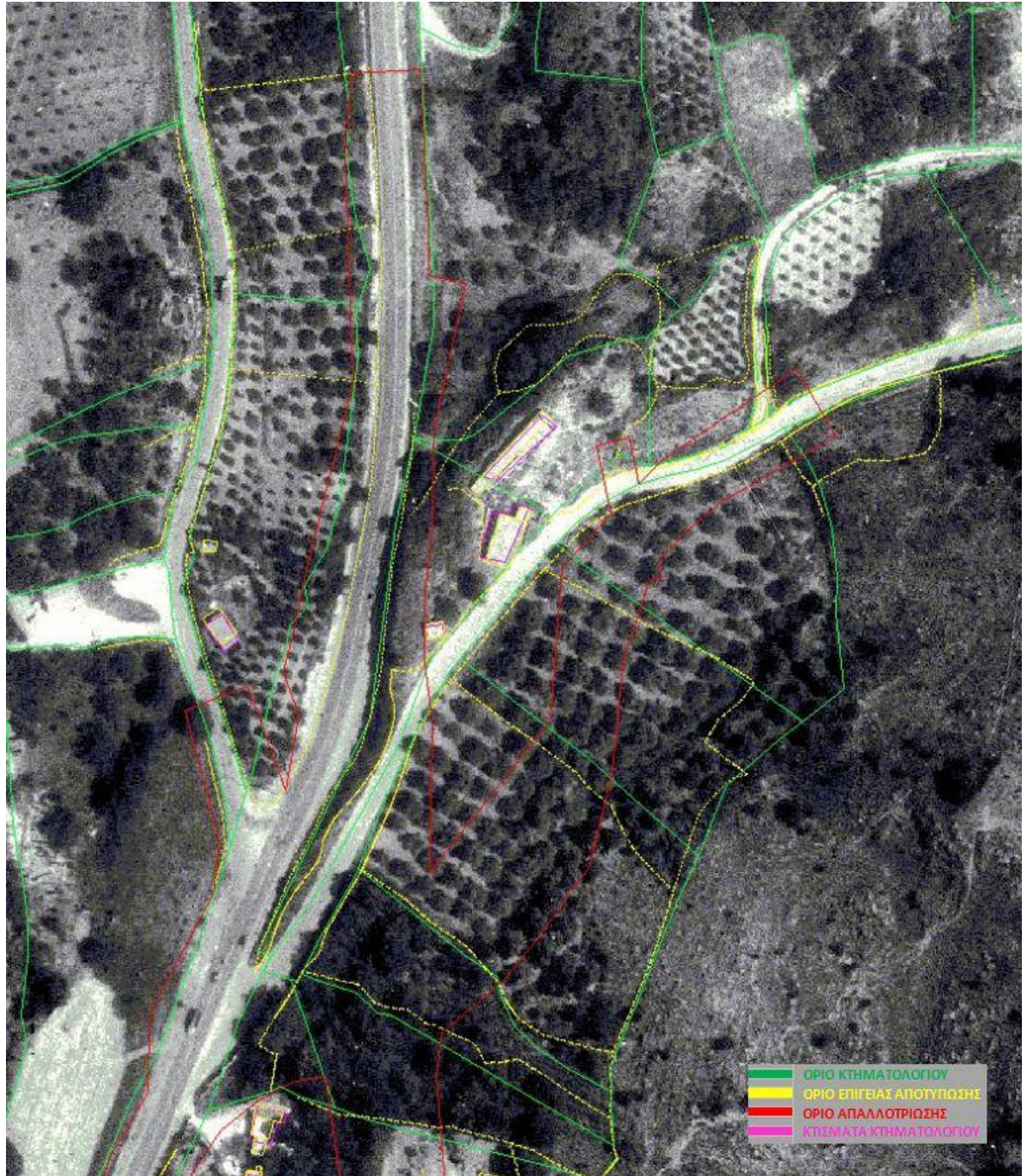
Εικόνα 3.8. Διαφορές μεταξύ των ορίων του Κτηματολογίου και της επίγειας αποτύπωσης του μελετητή της απαλλοτρίωσης
