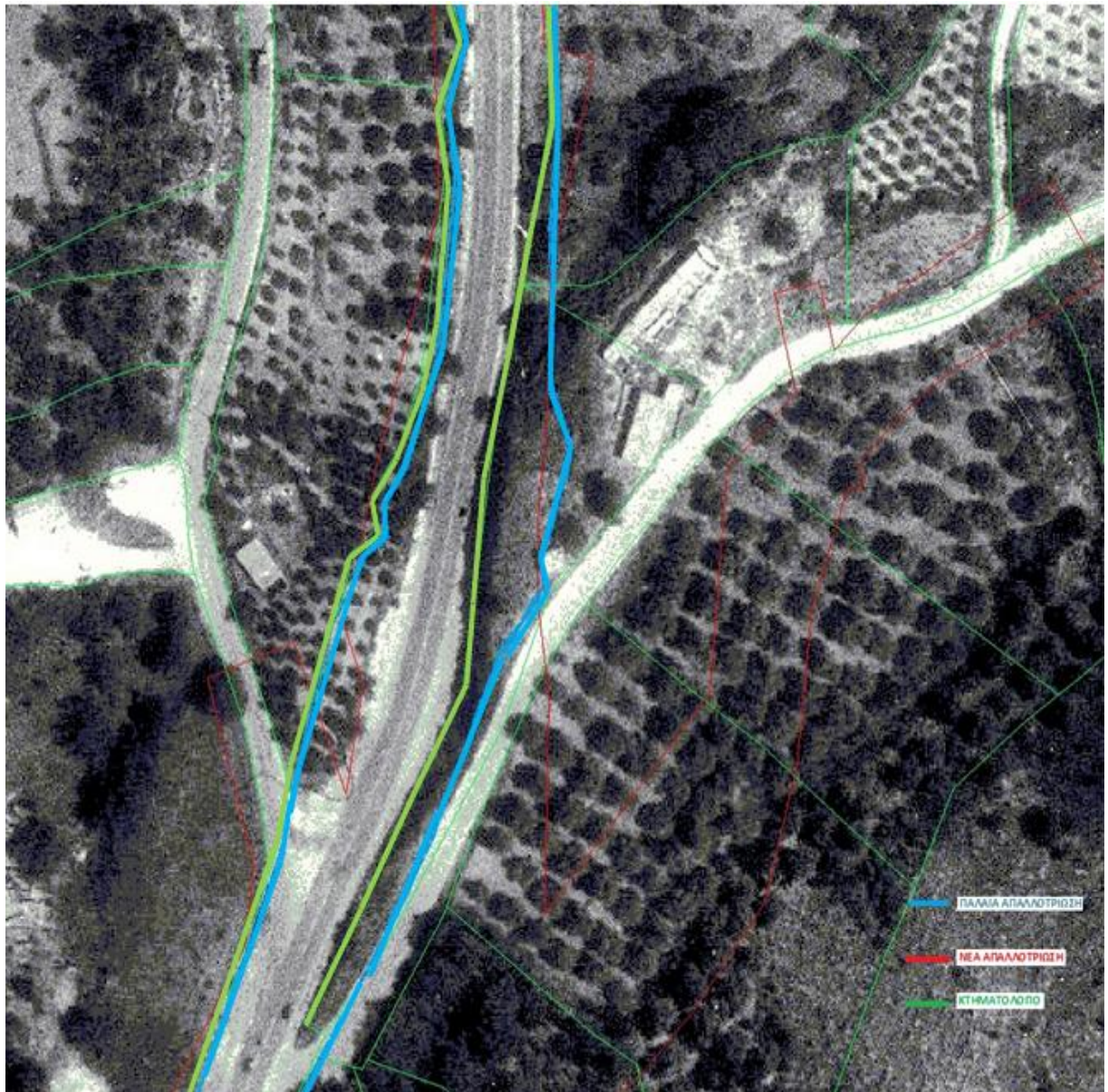
Εικόνα 3.9. Διαφορές της παλαιάς απαλλοτρίωσης σχετικά με την υλοποίηση της από το Κτηματολόγιο ( χρώμα πράσινο ) και της υλοποίησης της από τον μελετητή της απαλλοτρίωσης (χρώμα μπλέ).
