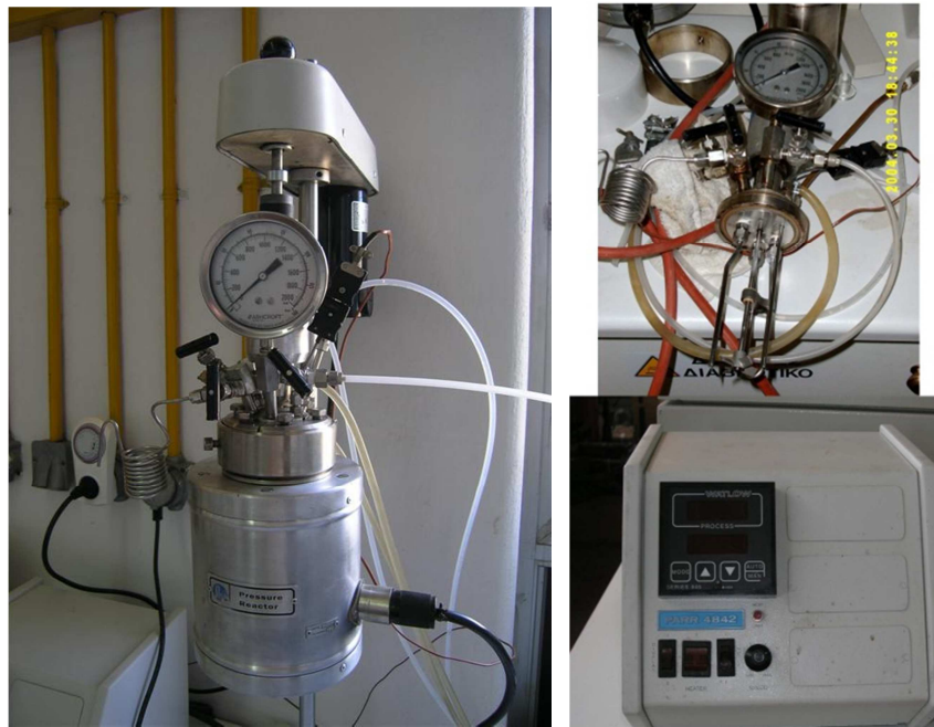
Εικόνα 2-2. Αντιδραστήρας πλήρους ανάμιξης
