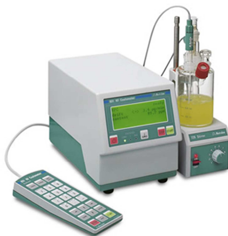
Εικόνα 3-3. Συσσκευή προσδιορισμού υγρασίας Karl-Fischer
