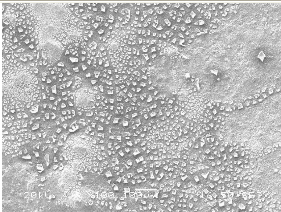
Εικόνα SEM 6.16: Επικάλυψη με προπανόλη και 0,2 gr Peg για ανάδευση 2h και έψηση στους 1100°C.
