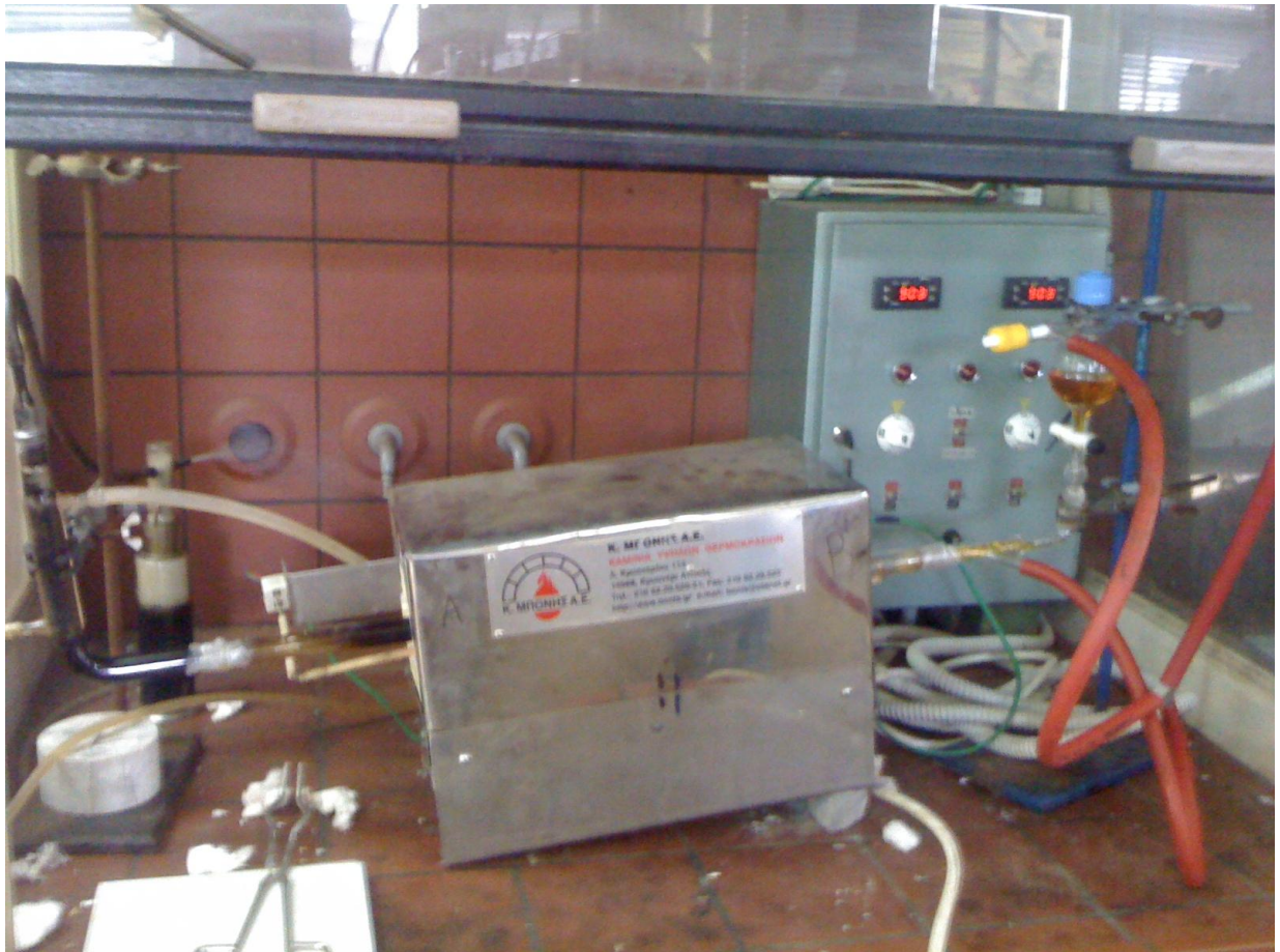
Εικόνα 6: Απεικόνιση πειραματικής διάταξης για την παραγωγή νανοσωλήνων άνθρακα με την τεχνική της πυρόλυσης μέσω ψεκασμού διαλύματος.
