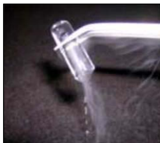
Εικόνα 1-1: Στη φωτογραφία φαίνεται ένα μικρό κομμάτι στερεοποιημένο Αργό (σημείο τήξης: -189.352 °C σημείο βρασμού: -185.9 °C) που λόγω θερμοκρασίας περιβάλλοντος περνά γρήγορα από τη μία φάση στην άλλη. ,ιακρίνονται καθαρά οι τρεις φάσεις της ουσίας.
