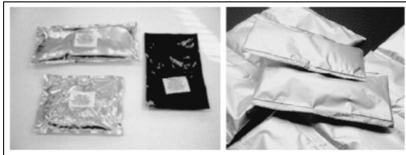
Εικόνα 2-5: Macro encapsulation σε σάκους (αριστερά από την Climator/Σουηδία και δεξιά από την Dorken/Γερμανία) [18]
