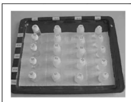
Εικόνα 2-3: Τεστ συμβατότητας για συνδυασμούς πλαστικών-ανόργανων ΥΑΦ και πλαστικών-οργανικών ΥΑΦ [18].
