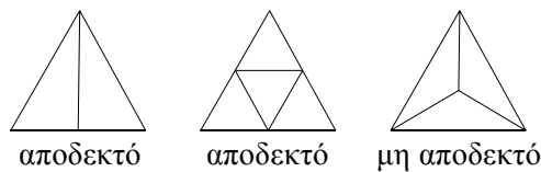
Εικόνα 2.5 : Τρόποι διάσπασης τριγώνων και μη αποδεκτός τρόπος διάσπασης
