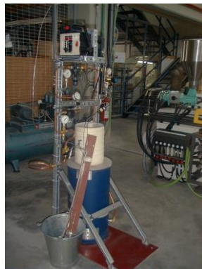
Σχήμα 5.9: Η διάταξη μεταπολυμερισμού στερεάς κατάστασης (Ημιβιομηχανικό Εργαστήριο της Σχολής Χημικών Μηχανικών)
