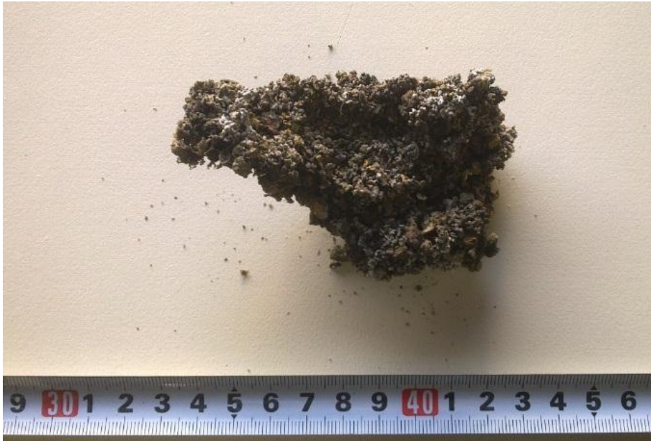
Εικόνα 4. 1 Συσσωμάτωμα τέφρας, αδρανούς υλικού και κουσίμου
