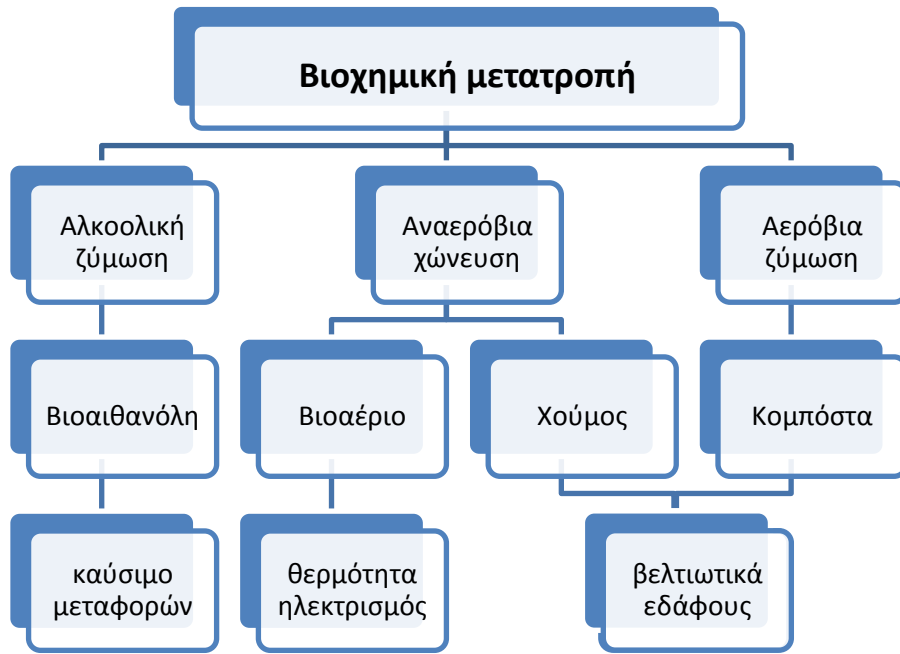
Σχήμα 1. 5 Βιοχημικές διεργασίες μετατροπής της βιομάζας σε βιοκαύσιμα
