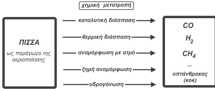
Σχήμα 1. 12 Απλοποιημένο διάγραμμα καταλυτικών δυνατοτήτων επεξεργασίας - απομάκρυνσης των πισσών από το παραγόμενο αέριο σύνθεσης [39]
