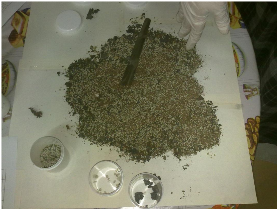
Εικόνα 4. 2 Δείγμα υλικού από τον ανοδικό σωλήνα μετά την απορρευστοποίηση
