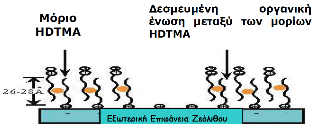
Εικόνα 4.2.3.: Μηχανισμός σχηματισμού διμοριακής στοιβάδας HDTMA + στην επιφάνεια του ζεόλιθου [8]
