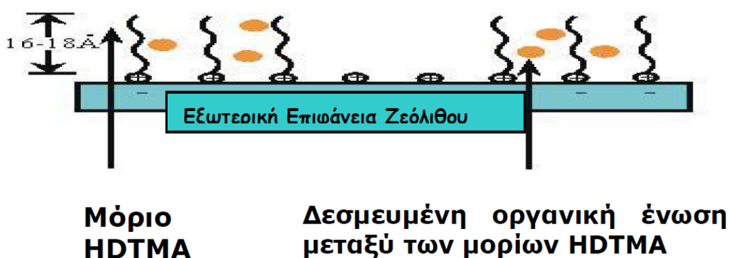
Εικόνα 4.2.2: Μηχανισμός σχηματισμού μονομοριακού στρώματος HDTMA + στην επιφάνεια του ζεόλιθου [8]
