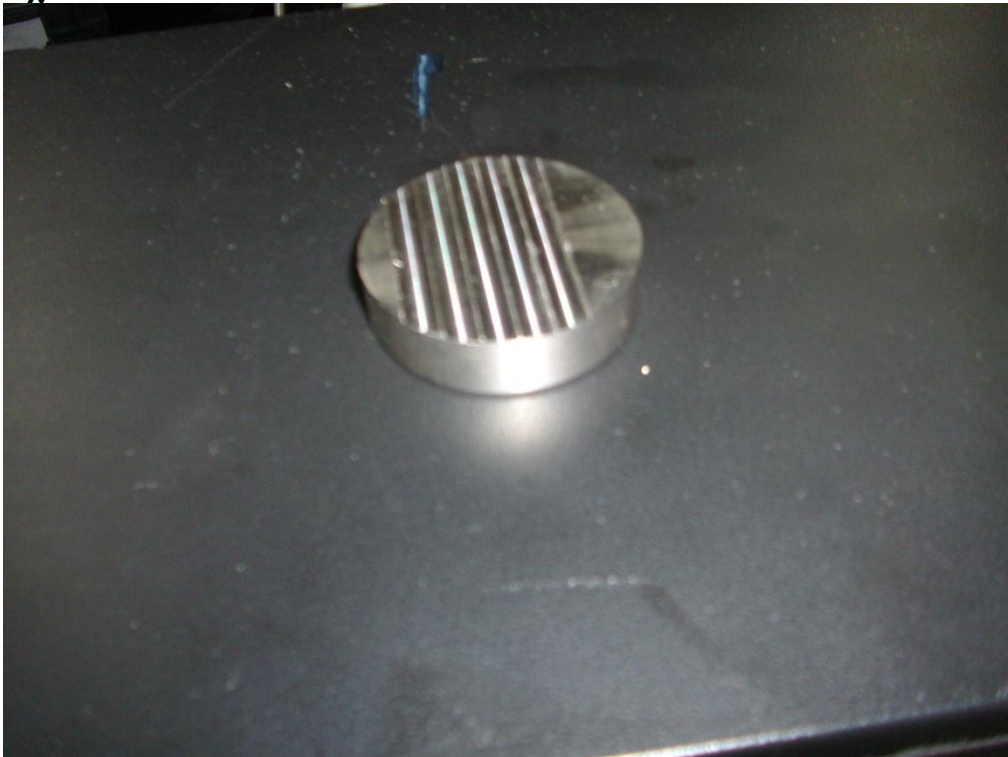
ΣΧΗΜΑ 8.2 Το τεμάχιο μετά τις κοπές μετωπικού φρεζαρίσματος
