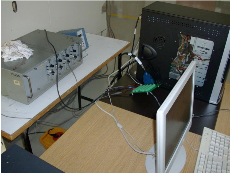
ΣΧΗΜΑ 4.3 Σύνδεση των δύο ενισχυτών με την μετρητική κάρτα και με τον Η/Υ
