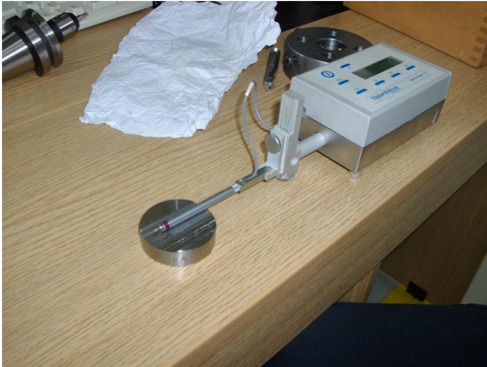
ΣΧΗΜΑ 4.6 Το τραχύμετρο που χρησιμοποιήθηκε κατά την διάρκεια των πειραμάτων
