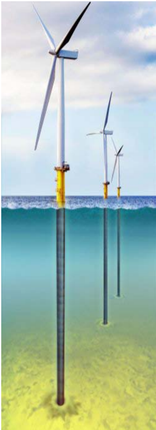
Εικόνα 3.2 : αριστερά: γενική άποψη ανεμογεννήτριας με υποστήριξη τύπου μονοπασσάλου και κάτω : λεπτομέρειες μονοπασσάλου
