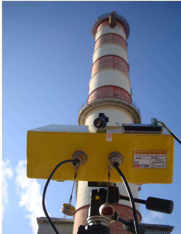
Σχήμα 4.4: Παρατήρηση της καπνοδόχου από το σύστημα IBIS-S Figure 4.4: Observation of the stack from the IBIS-S system
