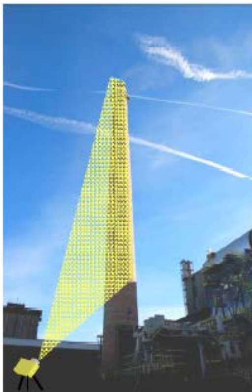
Σχήμα A3.2: Η περιοχή παρατήρησης της καπνοδόχου από το σύστημα IBIS-S Figure A3.2: The area of observation of the stack by the IBIS-S system (πηγή: Ingegneria Dei Sistemi, 2008)
