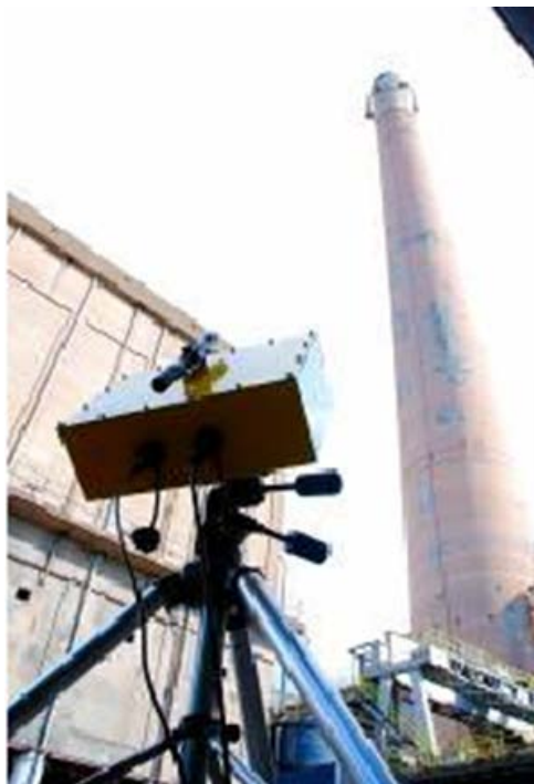
Σχήμα A3.1: Η παρακολούθηση της καπνοδόχου από το σύστημα IBIS-S Figure A3.1: Monitoring of the stack by IBIS-S system (πηγή: Ingegneria Dei Sistemi, 2008)
