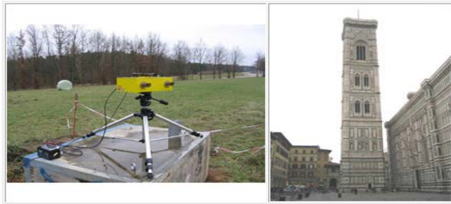
Σχήμα 2.2: Απεικόνιση IBIS-S και η χρήση του στην παρακολούθηση κατασκευών Figure 2.2: View of IBIS-S and its use in structural monitoring (Πηγή: www.idscopy.com )
