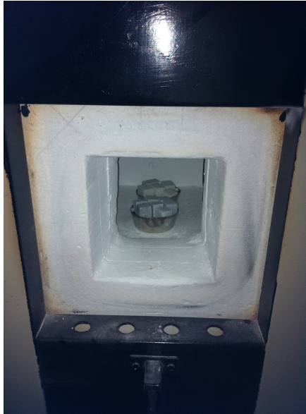
Εικόνα 31: Εισαγωγή των δειγμάτων στο φούρνο (χωνευτήριο πλατίνας με ανθρακικό πέτρωμα).
