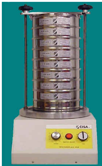
Εικόνα 15 : Συσκευή κοσκίνησης (μοντέλο RP08) [39, 60].
