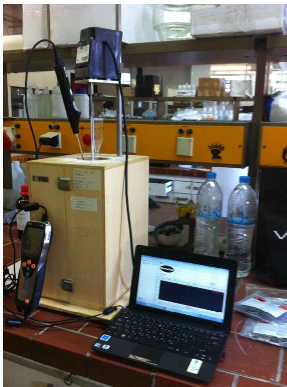
Εικόνα 34 : Πειραματική διάταξη μέτρησης δραστηριότητας ασβέστη (κατά την διάρκεια της αντίδρασης \text{CaO} + \text{H}_2\text{O} ).
