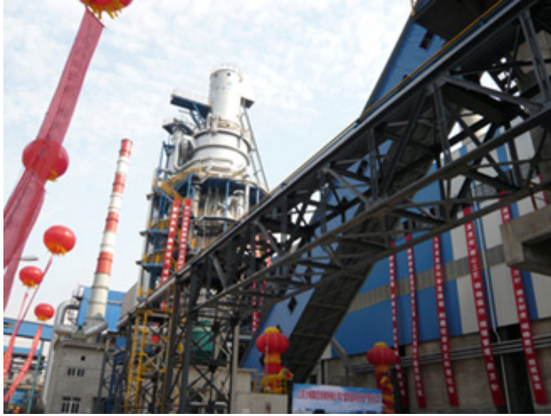
Εικόνα 7: Κατακόρυφο ασβεστοουργικό καμίνι συνεχούς λειτουργίας.
