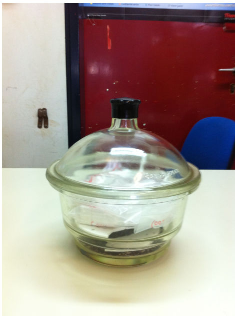
Εικόνα 32: Διατήρηση των ασβεστοποιημένων δοκιμίων σε ξηραντήρα
