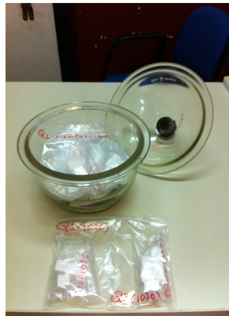
Εικόνα 32: Διατήρηση των ασβεστοποιημένων δοκιμίων σε ξηραντήρα
