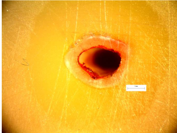
Εικόνα 236: Φωτογραφία από στερεοσκόπιο της διατομής στο σημείο αστοχίας δοκιμίου LF43.
