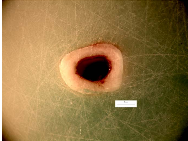
Εικόνα 146: Φωτογραφία από στερεοσκόπιο της διατομής στο σημείο αστοχίας δοκιμίου LF26. Στο επάνω μέρος της διατομής διακρίνεται το σημείο φόρτισης στα 10N.
