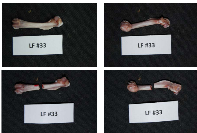
Εικόνα 179: Πρόσθια και οπίσθια όψη του δοκιμίου LF33 πριν και μετά το πείραμα κάμψης
