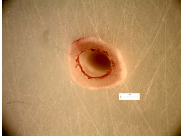
Εικόνα 159: Φωτογραφία από στερεοσκόπιο της διατομής στο σημείο αστοχίας δοκιμίου RF28. Είναι εμφανές το σημείο φόρτισης στα 10N.
