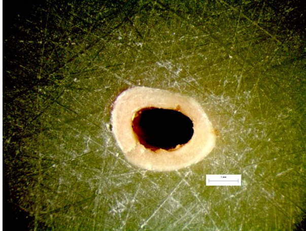
Εικόνα 202: Φωτογραφία από στερεοσκόπιο της διατομής στο σημείο αστοχίας δοκιμίου LF37
