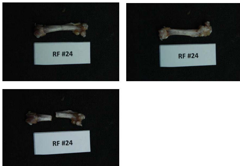
Εικόνα 136: Πρόσθια και οπίσθια όψη του δοκιμίου RF24 πριν και μετά το πείραμα κάμψης
