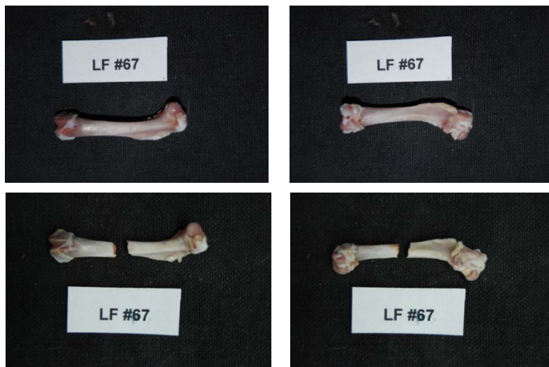
Εικόνα 311: Πρόσθια και οπίσθια όψη του δοκιμίου LF67 πριν και μετά το πείραμα κάμψης
