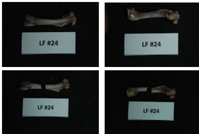
Εικόνα 133: Πρόσθια και σπίσθια όψη του δοκιμίου LF24 πριν και μετά το πείραμα κάμψης
