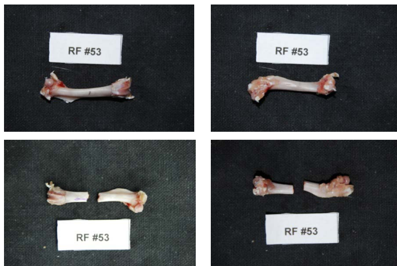
Εικόνα 282: Πρόσθια και οπίσθια όψη του δοκιμίου RF53 πριν και μετά το πείραμα κάμψης
