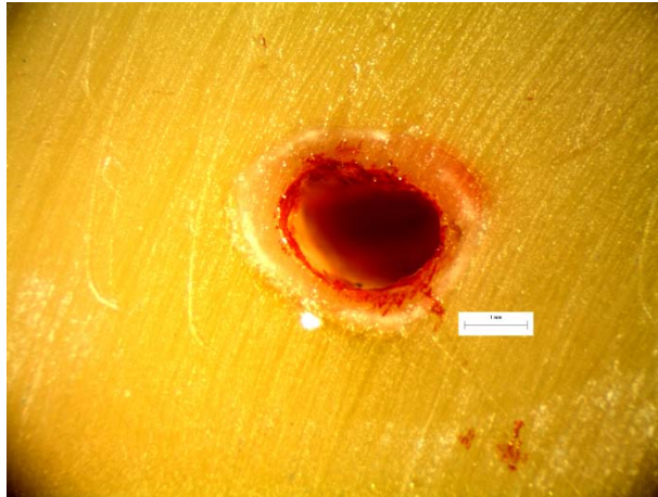
Εικόνα 180: Φωτογραφία από στερεοσκόπιο της διατομής στο σημείο αστοχίας δοκιμίου LF33. Στο δεξιά επάνω μέρος της διατομής διακρίνεται το σημείο φόρτισης στα 10N.
