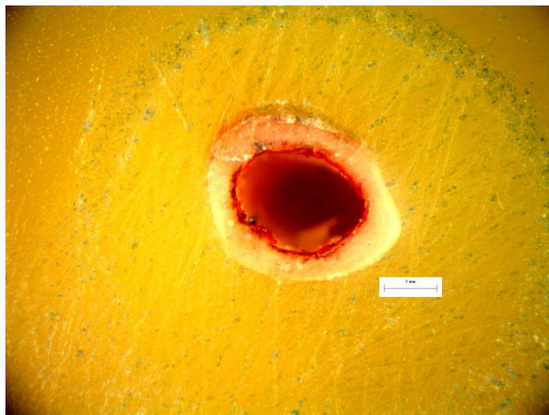
Εικόνα 183: Φωτογραφία από στερεοσκόπιο της διατομής στο σημείο αστοχίας δοκιμίου RF33. Στο επάνω μέρος της διατομής διακρίνεται το σημείο φόρτισης στα 10N.
