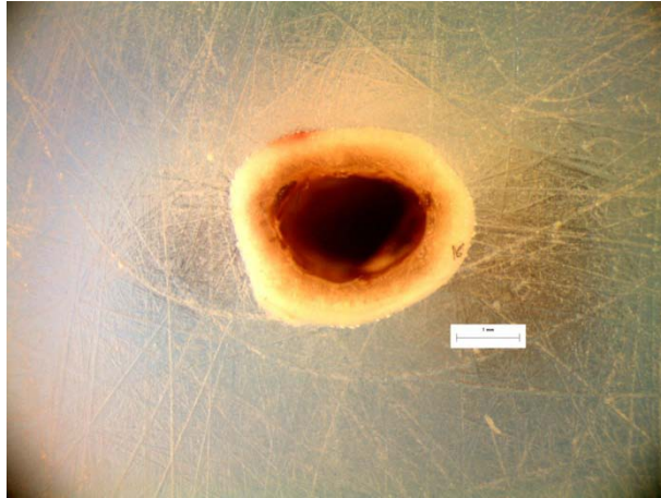
Εικόνα 313: Φωτογραφία από στερεοσκόπιο της διατομής στο σημείο αστοχίας δοκιμίου RF67. Στο επάνω μέρος της διατομής διακρίνεται το σημείο φόρτισης στα 10N.
