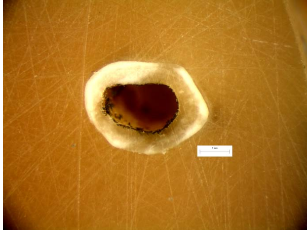
Εικόνα 192: Φωτογραφία από στερεοσκόπιο της διατομής στο σημείο αστοχίας δοκιμίου LF35.
