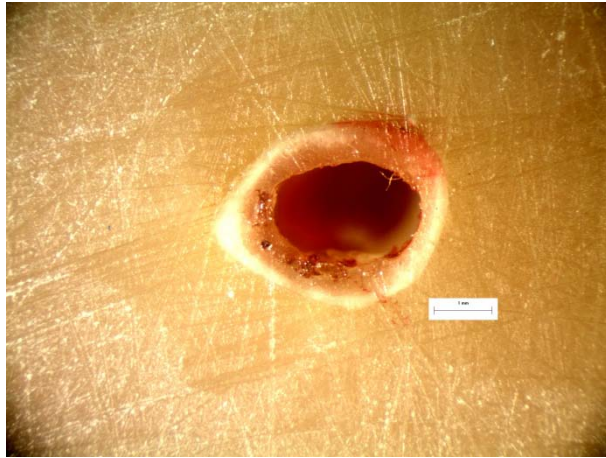
Εικόνα 95: Φωτογραφία από στερεοσκόπιο της διατομής στο σημείο αστοχίας δοκιμίου RF17. Είναι εμφανές το σημείο φόρτισης στα 10N.
