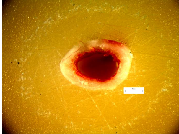
Εικόνα 189: Φωτογραφία από στερεοσκόπιο της διατομής στο σημείο αστοχίας δοκιμίου RF34. Είναι εμφανές το σημείο φόρτισης στα 10N.
