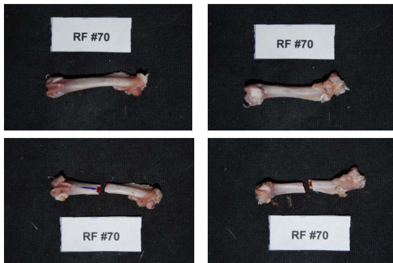
Εικόνα 319: Πρόσθια και οπίσθια όψη του δοκιμίου RF70 πριν και μετά το πείραμα κάμψης
