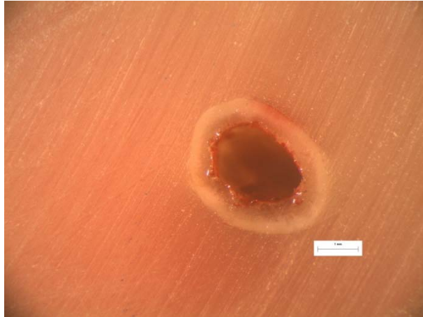
Εικόνα 78 : Φωτογραφία από στερεοσκόπιο της διατομής κοντά στο σημείο αστοχίας του δοκιμίου RF14. Στο επάνω μέρος της διατομής διακρίνεται το σημείο φόρτισης στα 10N.
