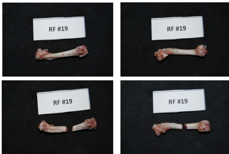
Εικόνα 106: Πρόσθια και οπίσθια όψη του δοκιμίου RF19 πριν και μετά το πείραμα κάμψης
