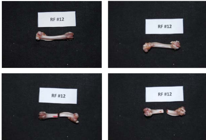
Εικόνα 65 : Πρόσθια και οπίσθια όψη του δοκιμίου RF12 πριν και μετά το πείραμα κάμψης
