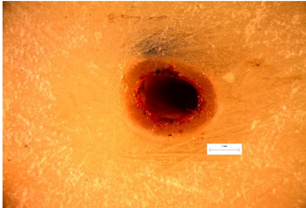
Εικόνα 27: Φωτογραφία από στερεοσκόπιο της διατομής στο σημείο αστοχίας δοκιμίου RF5. Στο επάνω μέρος της διατομής διακρίνεται το σημείο φόρτισης στα 10N.
