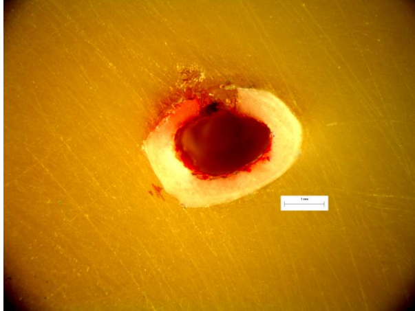
Εικόνα 186: Φωτογραφία από στερεοσκόπιο της διατομής στο σημείο αστοχίας δοκιμίου LF34. Είναι εμφανές το σημείο φόρτισης στα 10N.
