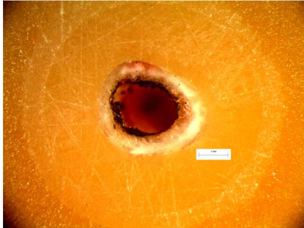
Εικόνα 171: Φωτογραφία από στερεοσκόπιο της διατομής στο σημείο αστοχίας δοκιμίου RF31. Στο επάνω μέρος της διατομής διακρίνεται το σημείο φόρτισης στα 10N.
