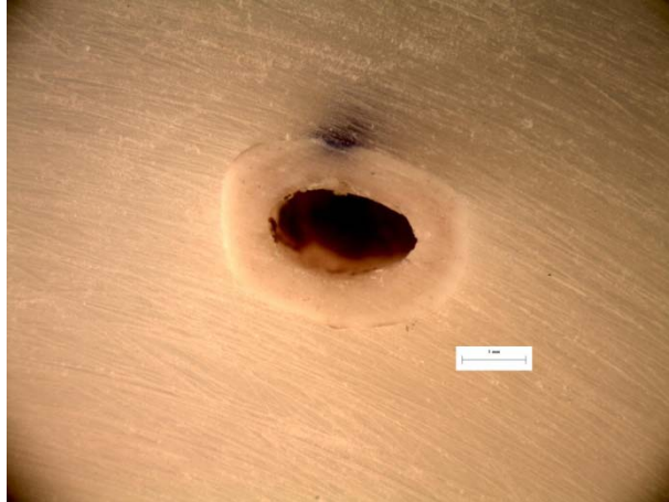
Εικόνα 289: Φωτογραφία από στερεοσκόπιο της διατομής στο σημείο αστοχίας δοκιμίου RF54. Είναι εμφανές το σημείο φόρτισης στα 10N.
