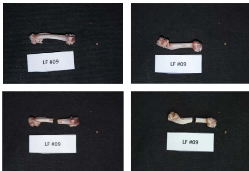
Εικόνα 46: Πρόσθια και οπίσθια όψη του δοκιμίου LF9 πριν και μετά το πείραμα κάμψης
