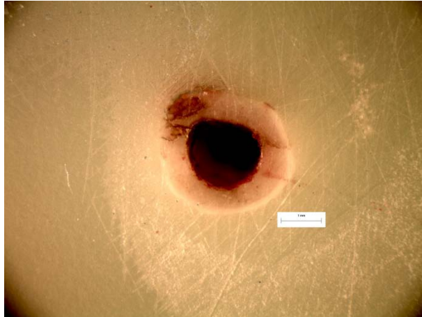
Εικόνα 149: Φωτογραφία από στερεοσκόπιο της διατομής στο σημείο αστοχίας δοκιμίου RF26. Είναι εμφανές το σημείο φόρτισης στα 10N.
