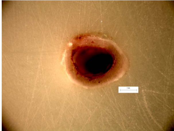
Εικόνα 143: Φωτογραφία από στερεοσκόπιο της διατομής στο σημείο αστοχίας δοκιμίου RF25. Είναι εμφανές το σημείο φόρτισης στα 10N.
