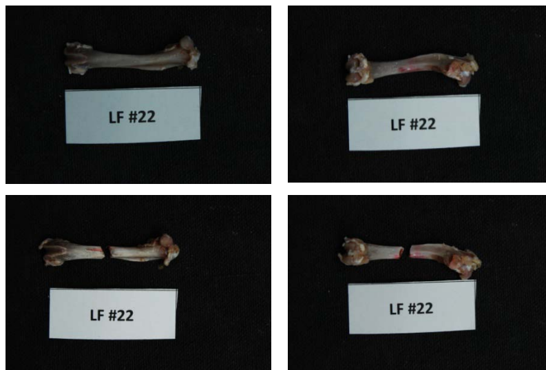
Εικόνα 121: Πρόσθια και οπίσθια όψη του δοκιμίου LF22 πριν και μετά το πείραμα κάμψης
