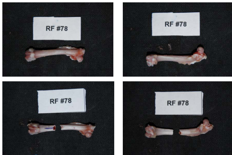
Εικόνα 343: Πρόσθια και οπίσθια όψη του δοκιμίου RF78 πριν και μετά το πείραμα κάμψης
