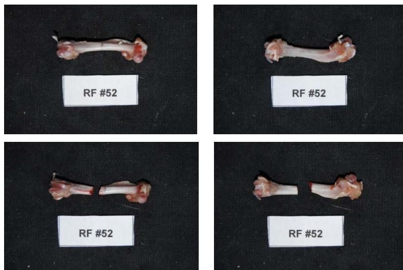
Εικόνα 276: Πρόσθια και οπίσθια όψη του δοκιμίου RF52 πριν και μετά το πείραμα κάμψης
