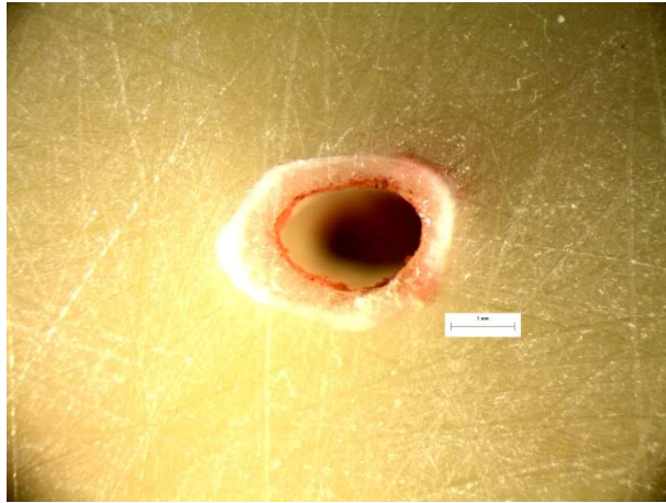
Εικόνα 110: Φωτογραφία από στερεοσκόπιο της διατομής στο σημείο αστοχίας δοκιμίου LF20. Στο επάνω μέρος της διατομής διακρίνεται το σημείο φόρτισης στα 10N.
