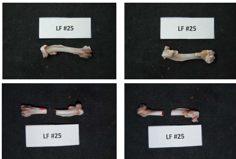
Εικόνα 139: Πρόσθια και οπίσθια όψη του δοκιμίου LF25 πριν και μετά το πείραμα κάμψης
