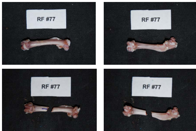
Εικόνα 341: Πρόσθια και οπίσθια όψη του δοκιμίου RF77 πριν και μετά το πείραμα κάμψης
