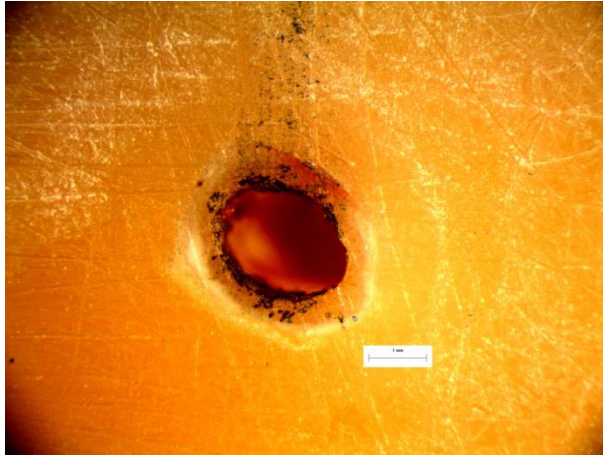
Εικόνα 125: Φωτογραφία από στερεοσκόπιο της διατομής στο σημείο αστοχίας του δοκιμίου RF22. Στο επάνω μέρος της διατομής διακρίνεται το σημείο φόρτισης στα 10N.
