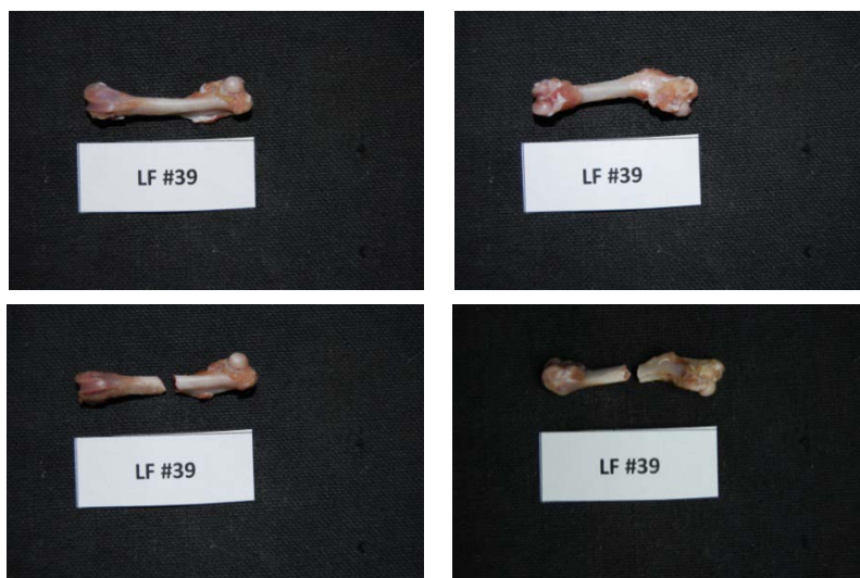
Εικόνα 213: Πρόσθια και οπίσθια όψη του δοκιμίου LF39 πριν και μετά το πείραμα κάμψης
