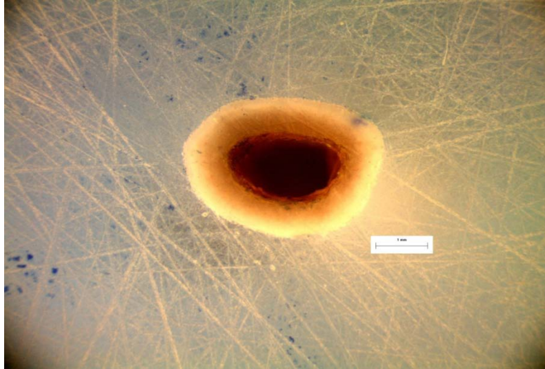
Εικόνα 3.4.2.3: Φωτογραφία δοκιμίου εγκιβωτισμένου σε ρητίνη μετά από τη λείανση.
