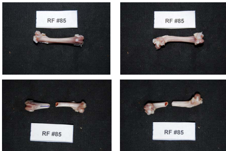
Εικόνα 369: Πρόσθια και οπίσθια όψη του δοκιμίου RF85 πριν και μετά το πείραμα κάμψης
