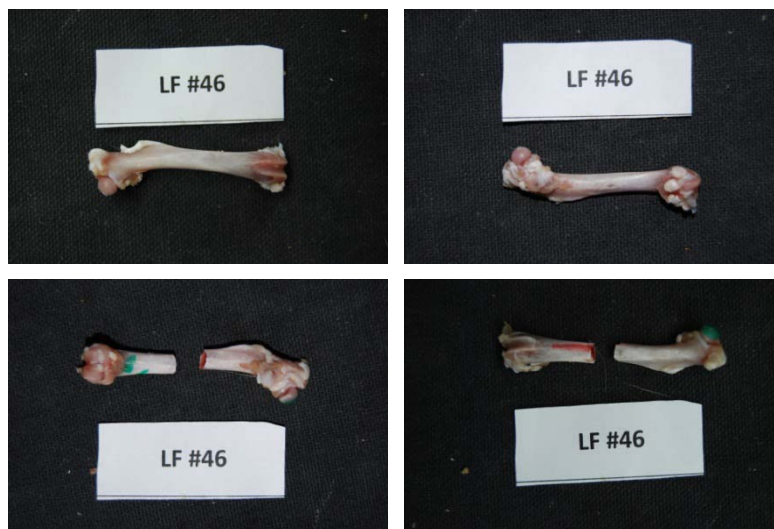
Εικόνα 253: Πρόσθια και οπίσθια όψη του δοκιμίου LF46 πριν και μετά το πείραμα κάμψης
