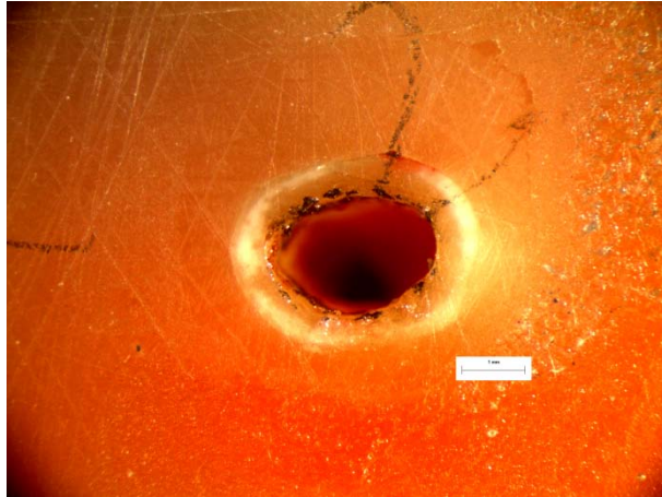
Εικόνα 174: Φωτογραφία από στερεοσκόπιο της διατομής στο σημείο αστοχίας δοκιμίου LF32. Στο επάνω μέρος της διατομής διακρίνεται το σημείο φόρτισης στα 10N.
