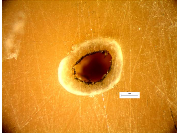
Εικόνα 195: Φωτογραφία από στερεοσκόπιο της διατομής στο σημείο αστοχίας δοκιμίου RF35.
