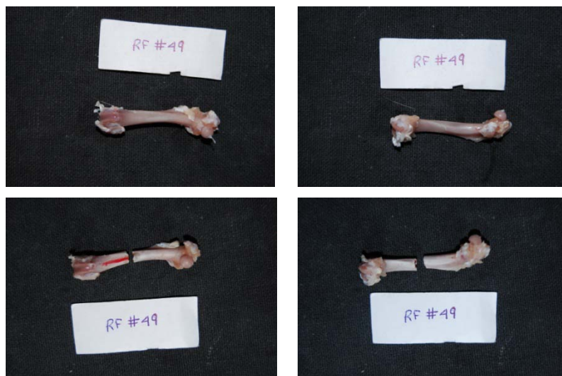
Εικόνα 264: Πρόσθια και οπίσθια όψη του δοκιμίου RF49 πριν και μετά το πείραμα κάμψης
