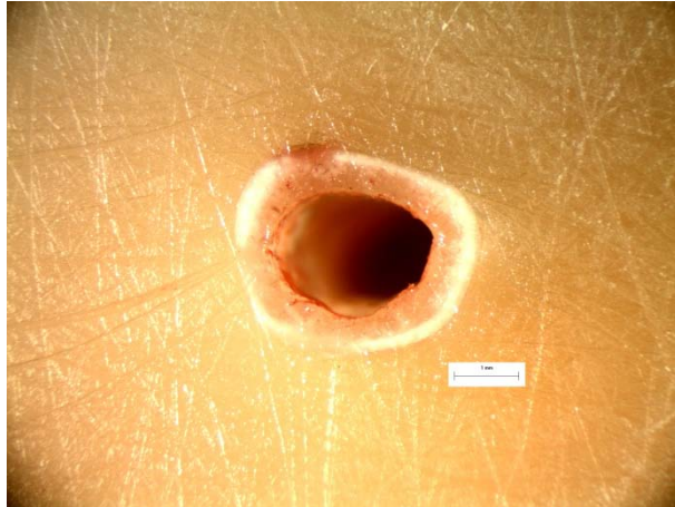
Εικόνα 107: Φωτογραφία από στερεοσκόπιο της διατομής στο σημείο αστοχίας δοκιμίου RF19. Είναι εμφανές το σημείο φόρτισης στα 10N.
