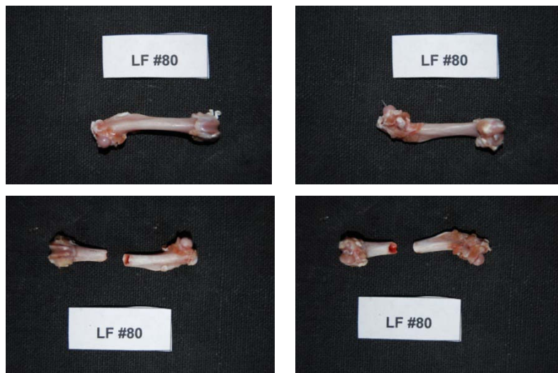
Εικόνα 350: Πρόσθια και οπίσθια όψη του δοκιμίου LF80 πριν και μετά το πείραμα κάμψης
