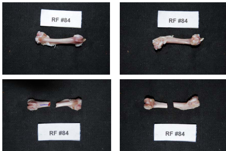
Εικόνα 367: Πρόσθια και οπίσθια όψη του δοκιμίου RF84 πριν και μετά το πείραμα κάμψης
