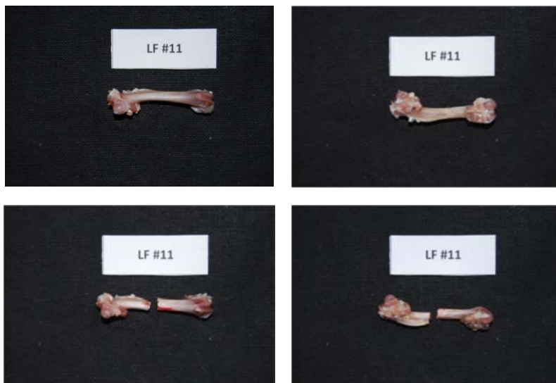
Εικόνα 58: Πρόσθια και οπίσθια όψη του δοκιμίου LF11 πριν και μετά το πείραμα κάμψης
