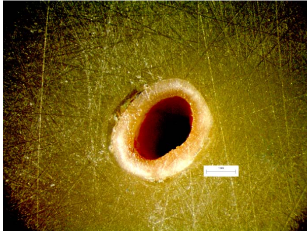
Εικόνα 233: Φωτογραφία από στερεοσκόπιο της διατομής στο σημείο αστοχίας δοκιμίου RF42. Στο αριστερό μέρος της διατομής διακρίνεται το σημείο φόρτισης στα 10N.
