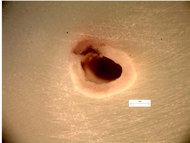
Εικόνα 277: Φωτογραφία από στερεοσκόπιο της διατομής στο σημείο αστοχίας δοκιμίου RF52. Είναι εμφανές το σημείο φόρτισης στα 10N.
