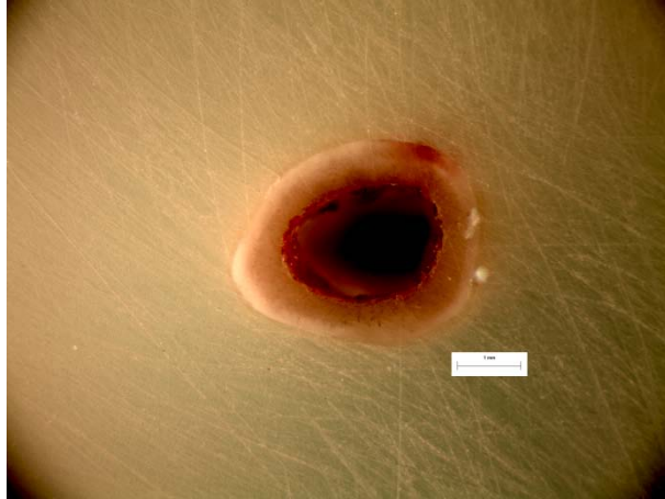
Εικόνα 140: Φωτογραφία από στερεοσκόπιο της διατομής στο σημείο αστοχίας δοκιμίου LF25. Είναι εμφανές το σημείο φόρτισης στα 10N.
