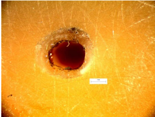
Εικόνα 134: Φωτογραφία από στερεοσκόπιο της διατομής κοντά στο σημείο αστοχίας του δοκιμίου LF24. Είναι εμφανές το σημείο φόρτισης του δοκιμίου στα 10N.
