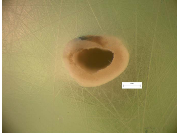
Εικόνα 374: Φωτογραφία από στερεοσκόπιο της διατομής στο σημείο αστοχίας δοκιμίου RF87. Στο επάνω μέρος φαίνεται το σημείο φόρτισης στα 10N.
