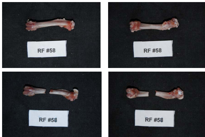
Εικόνα 296: Πρόσθια και οπίσθια όψη του δοκιμίου RF58 πριν και μετά το πείραμα κάμψης
