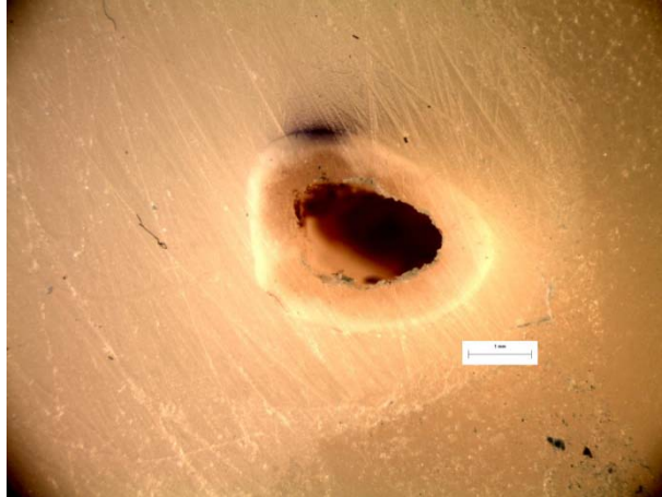
Εικόνα 283: Φωτογραφία από στερεοσκόπιο της διατομής στο σημείο αστοχίας δοκιμίου RF53. Είναι εμφανές το σημείο φόρτισης στα 10N.
