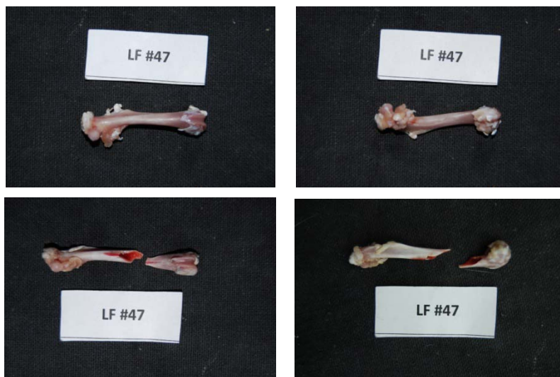
Εικόνα 255: Πρόσθια και οπίσθια όψη του δοκιμίου LF47 πριν και μετά το πείραμα κάμψης
