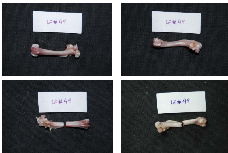
Εικόνα 263: Πρόσθια και οπίσθια όψη του δοκιμίου LF49 πριν και μετά το πείραμα κάμψης
