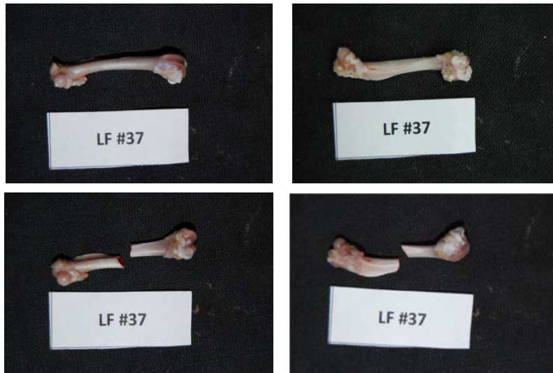
Εικόνα 201: Πρόσθια και οπίσθια όψη του δοκιμίου LF37 πριν και μετά το πείραμα κάμψης
