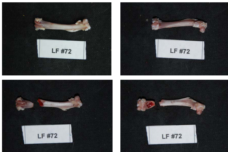
Εικόνα 322: Πρόσθια και οπίσθια όψη του δοκιμίου LF72 πριν και μετά το πείραμα κάμψης
