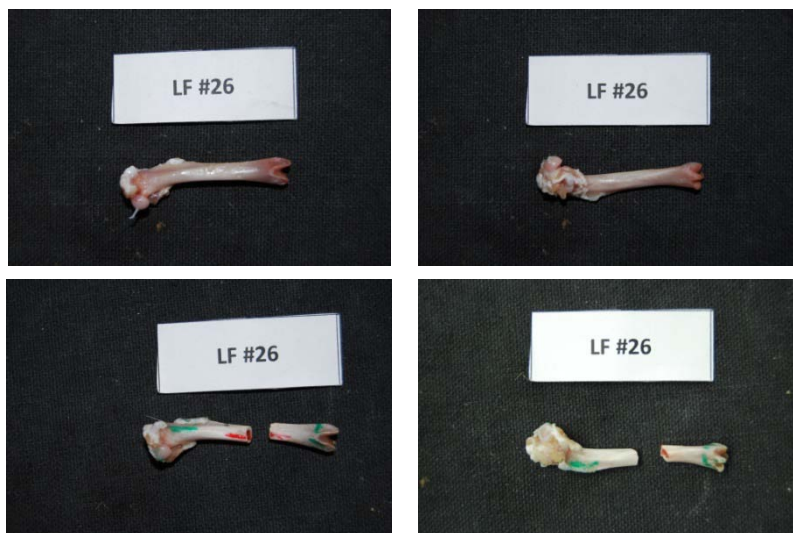
Εικόνα 145: Πρόσθια και οπίσθια όψη του δοκιμίου LF26 πριν και μετά το πείραμα κάμψης
