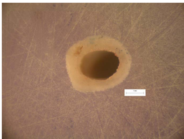
Εικόνα 344: Φωτογραφία από στερεοσκόπιο της διατομής στο σημείο αστοχίας δοκιμίου RF78.
