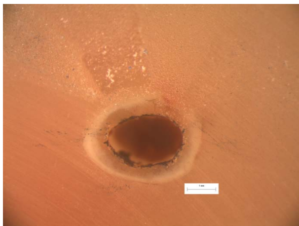
Εικόνα 116: Φωτογραφία από στερεοσκόπιο της διατομής στο σημείο αστοχίας δοκιμίου LF21
