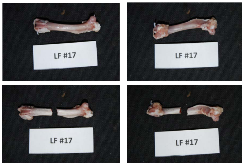
Εικόνα 91: Πρόσθια και οπίσθια όψη του δοκιμίου LF17 πριν και μετά το πείραμα κάμψης
