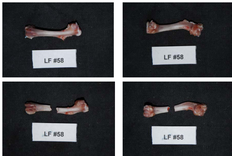
Εικόνα 295: Πρόσθια και οπίσθια όψη του δοκιμίου LF58 πριν και μετά το πείραμα κάμψης
