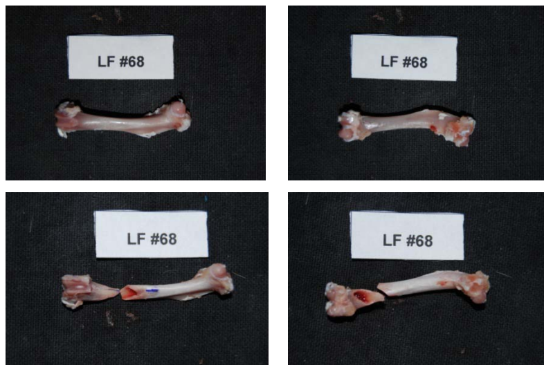
Εικόνα 315: Πρόσθια και οπίσθια όψη του δοκιμίου LF68 πριν και μετά το πείραμα κάμψης
