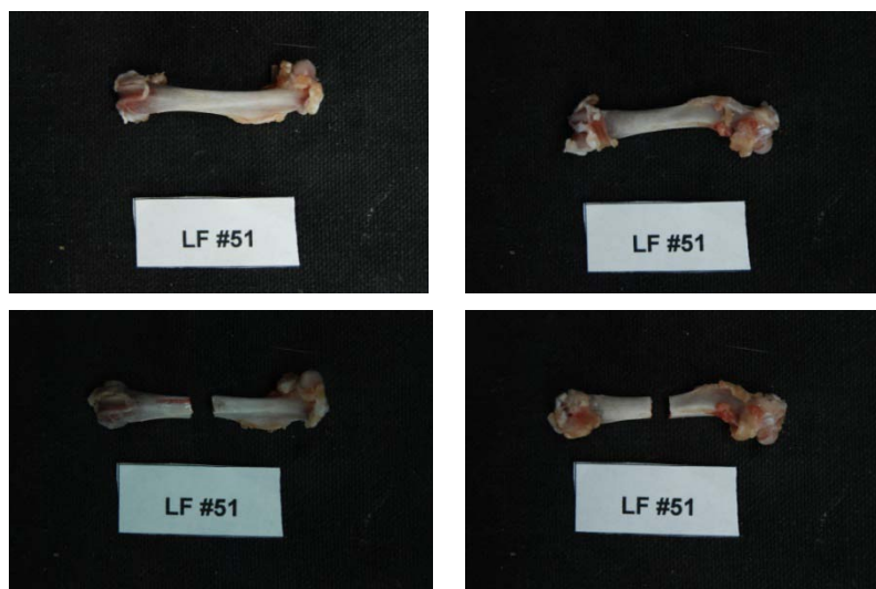
Εικόνα 267: Πρόσθια και οπίσθια όψη του δοκιμίου LF51 πριν και μετά το πείραμα κάμψης
