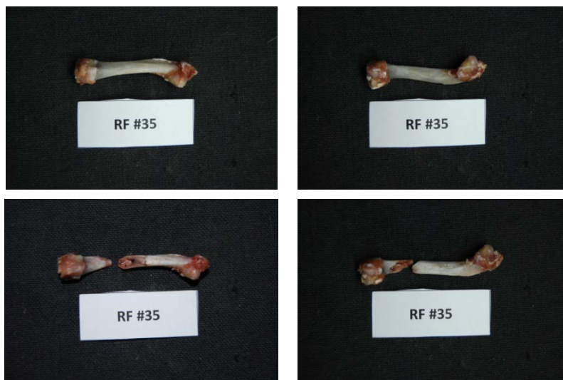
Γράφημα 194: Πρόσθια και οπίσθια όψη του δοκιμίου RF35 πριν και μετά το πείραμα κάμγης
