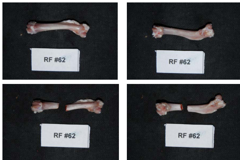
Εικόνα 304: Πρόσθια και οπίσθια όψη του δοκιμίου RF62 πριν και μετά το πείραμα κάμψης
