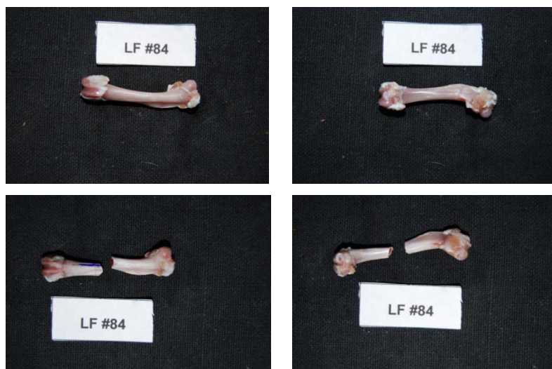
Εικόνα 366: Πρόσθια και οπίσθια όψη του δοκιμίου LF84 πριν και μετά το πείραμα κάμψης
