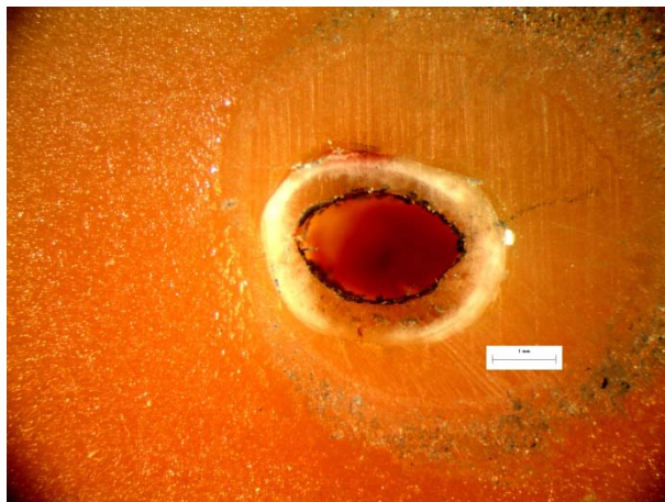
Εικόνα 177: Φωτογραφία από στερεοσκόπιο της διατομής στο σημείο αστοχίας δοκιμίου RF32. Είναι εμφανές το σημείο φόρτισης στα 10N.
