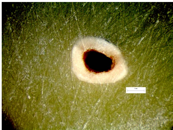
Εικόνα 211: Φωτογραφία από στερεοσκόπιο της διατομής στο σημείο αστοχίας δοκιμίου RF38
