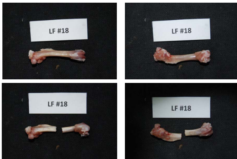
Εικόνα 97: Πρόσθια και οπίσθια όψη του δοκιμίου LF18 πριν και μετά το πείραμα κάμψης
