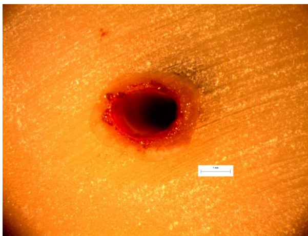
Εικόνα 24: Φωτογραφία από στερεοσκόπιο της διατομής στο σημείο αστοχίας δοκιμίου LF5. Στο επάνω μέρος της διατομής διακρίνεται το σημείο φόρτισης στα 10N.
