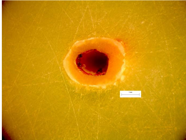
Εικόνα 156: Φωτογραφία από στερεοσκόπιο της διατομής στο σημείο αστοχίας δοκιμίου LF28. Στο επάνω μέρος της διατομής διακρίνεται το σημείο φόρτισης στα 10N.
