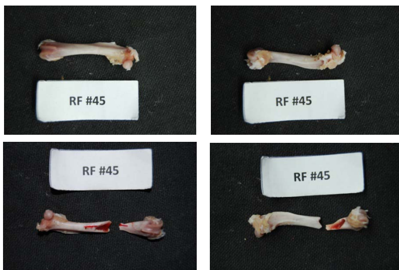
Εικόνα 250: Πρόσθια και οπίσθια όψη του δοκιμίου RF45 πριν και μετά το πείραμα κάμψης
