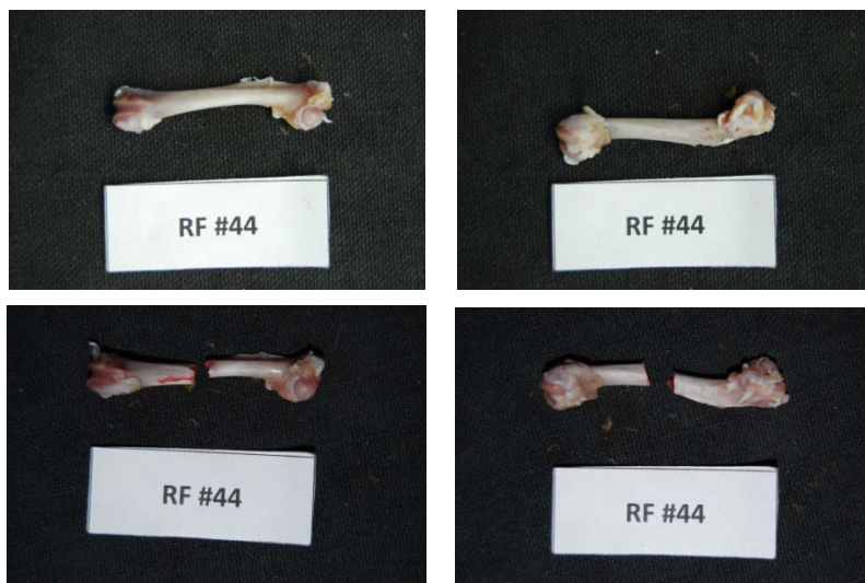
Εικόνα 244: Πρόσθια και οπίσθια όψη του δοκιμίου RF44 πριν και μετά το πείραμα κάμψης
