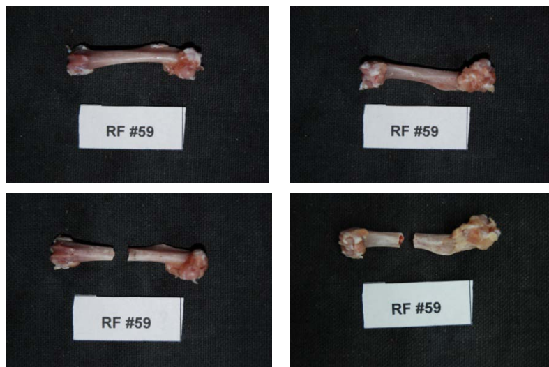
Εικόνα 298: Πρόσθια και οπίσθια όψη του δοκιμίου RF59 πριν και μετά το πείραμα κάμψης
