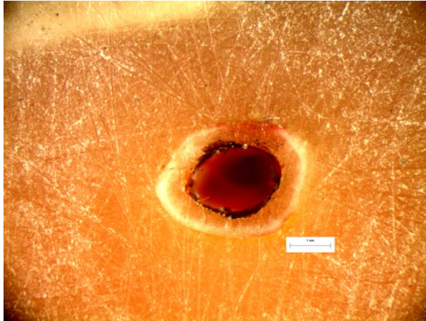
Εικόνα 122: Φωτογραφία από στερεοσκόπιο της διατομής στο σημείο αστοχίας του δοκιμίου LF22. Είναι εμφανές το σημείο προφόρτισης του δοκιμίου στα 10N.
