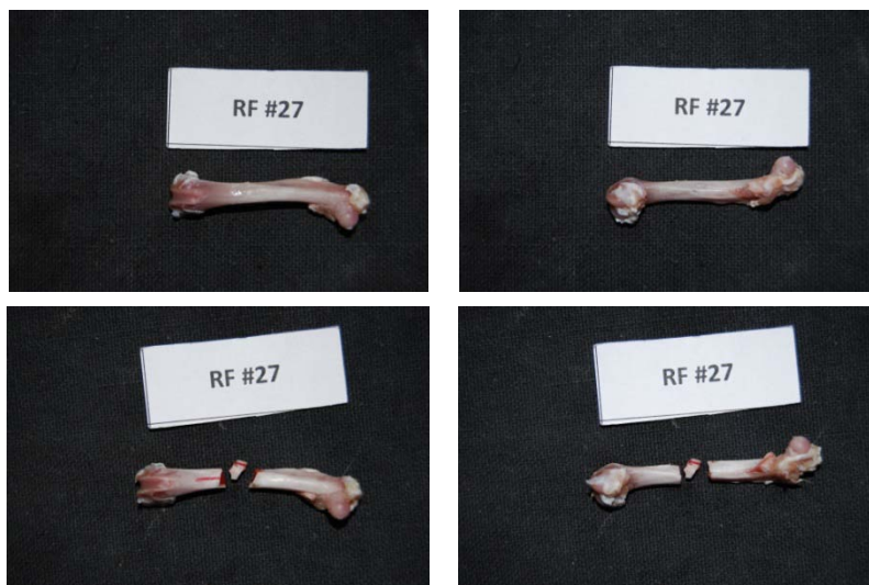
Εικόνα 152: Πρόσθια και οπίσθια όψη του δοκιμίου RF27 πριν και μετά το πείραμα κάμψης
