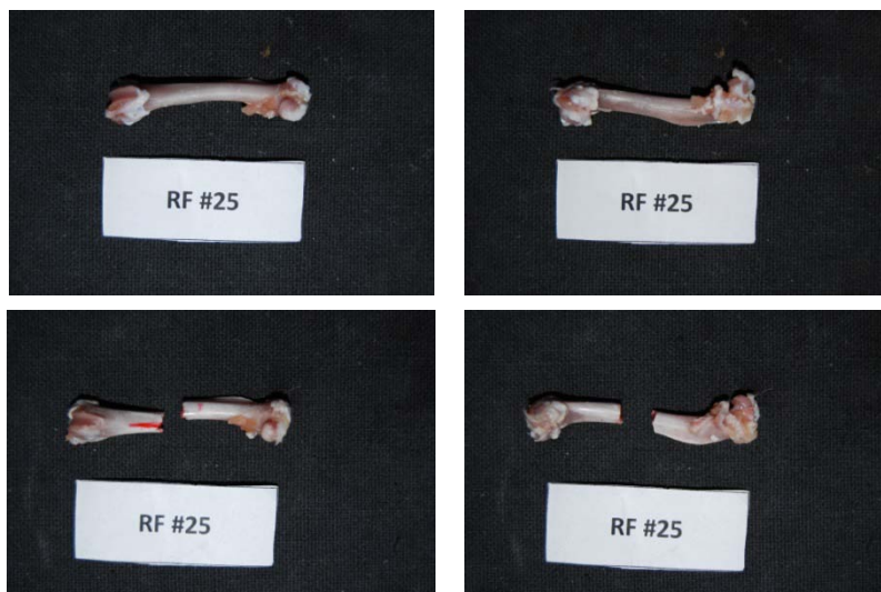
Εικόνα 142: Πρόσθια και οπίσθια όψη του δοκιμίου RF25 πριν και μετά το πείραμα κάμψης
