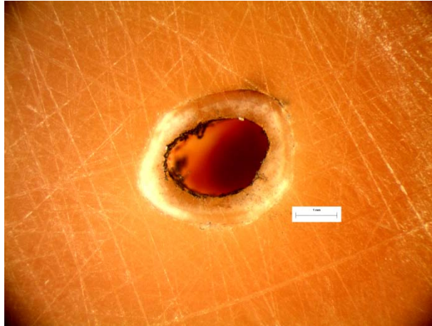
Εικόνα 165: Φωτογραφία από στερεοσκόπιο της διατομής στο σημείο αστοχίας δοκιμίου RF30. Είναι εμφανές το σημείο φόρτισης στα 10N.
