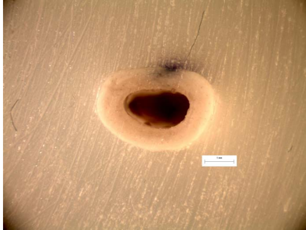
Εικόνα 286: Φωτογραφία από στερεοσκόπιο της διατομής στο σημείο αστοχίας δοκιμίου LF54. Είναι εμφανές το σημείο φόρτισης στα 10N.
