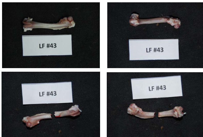
Εικόνα 235: Πρόσθια και οπίσθια όψη του δοκιμίου LF43 πριν και μετά το πείραμα κάμψης
