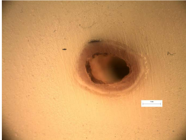
Εικόνα 230: Φωτογραφία από στερεοσκόπιο της διατομής στο σημείο αστοχίας δοκιμίου LF42. Είναι εμφανές το σημείο φόρτισης στα 10N.
