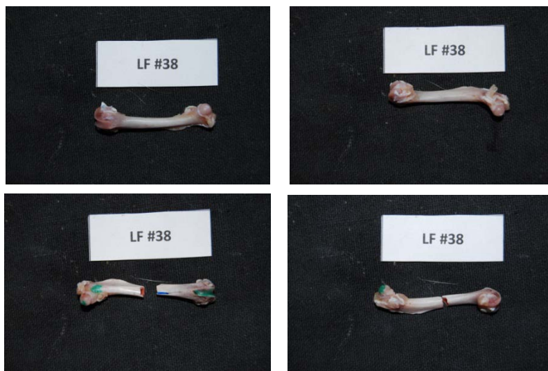
Εικόνα 207: Πρόσθια και οπίσθια όψη του δοκιμίου LF38 πριν και μετά το πείραμα κάμψης
