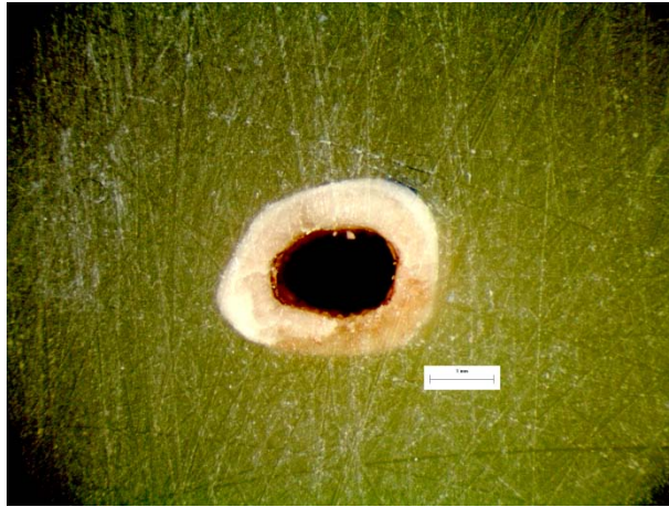
Εικόνα 208: Φωτογραφία από στερεοσκόπιο της διατομής στο σημείο αστοχίας δοκιμίου LF38
