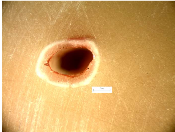
Εικόνα 92: Φωτογραφία από στερεοσκόπιο της διατομής στο σημείο αστοχίας δοκιμίου LF17. Είναι εμφανές το σημείο φόρτισης στα 10N.
