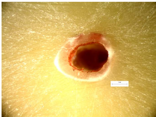
Εικόνα 104: Φωτογραφία από στερεοσκόπιο της διατομής στο σημείο αστοχίας δοκιμίου LF19. Είναι εμφανές το σημείο φόρτισης στα 10N.
