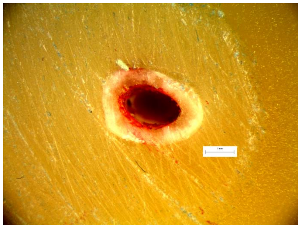
Εικόνα 199: Φωτογραφία από στερεοσκόπιο της διατομής στο σημείο αστοχίας δοκιμίου RF36. Στο επάνω μέρος της διατομής διακρίνεται το σημείο φόρτισης στα 10N.
