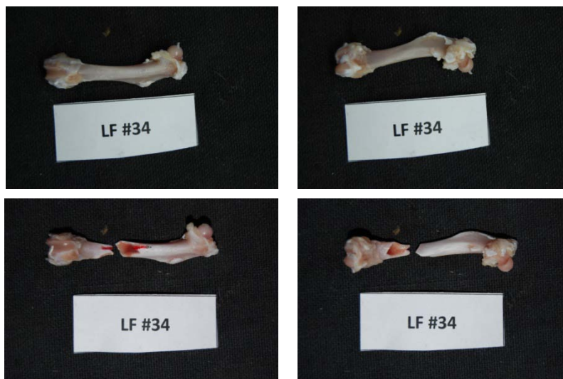
Εικόνα 185: Πρόσθια και οπίσθια όψη του δοκιμίου LF34 πριν και μετά το πείραμα κάμψης
