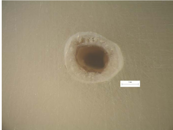
Εικόνα 330: Φωτογραφία από στερεοσκόπιο της διατομής στο σημείο αστοχίας δοκιμίου RF74.
