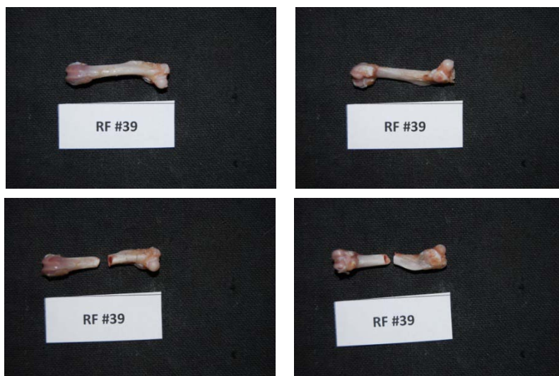
Εικόνα 216: Πρόσθια και οπίσθια όψη του δοκιμίου RF39 πριν και μετά το πείραμα κάμψης
