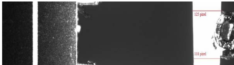
Εικόνα 4.2.1.1: Φωτογραφία από το οπτικό μηκυνσιόμετρο όπου σημειώνονται οι διάμετροι του οστού δεξιά και αριστερά του εμβόλου. Η διάμετρος που θα χρησιμοποιηθεί για τον υπολογισμό της διεύθυνσης φόρτισης αντιστοιχεί στο μέσο όρο τους.
