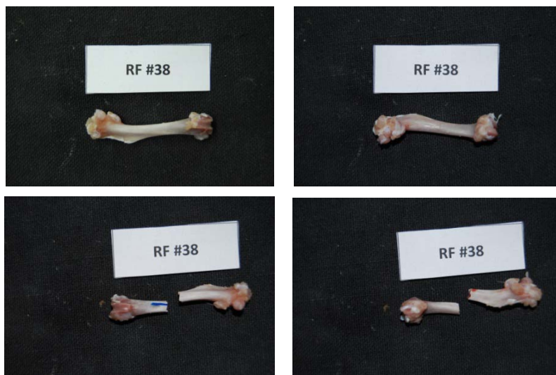
Εικόνα 210: Πρόσθια και οπίσθια όψη του δοκιμίου RF38 πριν και μετά το πείραμα κάμψης
