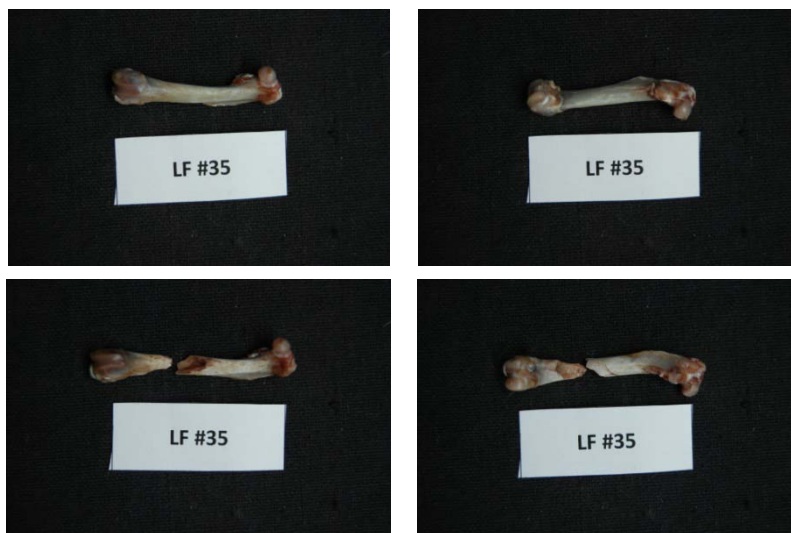
Εικόνα 191: Πρόσθια και οπίσθια όψη του δοκιμίου LF35 πριν και μετά το πείραμα κάμψης
