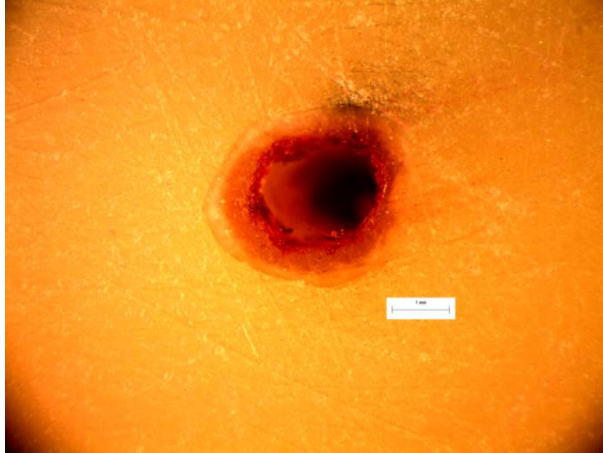
Εικόνα 36: Φωτογραφία από στερεοσκόπιο της διατομής στο σημείο αστοχίας δοκιμίου LF7. Είναι εμφανές το σημείο φόρτισης του δοκιμίου στα 10N.
