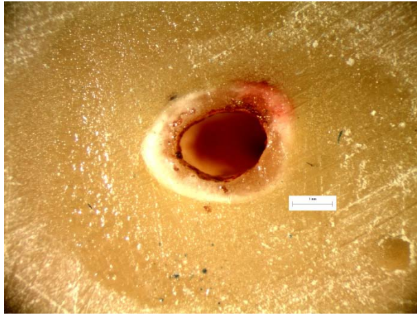
Εικόνα 98: Φωτογραφία από στερεοσκόπιο της διατομής στο σημείο αστοχίας δοκιμίου LF18. Είναι εμφανές το σημείο φόρτισης στα 10N.
