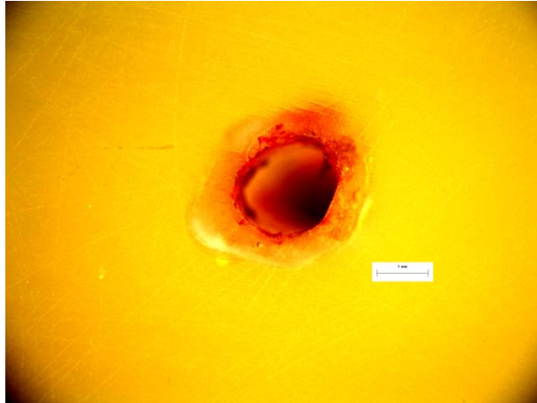
Εικόνα 242: Φωτογραφία από στερεοσκόπιο της διατομής στο σημείο αστοχίας δοκιμίου LF44. Στο επάνω μέρος της διατομής διακρίνεται το σημείο φόρτιση στα 10N.
