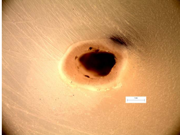
Εικόνα 280: Φωτογραφία από στερεοσκόπιο της διατομής στο σημείο αστοχίας δοκιμίου LF53. Είναι εμφανές το σημείο φόρτισης στα 10N.
