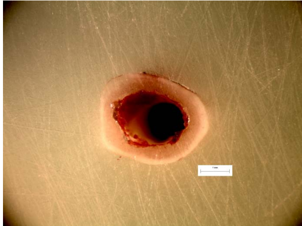
Εικόνα 153: Φωτογραφία από στερεοσκόπιο της διατομής στο σημείο αστοχίας δοκιμίου RF27. Στο επάνω μέρος της διατομής διακρίνεται το σημείο φόρτισης στα 10N.
