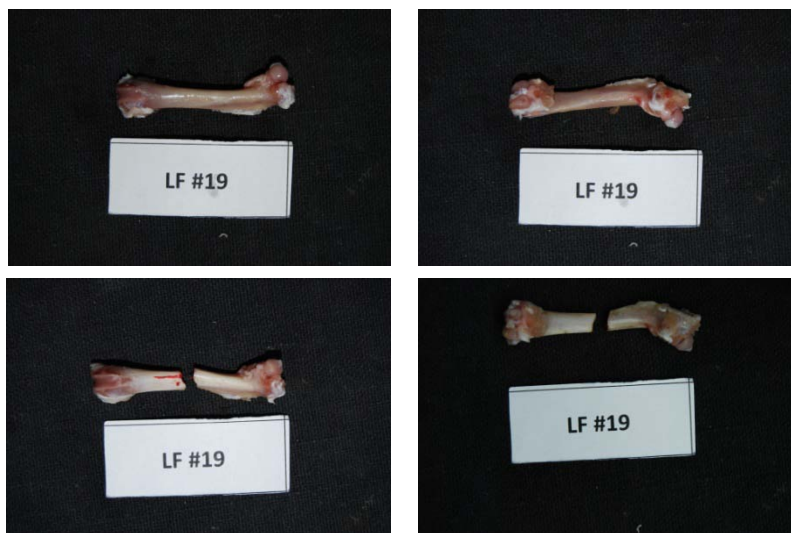
Εικόνα 103: Πρόσθια και οπίσθια όψη του δοκιμίου LF19 πριν και μετά το πείραμα κάμψης
