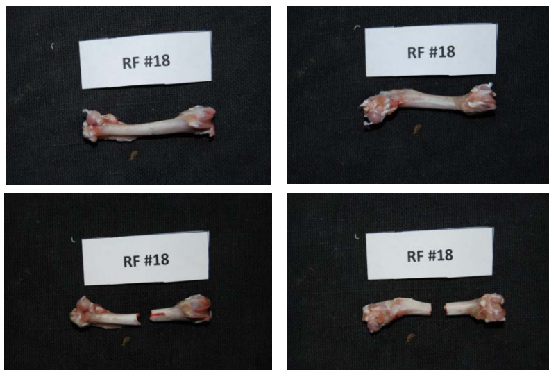
Εικόνα 100: Πρόσθια και οπίσθια όψη του δοκιμίου RF18 πριν και μετά το πείραμα κάμψης
