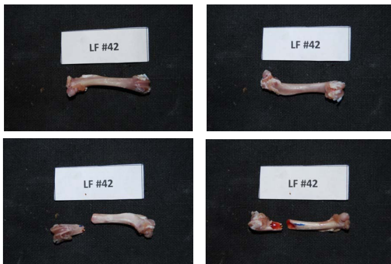
Εικόνα 229: Πρόσθια και οπίσθια όψη του δοκιμίου LF42 πριν και μετά το πείραμα κάμψης
