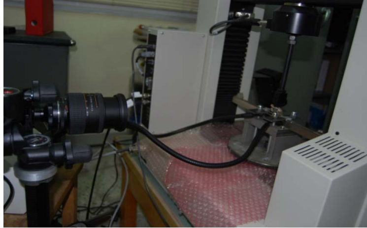
Εικόνα 3.4.1.2: Η διάταξη του οπτικού μηκυσιόμετρου και του πλαισίου φόρτισης
