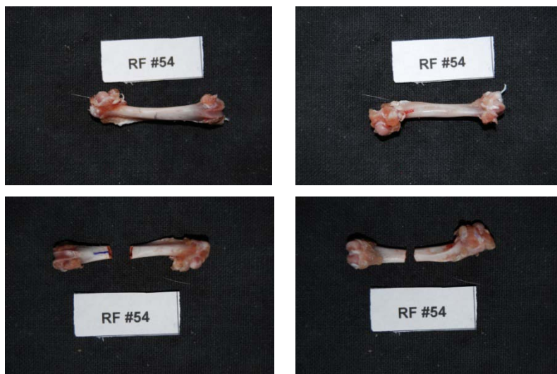
Εικόνα 288: Πρόσθια και οπίσθια όψη του δοκιμίου RF54 πριν και μετά το πείραμα κάμψης
