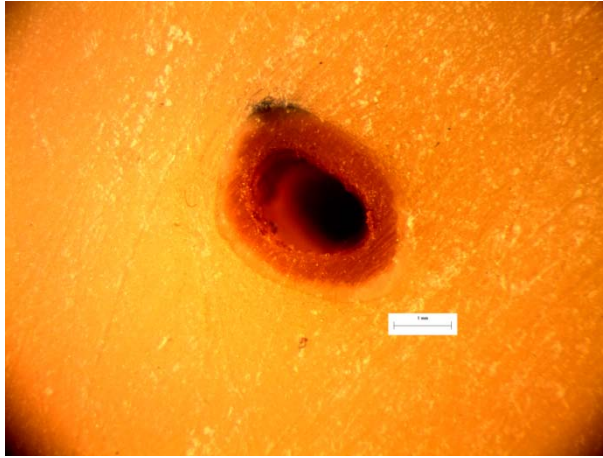
Εικόνα 39: Φωτογραφία από στερεοσκόπιο της διατομής στο σημείο αστοχίας δοκιμίου RF7. Είναι εμφανές το σημείο φόρτισης του δοκιμίου στα 10N.
