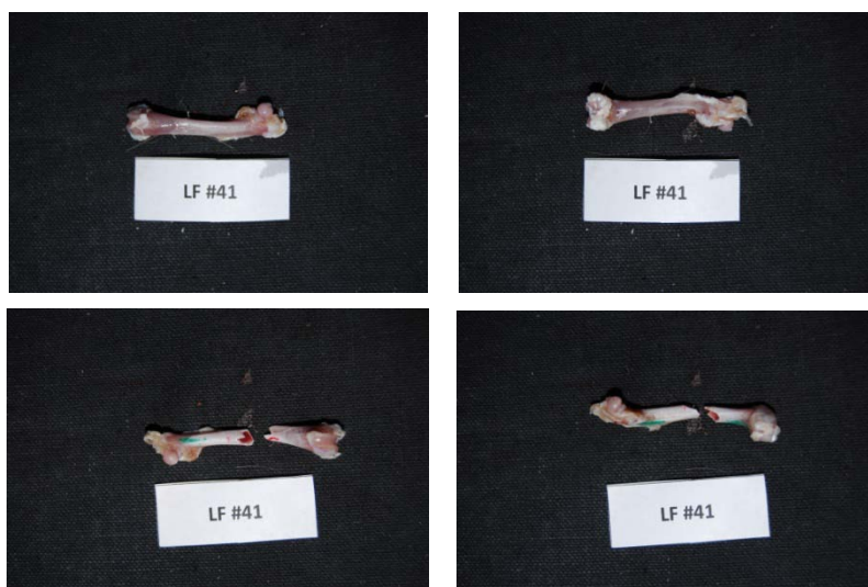
Εικόνα 223: Πρόσθια και οπίσθια όψη του δοκιμίου LF41 πριν και μετά το πείραμα κάμψης
