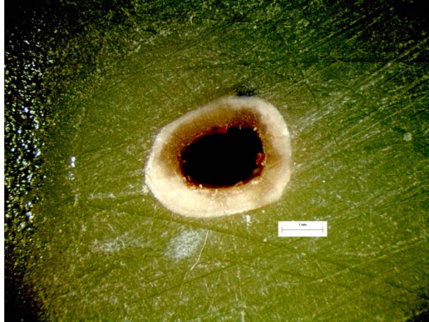
Εικόνα 220: Φωτογραφία από στερεοσκόπιο της διατομής στο σημείο αστοχίας δοκιμίου LF40. Είναι εμφανές το σημείο φόρτισης στα 10N.
