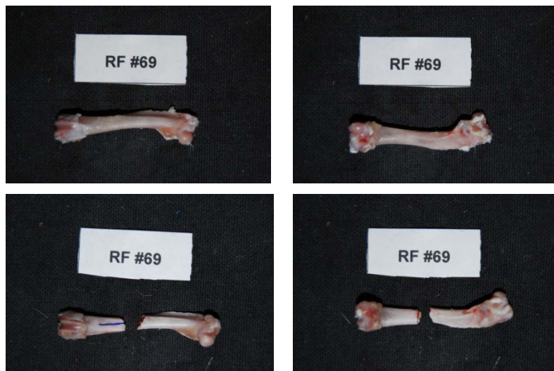
Εικόνα 318: Πρόσθια και οπίσθια όψη του δοκιμίου RF69 πριν και μετά το πείραμα κάμψης
