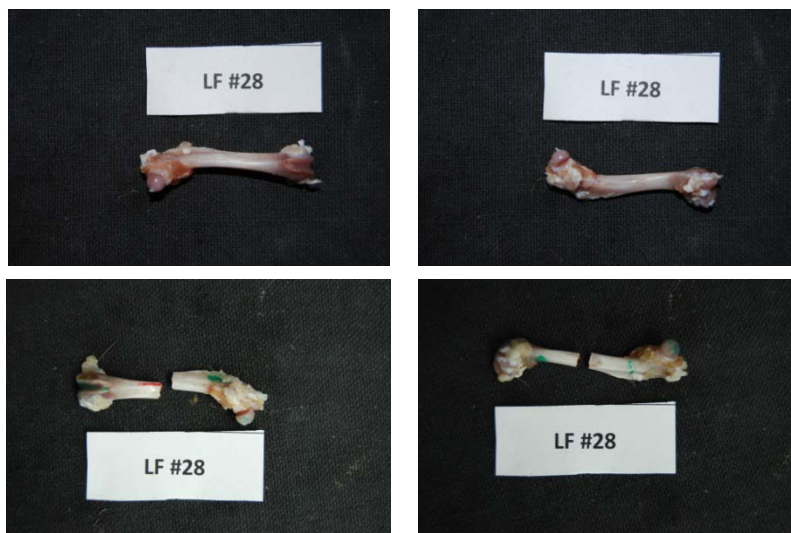
Εικόνα 155: Πρόσθια και οπίσθια όψη του δοκιμίου LF28 πριν και μετά το πείραμα κάμψης
