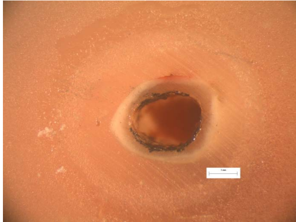
Εικόνα 86 : Φωτογραφία από στερεοσκόπιο της διατομής κοντά στο σημείο αστοχίας του δοκιμίου LF16. Στο επάνω μέρος της διατομής διακρίνεται το σημείο φόρτισης στα 10N.
