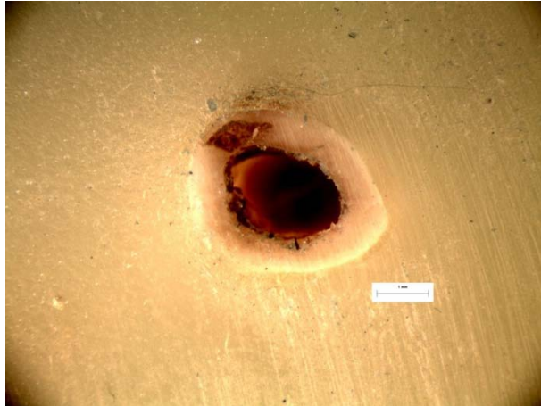
Εικόνα 271: Φωτογραφία από στερεοσκόπιο της διατομής στο σημείο αστοχίας δοκιμίου RF51.
