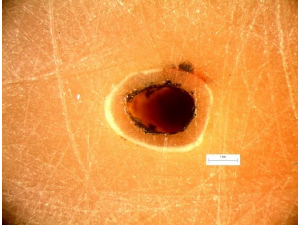
Εικόνα 62: Φωτογραφία από στερεοσκόπιο της διατομής κοντά στο σημείο αστοχίας του δοκιμίου RF11. Είναι εμφανές το σημείο φόρτισης στα 10N.
