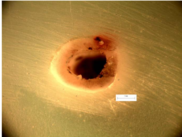
Εικόνα 268: Φωτογραφία από στερεοσκόπιο της διατομής στο σημείο αστοχίας δοκιμίου LF51. Είναι εμφανές το σημείο φόρτισης στα 10N.
