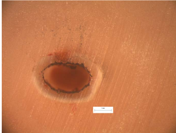
Εικόνα 119: Φωτογραφία από στερεοσκόπιο της διατομής κοντά στο σημείο αστοχίας του δοκιμίου RF21. Στο επάνω μέρος της διατομής διακρίνεται το σημείο φόρτισης στα 10N.
