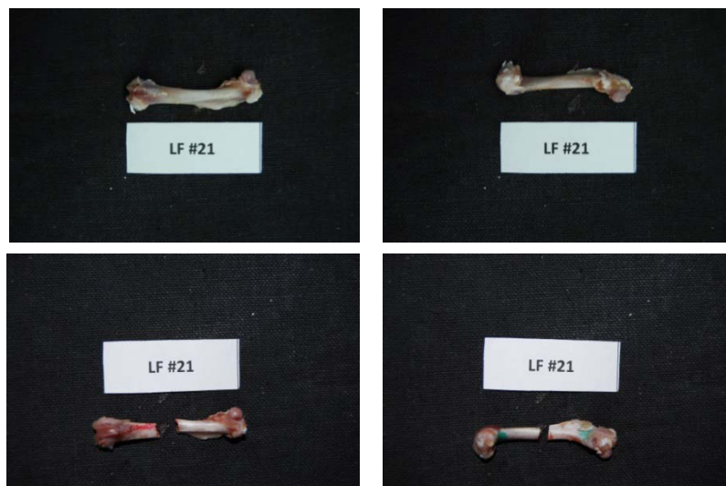
Εικόνα 115: Πρόσθια και οπίσθια όψη του δοκιμίου LF21 πριν και μετά το πείραμα κάμψης
