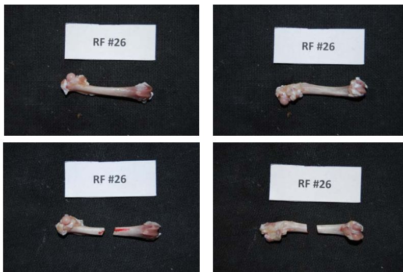
Εικόνα 148: Πρόσθια και οπίσθια όψη του δοκιμίου RF26 πριν και μετά το πείραμα κάμψης
