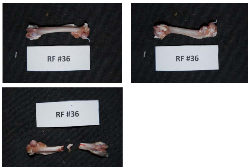
Εικόνα 198: Πρόσθια και οπίσθια όψη του δοκιμίου RF36 πριν και μετά το πείραμα κάμψης
