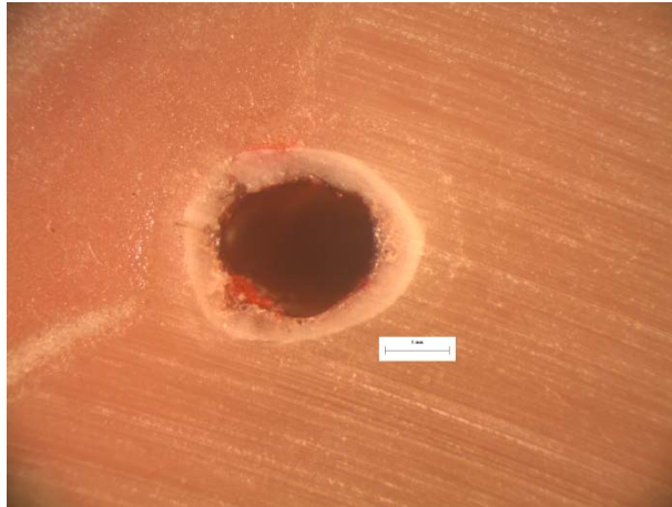
Εικόνα 261: Φωτογραφία από στερεοσκόπιο της διατομής στο σημείο αστοχίας δοκιμίου RF48.
