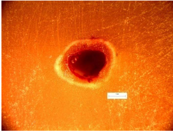
Εικόνα 14: Φωτογραφία από στερεοσκόπιο της διατομής στο σημείο αστοχίας δοκιμίου LF3. Στο επάνω μέρος της διατομής διακρίνεται το σημείο φόρτισης στα 10N.
