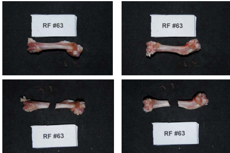
Εικόνα 306: Πρόσθια και οπίσθια όψη του δοκιμίου RF63 πριν και μετά το πείραμα κάμψης
