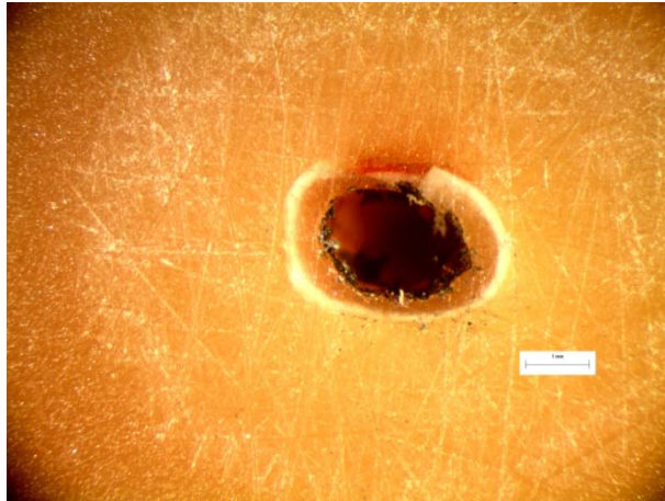
Εικόνα 2: Φωτογραφία από στερεοσκόπιο της διατομής κοντά στο σημείο αστοχίας του δοκιμίου LF1. Είναι εμφανές το σημείο φόρτισης του δοκιμίου στα 10N.
