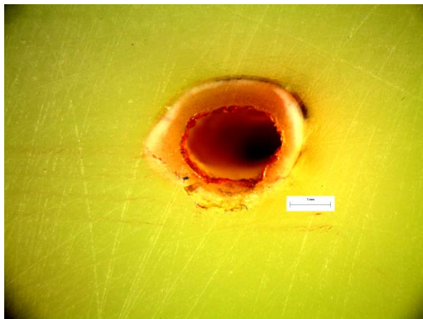
Εικόνα 248: Φωτογραφία από στερεοσκόπιο της διατομής στο σημείο αστοχίας δοκιμίου LF45. Είναι εμφανές το σημείο φόρτισης στα 10N.
