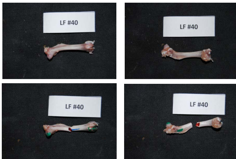
Εικόνα 219: Πρόσθια και οπίσθια όψη του δοκιμίου LF40 πριν και μετά το πείραμα κάμψης
