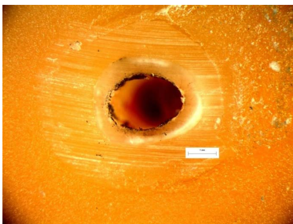
Εικόνα 137: Φωτογραφία από στερεοσκόπιο της διατομής κοντά στο σημείο αστοχίας του δοκιμίου RF24. Στο επάνω μέρος της διατομής διακρίνεται το σημείο φόρτισης στα 10N.
