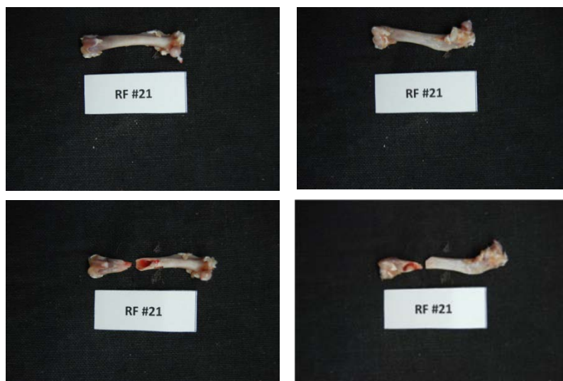
Εικόνα 118: Πρόσθια και οπίσθια όψη του δοκιμίου RF21 πριν και μετά το πείραμα κάμψης
