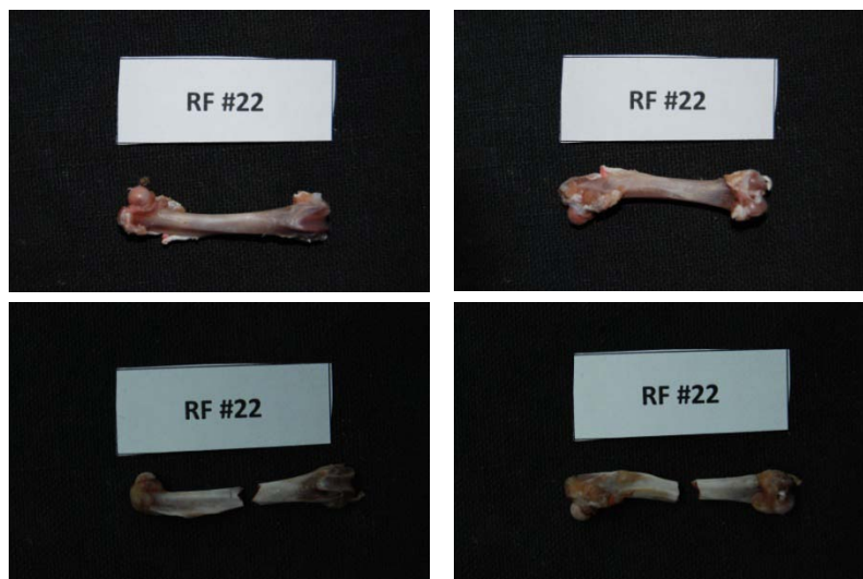
Εικόνα 124: Πρόσθια και οπίσθια όψη του δοκιμίου RF22 πριν και μετά το πείραμα κάμψης
