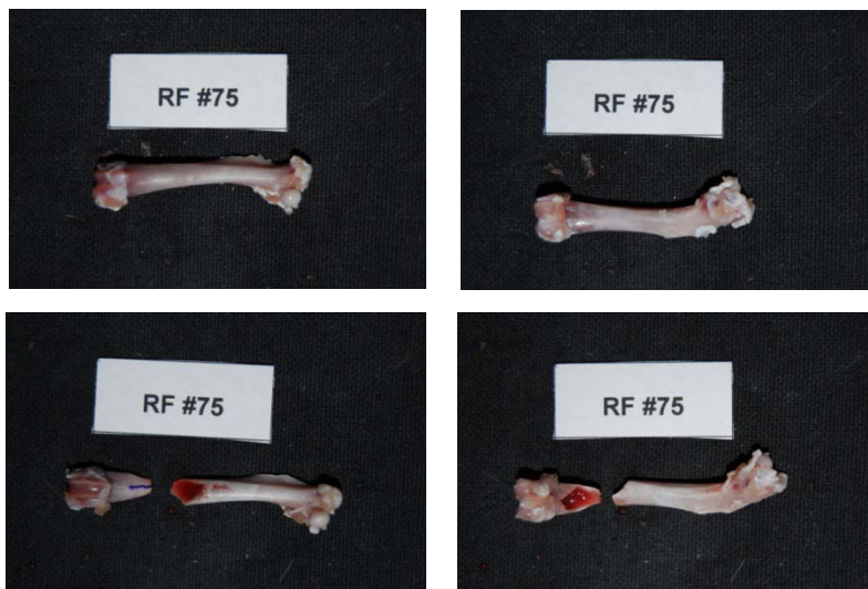
Εικόνα 333: Πρόσθια και οπίσθια όψη του δοκιμίου RF75 πριν και μετά το πείραμα κάμψης
