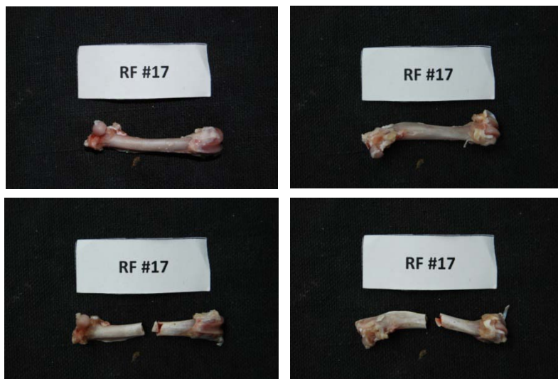
Εικόνα 94: Πρόσθια και οπίσθια όψη του δοκιμίου RF17 πριν και μετά το πείραμα κάμψης
