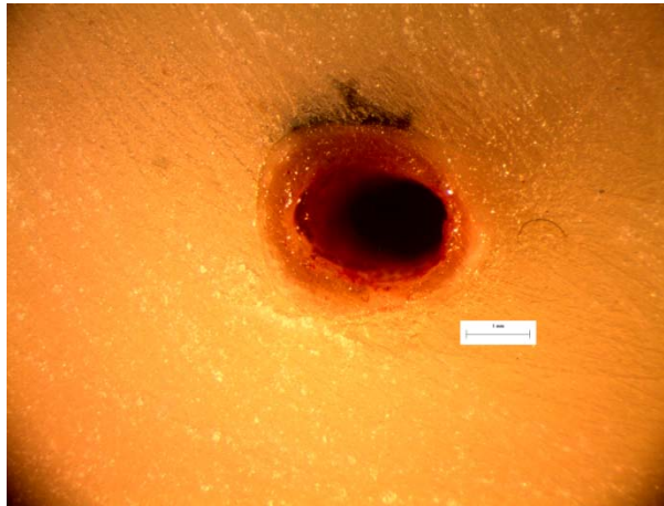
Εικόνα 41: Φωτογραφία από στερεοσκόπιο της διατομής στο σημείο αστοχίας δοκιμίου LF8. Είναι εμφανές το σημείο φόρτισης του δοκιμίου στα 10N.
