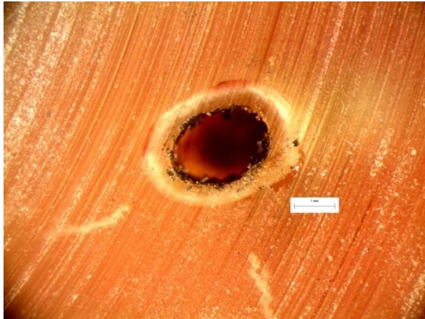
Εικόνα 75: Φωτογραφία από στερεοσκόπιο της διατομής κοντά στο σημείο αστοχίας του δοκιμίου LF14. Στο επάνω μέρος της διατομής διακρίνεται το σημείο φόρτισης στα 10N.
