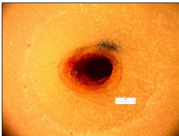
Εικόνα 30: Φωτογραφία από στερεοσκόπιο της διατομής στο σημείο αστοχίας δοκιμίου LF6. Είναι εμφανές το σημείο φόρτισης του δοκιμίου στα 10N.
