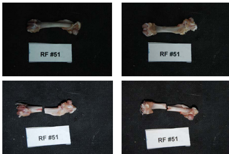
Εικόνα 270: Πρόσθια και οπίσθια όψη του δοκιμίου RF51 πριν και μετά το πείραμα κάμψης
