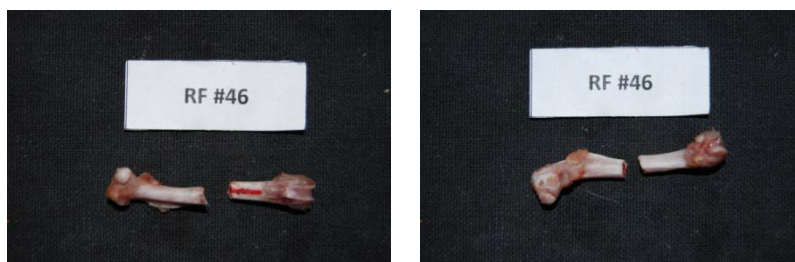
Εικόνα 254: Πρόσθια και οπίσθια όψη του δοκιμίου RF46 μετά το πείραμα κάμψης
