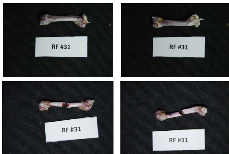
Εικόνα 170: Πρόσθια και οπίσθια όψη του δοκιμίου RF31 πριν και μετά το πείραμα κάμψης
