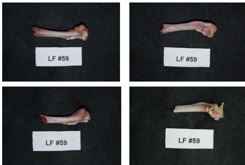
Εικόνα 297: Πρόσθια και οπίσθια όψη του δοκιμίου LF59 πριν και μετά το πείραμα κάμψης
