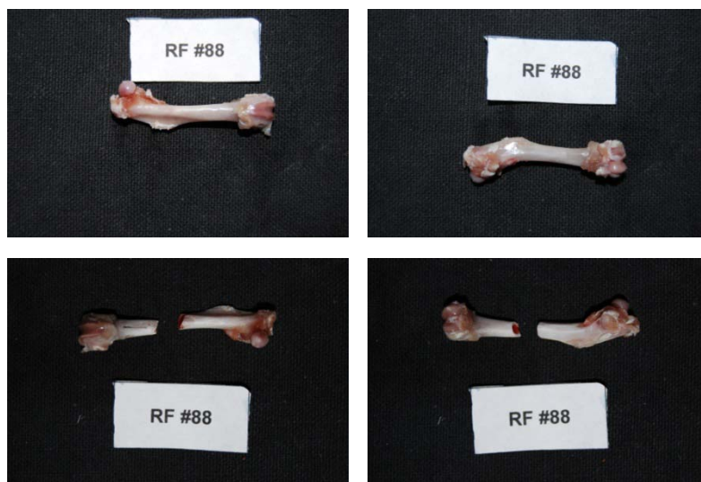
Εικόνα 377: Πρόσθια και οπίσθια όψη του δοκιμίου RF88 πριν και μετά το πείραμα κάμψης.
