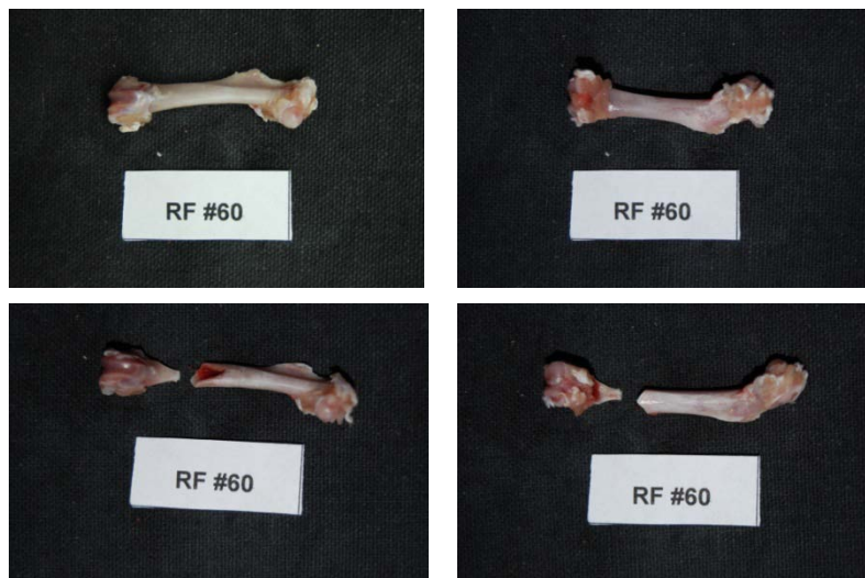
Εικόνα 300: Πρόσθια και οπίσθια όψη του δοκιμίου RF60 πριν και μετά το πείραμα κάμψης
