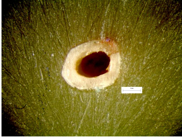
Εικόνα 205: Φωτογραφία από στερεοσκόπιο της διατομής στο σημείο αστοχίας δοκιμίου RF37. Στο επάνω μέρος της διατομής διακρίνεται το σημείο φόρτισης στα 10N.
