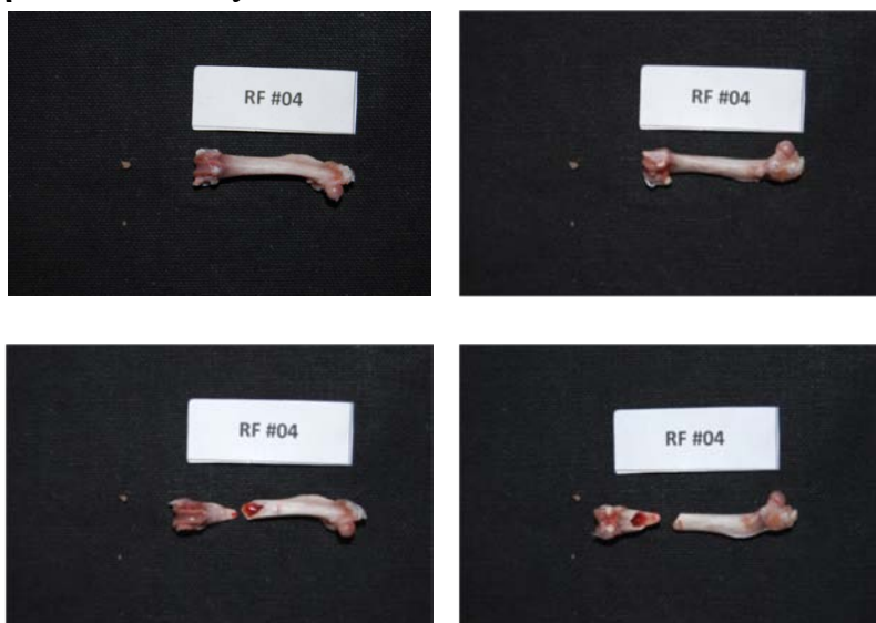
Εικόνα 22: Πρόσθια και οπίσθια όψη του δοκιμίου RF4 πριν και μετά το πείραμα κάμψης
