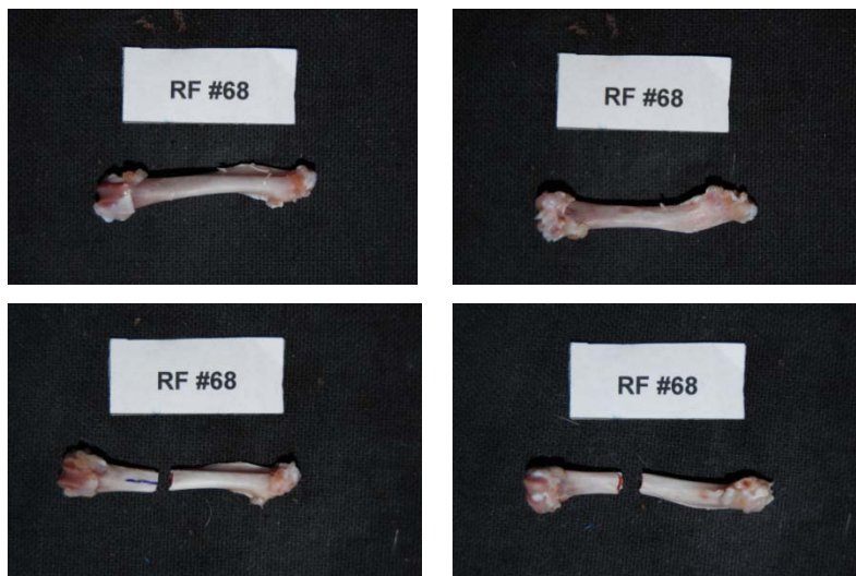
Εικόνα 316: Πρόσθια και οπίσθια όψη του δοκιμίου RF68 πριν και μετά το πείραμα κάμψης
