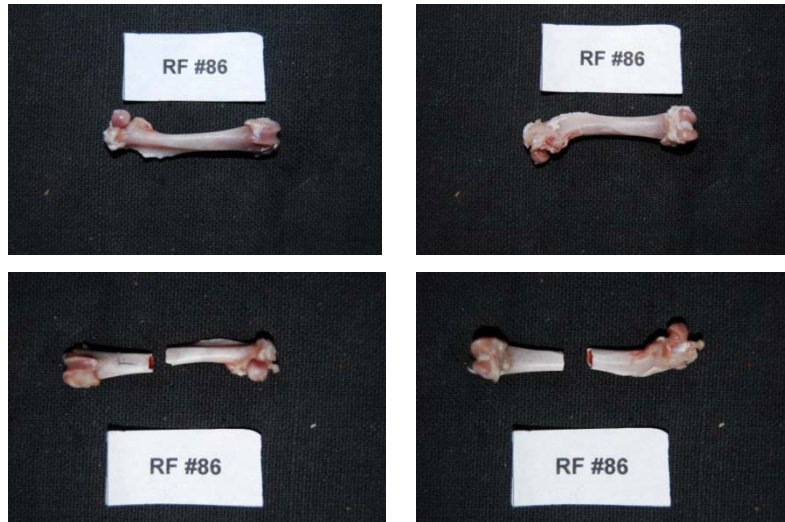
Εικόνα 371: Πρόσθια και οπίσθια όψη του δοκιμίου RF86 πριν και μετά το πείραμα κάμψης
