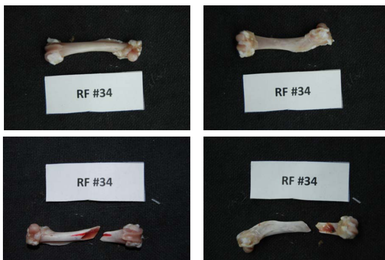
Εικόνα 188: Πρόσθια και οπίσθια όψη του δοκιμίου RF34 πριν και μετά το πείραμα κάμψης
