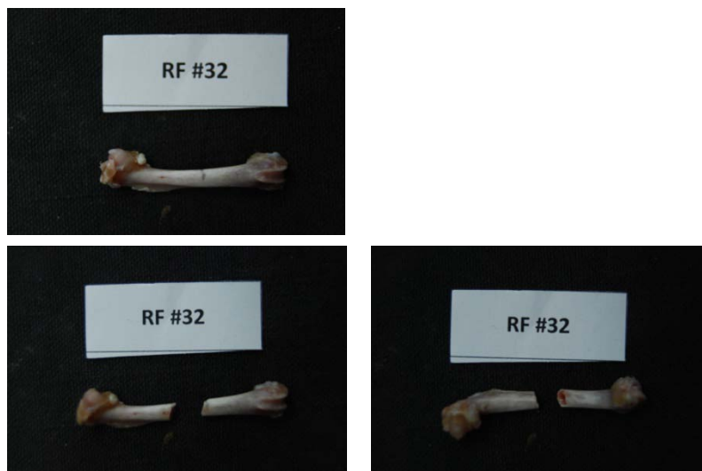
Εικόνα 176: Πρόσθια και οπίσθια όψη του δοκιμίου RF32 πριν και μετά το πείραμα κάμψης
