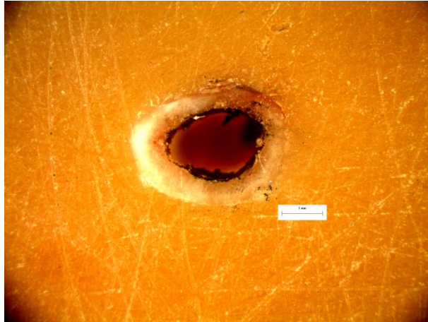
Εικόνα 168: Φωτογραφία από στερεοσκόπιο της διατομής στο σημείο αστοχίας δοκιμίου LF31. Είναι εμφανές το σημείο φόρτισης στα 10N.
