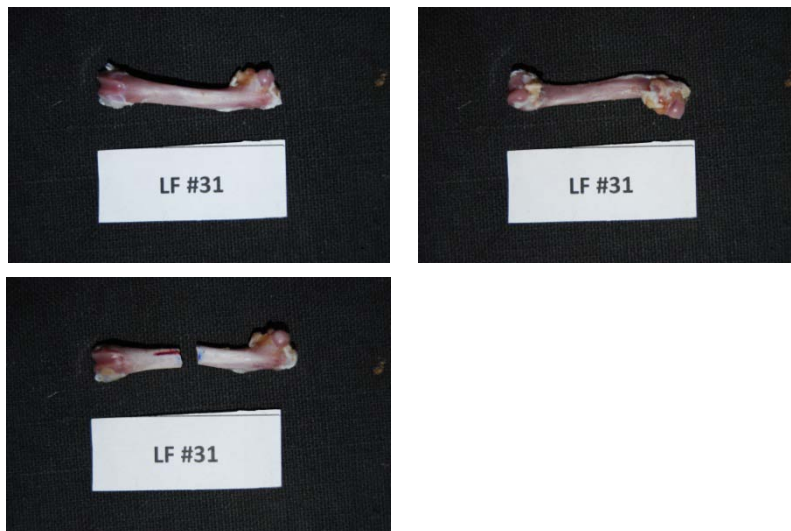
Εικόνα 167: Πρόσθια και οπίσθια όψη του δοκιμίου LF31 πριν και μετά το πείραμα κάμψης
