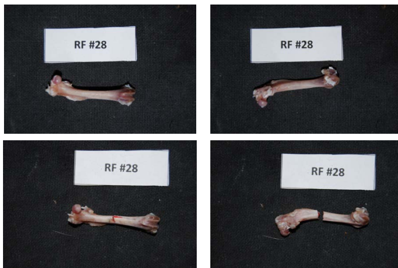
Εικόνα 158: Πρόσθια και οπίσθια όψη του δοκιμίου RF28 πριν και μετά το πείραμα κάμψης
