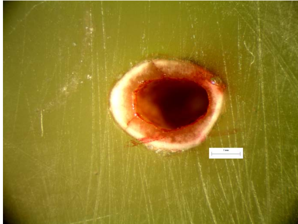
Εικόνα 251: Φωτογραφία από στερεοσκόπιο της διατομής στο σημείο αστοχίας δοκιμίου RF45. Στο επάνω μέρος της διατομής διακρίνεται το σημείο φόρτισης στα 10N.
