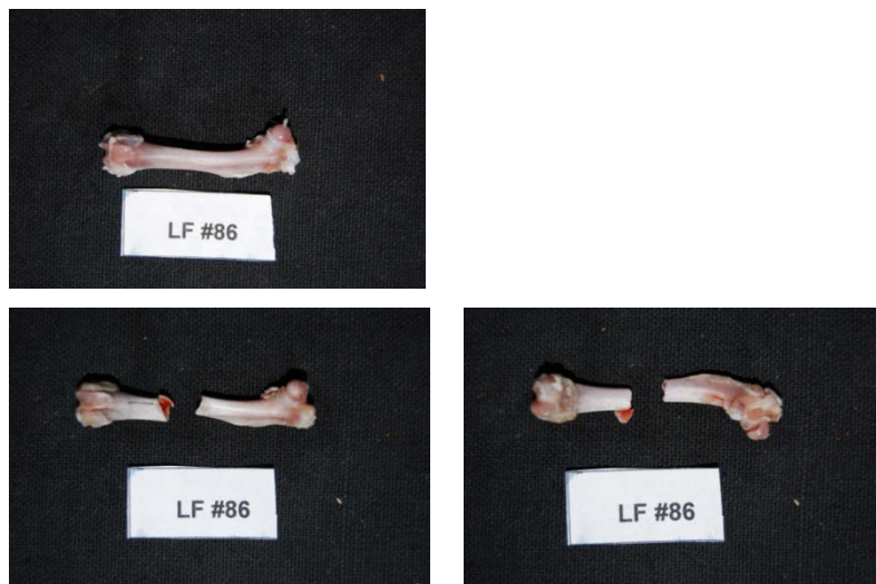
Εικόνα 370: Πρόσθια και οπίσθια όψη του δοκιμίου LF86 πριν και μετά το πείραμα κάμψης
