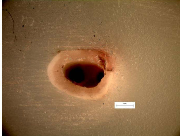
Εικόνα 274: Φωτογραφία από στερεοσκόπιο της διατομής στο σημείο αστοχίας δοκιμίου LF52.
