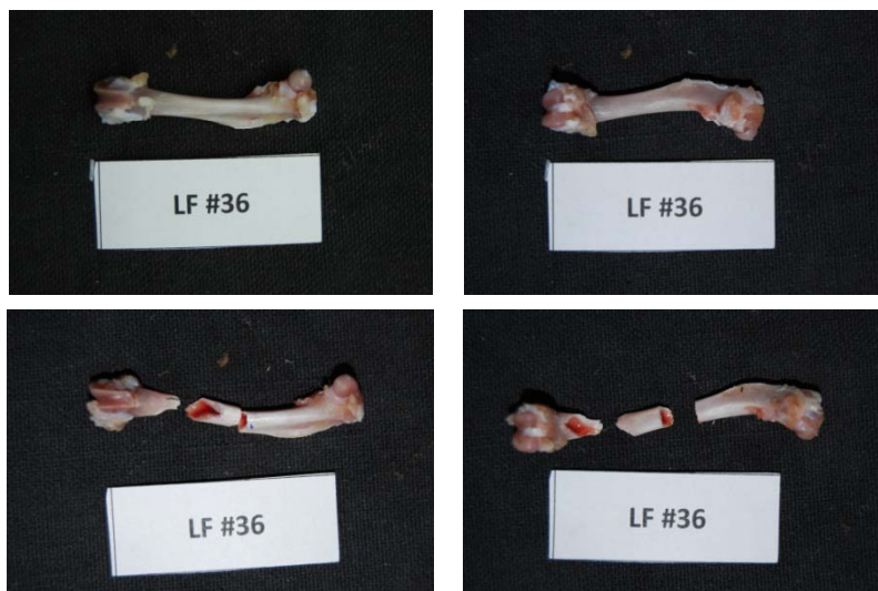
Εικόνα 197: Πρόσθια και οπίσθια όψη του δοκιμίου LF36 πριν και μετά το πείραμα κάμψης
