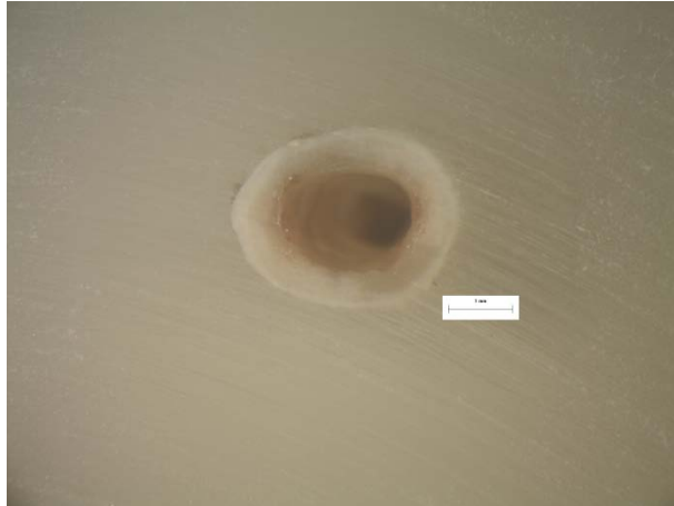
Εικόνα 214: Φωτογραφία από στερεοσκόπιο της διατομής στο σημείο αστοχίας δοκιμίου LF39.
