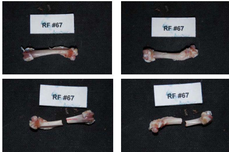
Εικόνα 312: Πρόσθια και οπίσθια όψη του δοκιμίου RF67 πριν και μετά το πείραμα κάμψης
