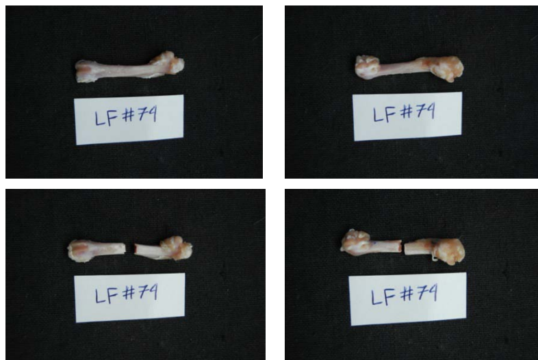
Εικόνα 326: Πρόσθια και οπίσθια όψη του δοκιμίου LF74 πριν και μετά το πείραμα κάμψης
