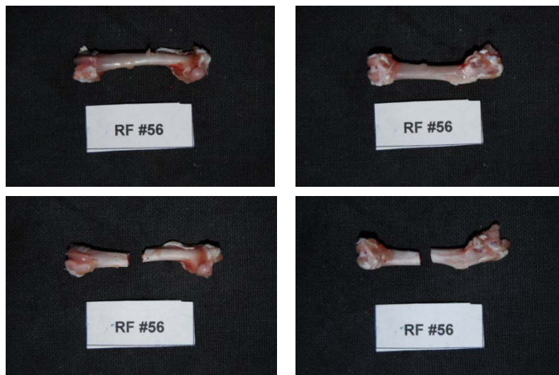
Εικόνα 292: Πρόσθια και οπίσθια όψη του δοκιμίου RF56 πριν και μετά το πείραμα κάμψης
