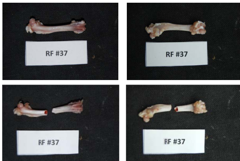
Εικόνα 204: Πρόσθια και οπίσθια όψη του δοκιμίου RF37 πριν και μετά το πείραμα κάμψης
