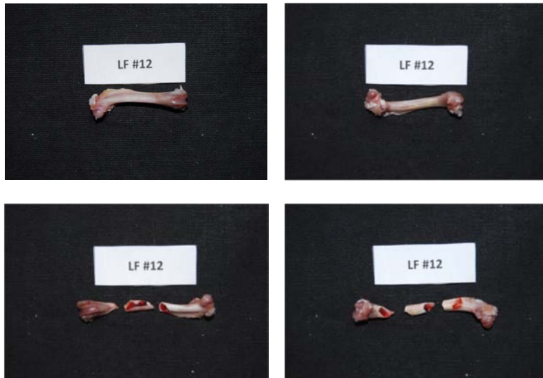
Εικόνα 64: Πρόσθια και οπίσθια όψη του δοκιμίου LF12 πριν και μετά το πείραμα κάμψης
