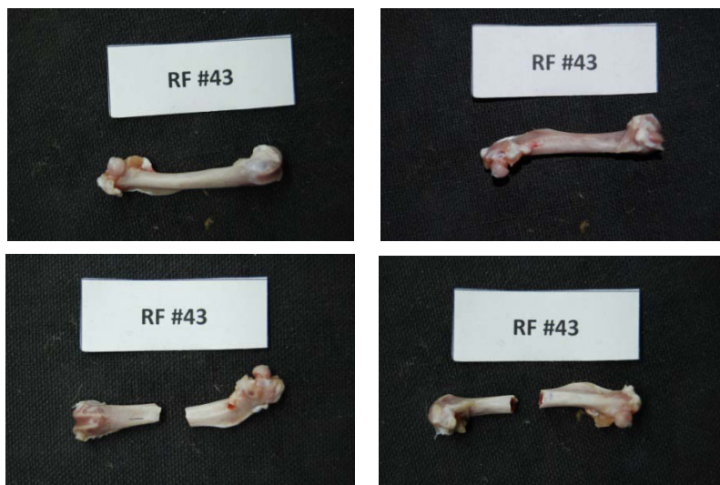
Εικόνα 238: Πρόσθια και οπίσθια όψη του δοκιμίου RF43 πριν και μετά το πείραμα κάμψης
