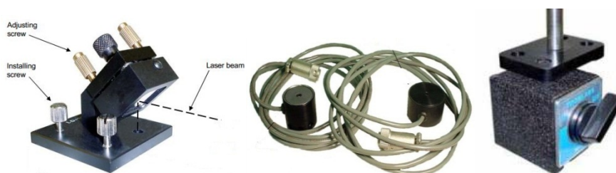
Εικόνα 6.1: Ανακλαστήρας 90°, αισθητήρες, μαγνητική βάση στήριξης
