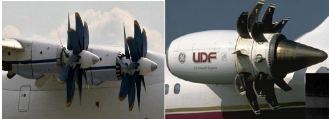
Σχήμα 1.8: Αριστερά Open rotor puller, δεξιά Open rotor pusher
