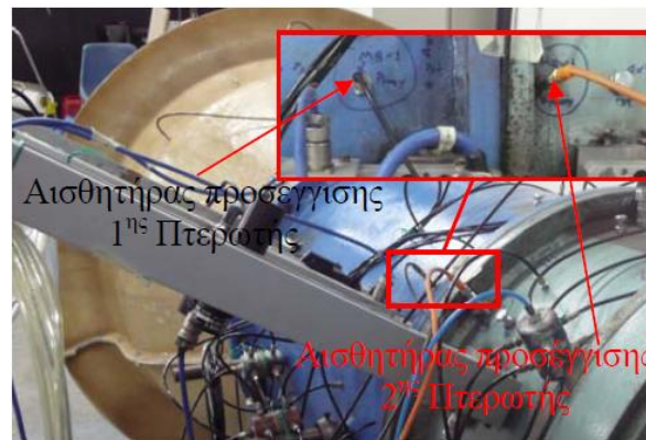
Σχήμα 5.21: Οι αισθητήρες προσέγγισης επάνω στην διάταξη με αποστάτη 2 χορδών.
