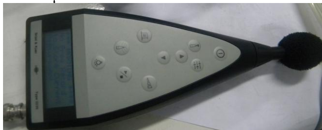
Σχήμα 5.12 Φορητό ντεσιμπελόμετρο (portable sound pressure level meter SLM) της εταιρείας Brüel & Kjaer τύπου 2239A.
