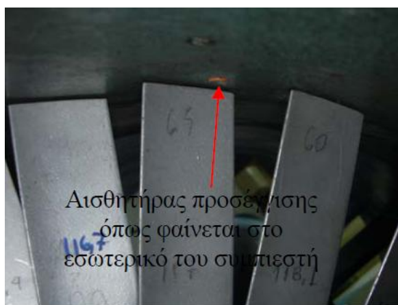
Σχήμα 5.19: Ο αισθητήρας προσέγγισης στο εσωτερικό του συμπιεστή.
