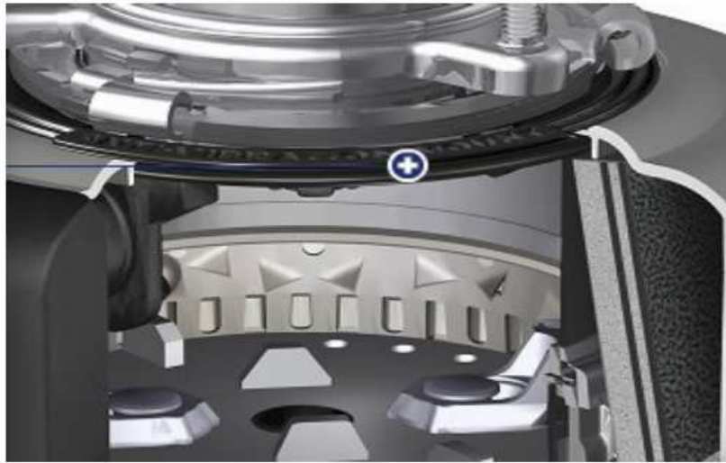
Σχήμα 5.8: Η θέση του μονωτή για τη μείωση των δονήσεων (Chenxi, 2010).
