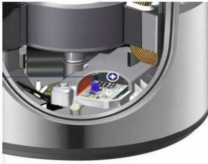
Σχήμα 5.19: Κύκλωμα αισθητήρων εμπλοκών (Chenxi, 2010).
