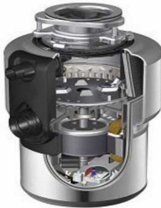
Σχήμα 5.2: Το εσωτερικό ενός σκουπιδοφάγου αποβλήτων τροφίμων (Chenxi, 2010).
