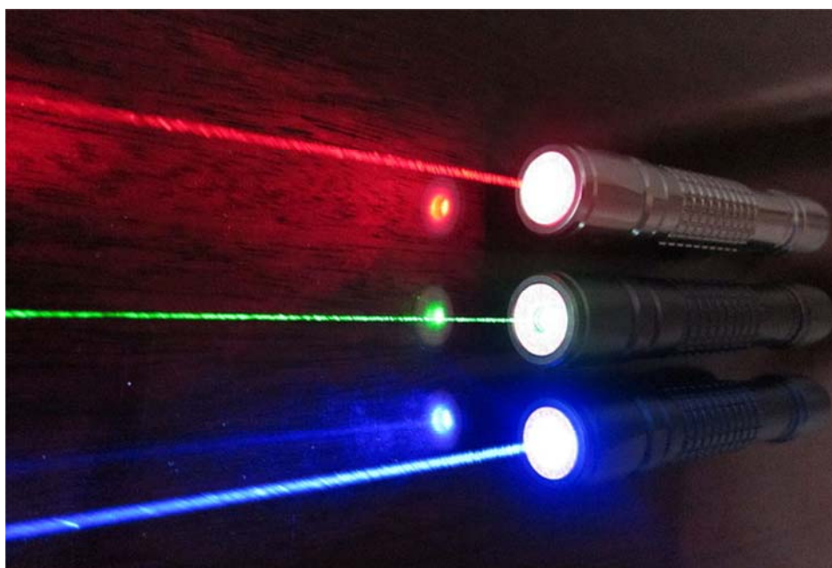
Εικόνα 3-7: Κόκκινο (635 nm), πράσινο (532 nm), και μπλε-ιώδες (445 nm) laser [5]
