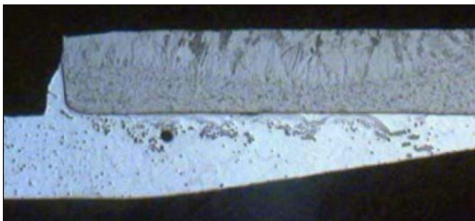
Εικόνα 6-9: Συγκόλληση με laser χάλυβα (πάνω) σε αλουμίνιο
