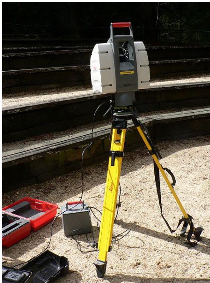
Εικόνα 3.1 Σαρωτής με περιστρεφόμενους καθρέφτες
