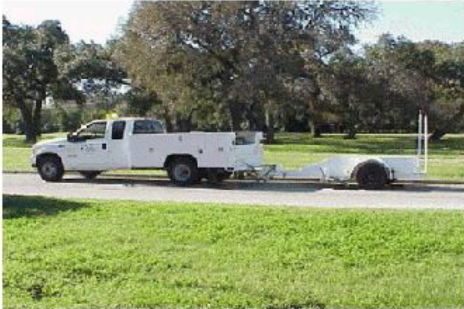
Εικόνα 2.5 Απαραίτητα οχήματα για την διενέργεια μετρήσεων ολισθηρότητας (Πηγή: Lenz, 2011)
