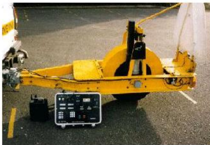
Εικόνα 2.3 Bump Integrator Πηγή (Ευαγγελίδης, 2004)
