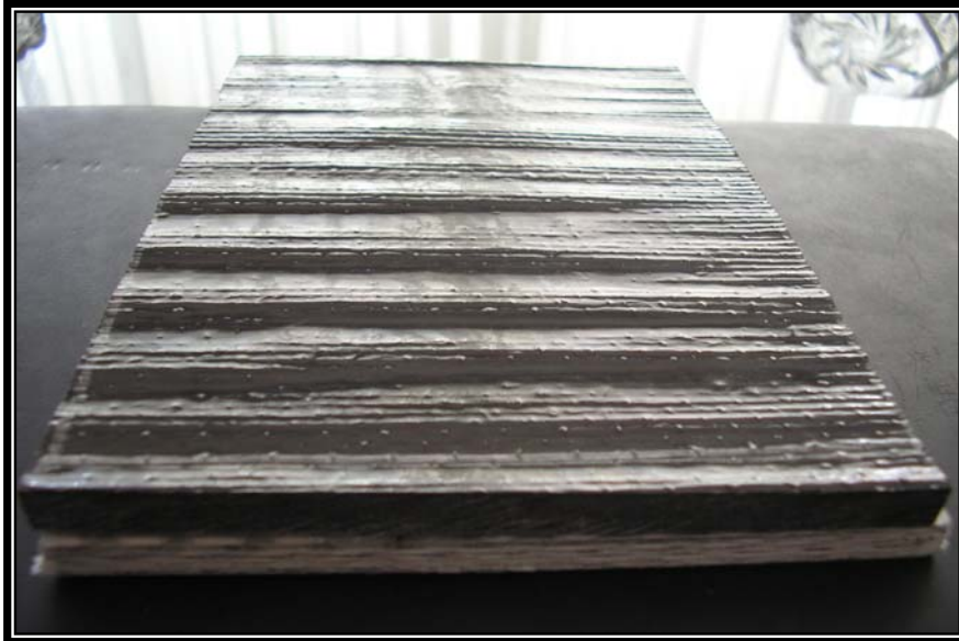
Σχήμα 6.28 : Δοκίμιο CFRP hand layup εμφάνιση κυματοειδούς επιφάνειας.
