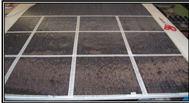
Σχήμα 6.6 : Χάραξη του σχήματος και των διαστάσεων των στρώσεων.
