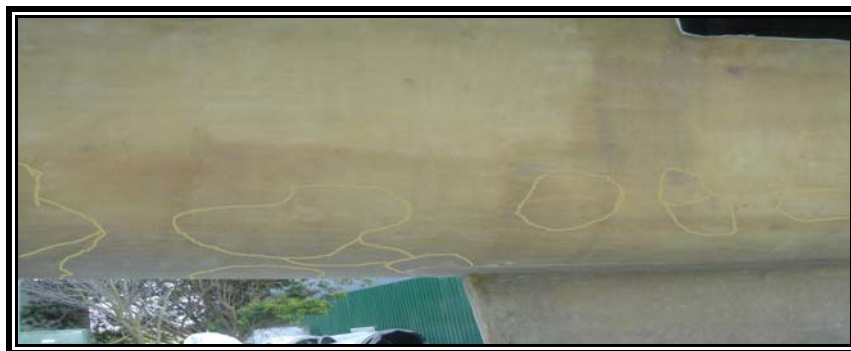
Σχήμα 1.20 : Αποκολλήσεις στρώσεων στην γάστρα ιστιοπλοϊκού μετά την απόξυση του gel coat και έλεγχο με μη καταστροφικές μεθόδους. Το περίγραμμα των αποκολλήσεων έχει σημειωθεί με κίτρινη κιμωλία.
