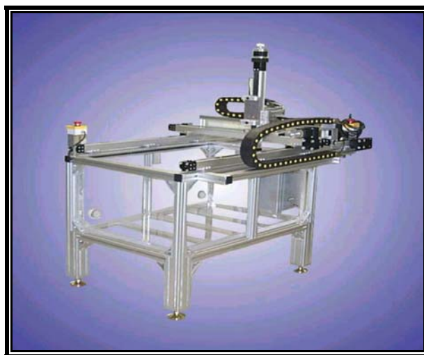
Σχήμα 7.1 : Δεξαμενή εμβάπτισης και το φορείο κίνησης της κεφαλής της διάταξης ULTRAPAC II.
