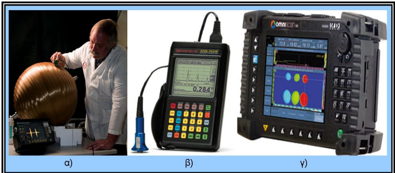
Σχήμα 5.1 : α) Χειροκίνητη εξέταση με φορητή συσκευή υπερήχων σε δοχείο πίεσης από σύνθετα υλικά β) φορητή συσκευή υπερήχων γ) φορητή συσκευή με δυνατότητες εντοπισμού και διαστασιολόγησης ατελειών.
