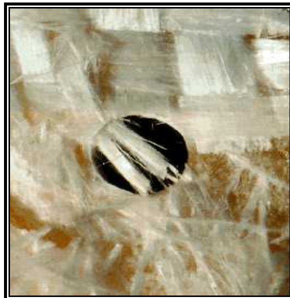
Σχήμα 1.18 : Αποκόλληση στρώσεων κατά τη δημιουργία οπής.
