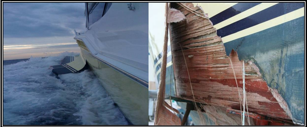
Σχήμα 1.19 : Αποτέλεσμα της αποκόλλησης των στρώσεων σε γάστρα σκάφους αναψυχής.
