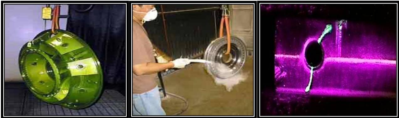
Σχήμα 2.2 : Τα τρία στάδια της μεθόδου των δεισδυτικών υγρών
