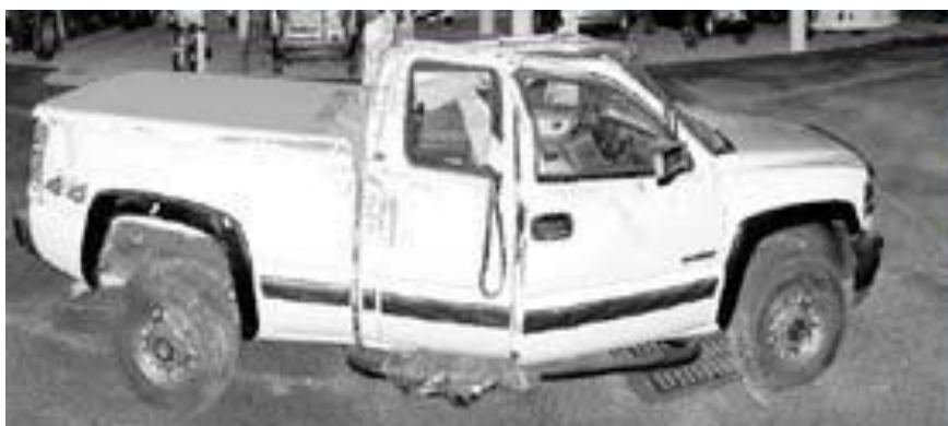
Εικόνα 2.6 : Νέφος σημείων αυτοκινήτου που έχει υποστεί ζημιά ( www.gilbertengineering.net ).
