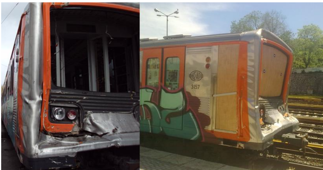
Εικόνα 3.6 : Το βαγόκι πριν (αριστερά) και μετά (δεξιά) την τοποθέτηση χαρτιού και κόντρα πλακέ.
