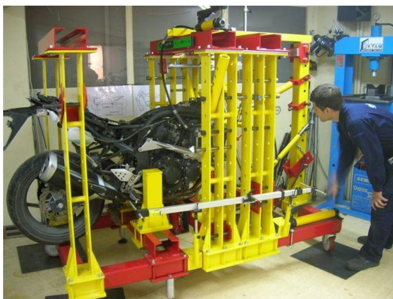
Εικόνα 2.5 : Καλίμπρα ελέγχου του πλαισίου μοτοσυκλέτας ( www.moto-terzidis.gr ).
