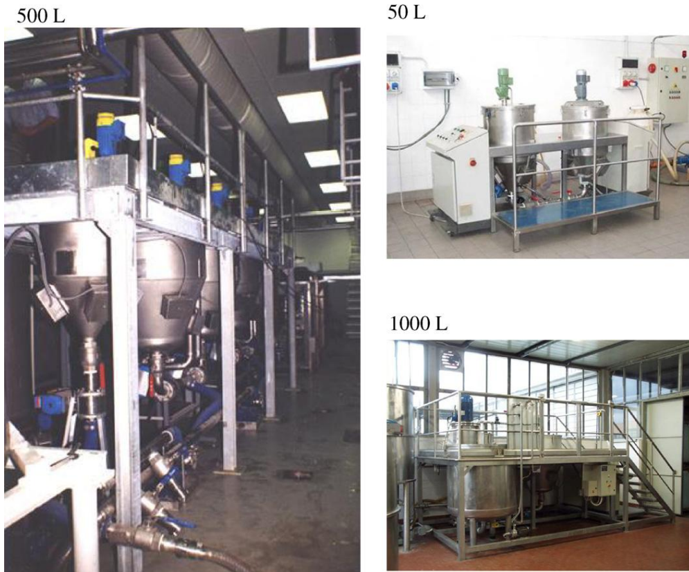
Εικόνα 20: Βιομηχανικός Εξοπλισμός Υπέρηχων 50, 500 & 1000 L
