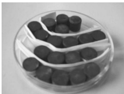
Εικόνα 4-7 Ηλεκτρόδια Τιτανίου μετά την ηλεκτροαπόθεση
