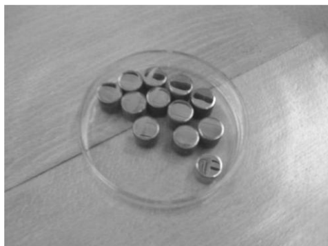
Εικόνα 4-6 Ηλεκτρόδια Τιτανίου πριν την ηλεκτροαπόθεση
