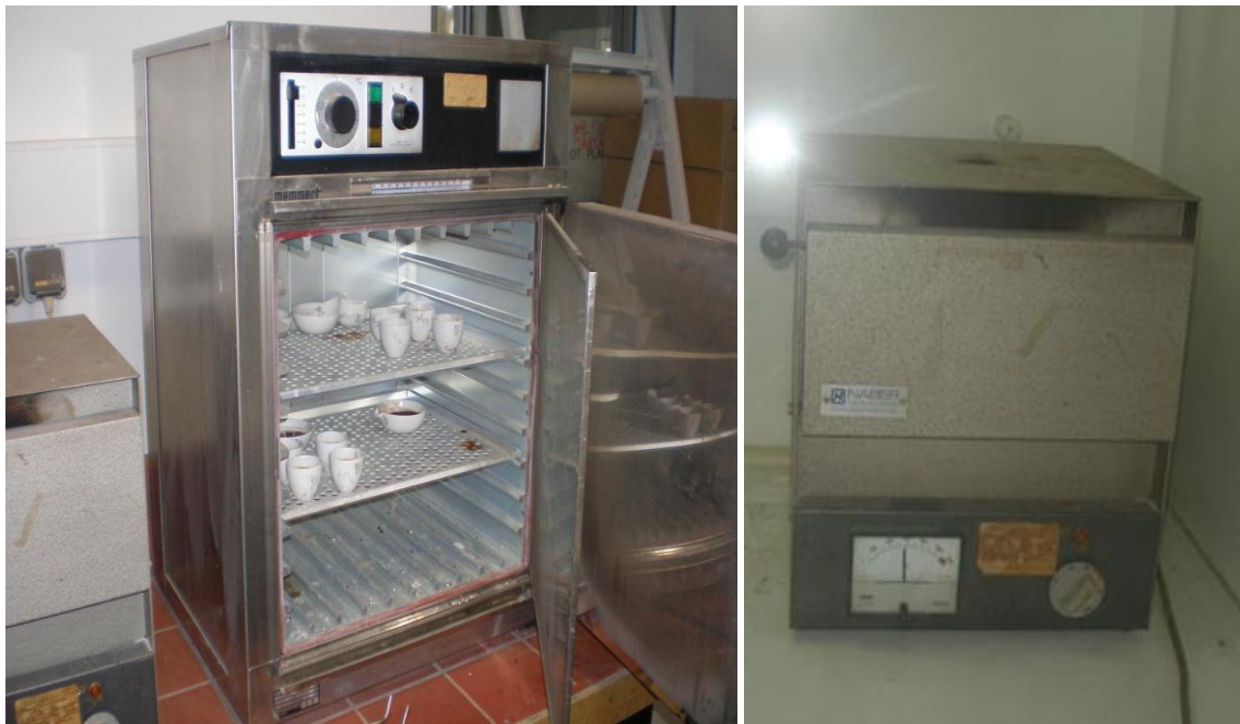
Φωτογραφία 3.6. Φούρνοι για τον προσδιορισμό ολικών (αριστερά) και οργανικών (δεξιά) στερεών
