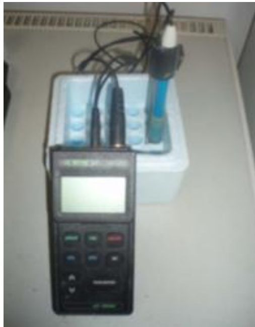
Φωτογραφία 3.10. Φορητό pHμετρο τύπου 315i της WTW
