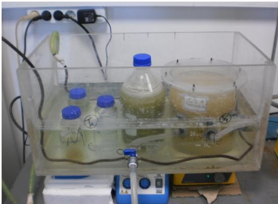
Φωτογραφία 3.4. Εργαστηριακή διάταξη του bath με τους δυο ASBR και τους μικρούς αντιδραστήρες πειραμάτων προσρόφησης
