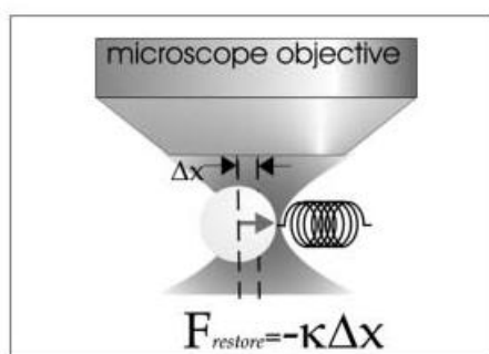
Σχήμα 3.1: Το μηχανικό ανάλογο της οπτικής παγίδας. Αν το σωματίδιο αποκλίνει κατά \Delta x από το σημείο παγίδευσης δρα σε αυτό μια δύναμη επαναφοράς F_{restore} = -\kappa\Delta x . (εικόνα από Dholakia et al., 2007)
