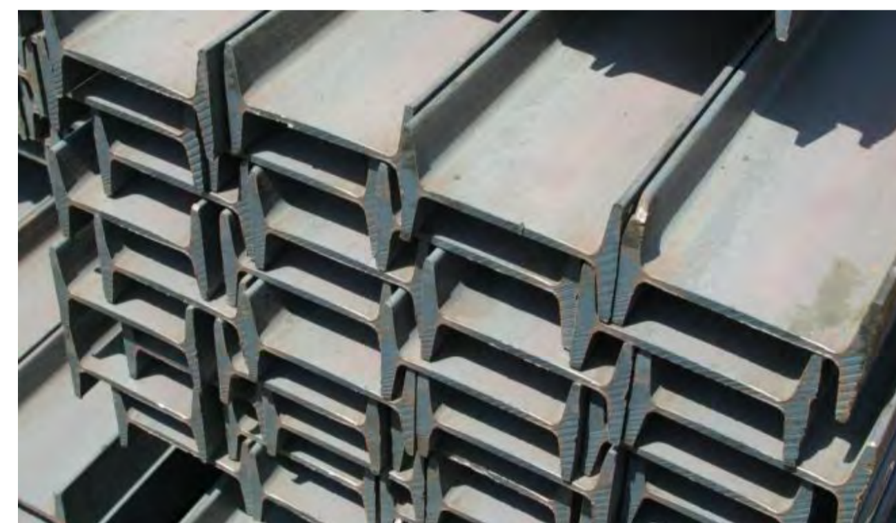
Μεταλλικοί δοκοί τύπου HEB διαστάσεων 100x100.
