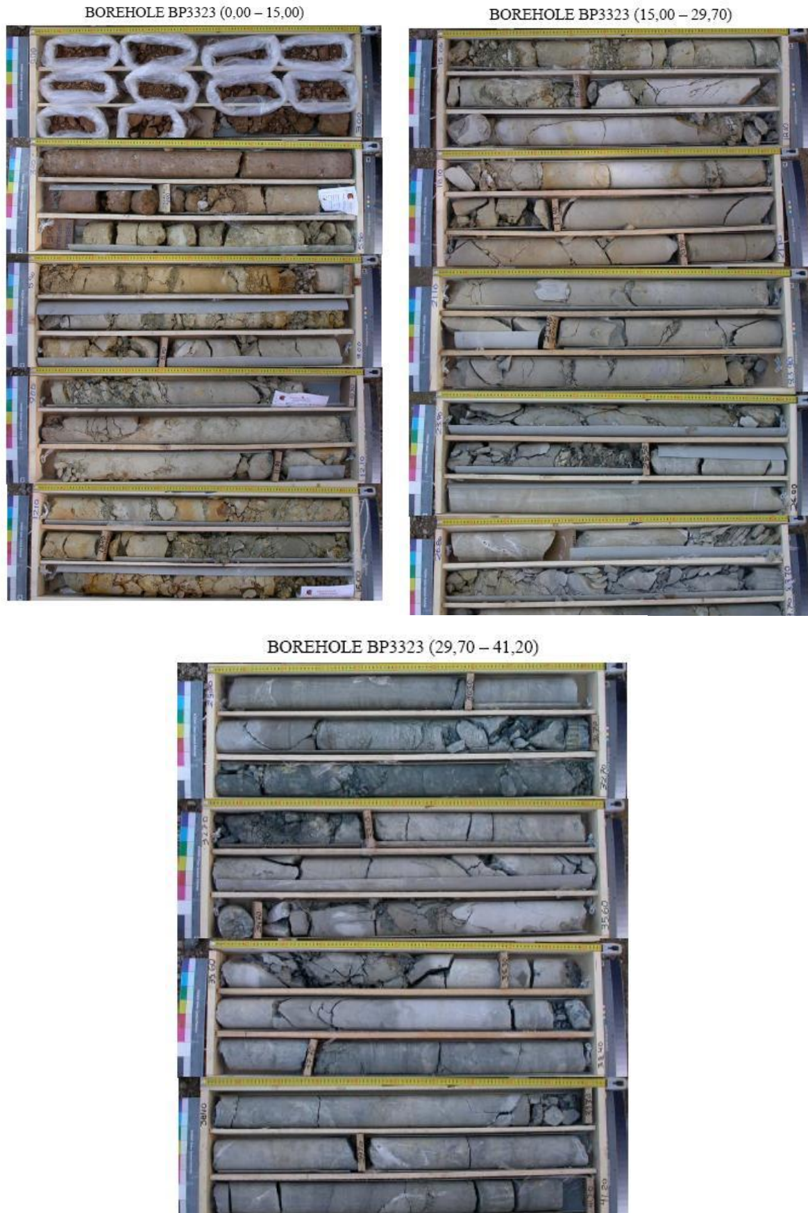
Σχήμα 4.5: Πυρήνες γεωτρήσεων δειγματοληπτικής γεώτρησης BP3323
