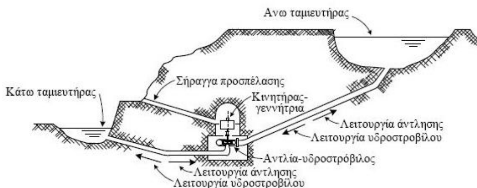
Σχήμα 2.6 Σχηματική απεικόνιση του συστήματος Αντλησιοταμίευσης [3]
