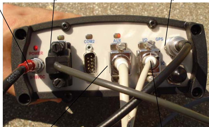
εικόνα 3.19 – Συνδεσμολογία στις θύρες του Receiver
