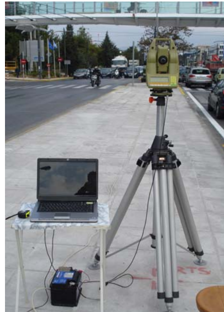
εικόνα 5.14 - γεωδαιτικός σταθμός RTS
