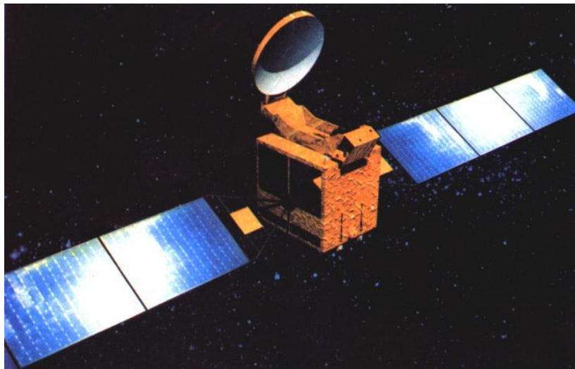
Σχήμα 4-1: Σύστημα Δορυφόρου-Στρεφόμενου Προσαρτήματος (κεραία) Τηλεπικοινωνιακός δορυφόρος DFH-3 (ή ChinaSat-6) [w15]
