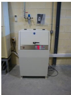
Εικόνα 3.5 : Συσκευή δονούμενης λειοτριβίσης με αχάτη Fritch Vibrating Cup Mill (“pulverisette 9”),
