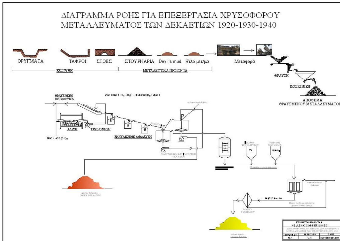
Εικόνα 2.7: Διάγραμμα ροής για επεξεργασία χρυσοφόρου μεταλλεύματος των δεκαετιών 1920-1930-1940 (πηγή: HCM, Ελληνικά Μεταλλεία Χαλκού)
