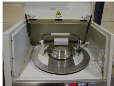
Εικόνα 3. 7: Μηχανή λειοτριβίσης με αχάτη Agate 99.9% SiO 2 grinding set
