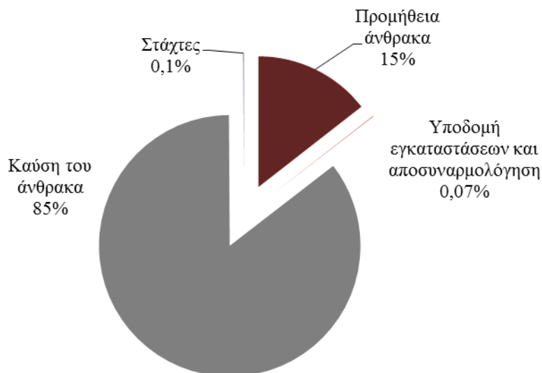
Διάγραμμα 3.1 Εκπομπές αερίων θερμοκηπίου σε σταθμό παραγωγής με καύση άνθρακα
