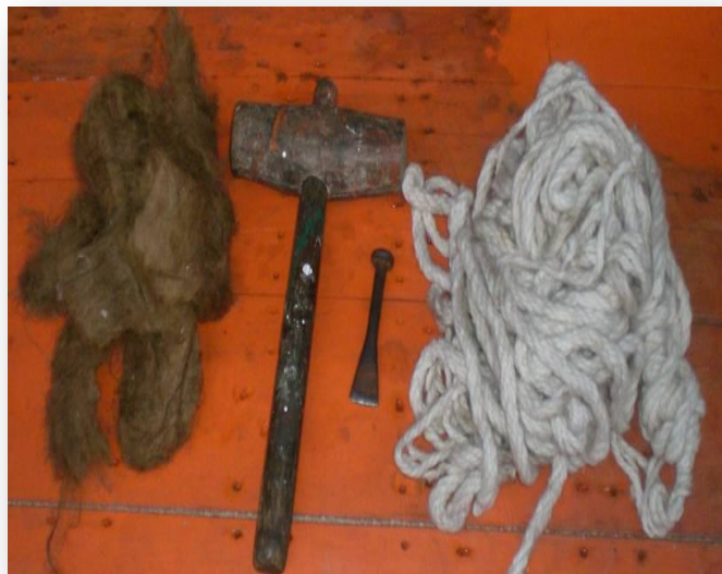
Εικόνα 4.32 Εργαλεία καλαφάτισματος, από αριστερά κατραμόστουπο, ματσόλα, κοπίδι, στουπί.
