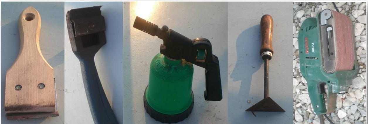
Εικόνα 4.8 Εργαλεία για κάψιμο, ξύσιμο και τρίψιμο
