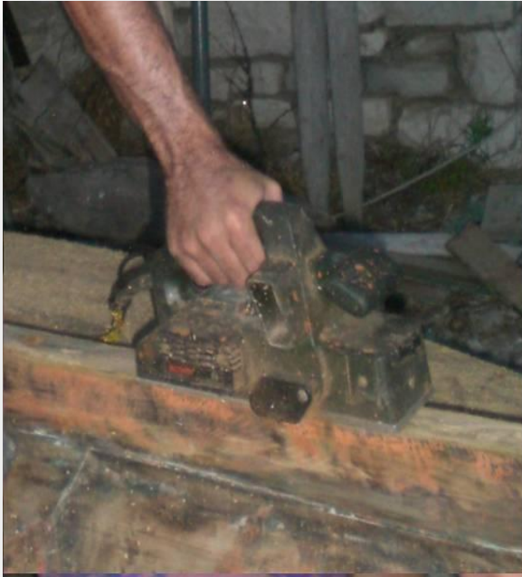
Εικόνα 4.22 Πλάνεμα της καρίνας με ηλεκτρική χειροκίνητη πλάνη
