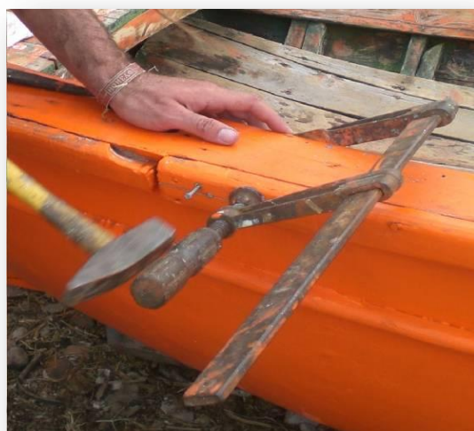
Εικόνα 4.29 Κάρφωμα του ζωναριού της κουπαστής
