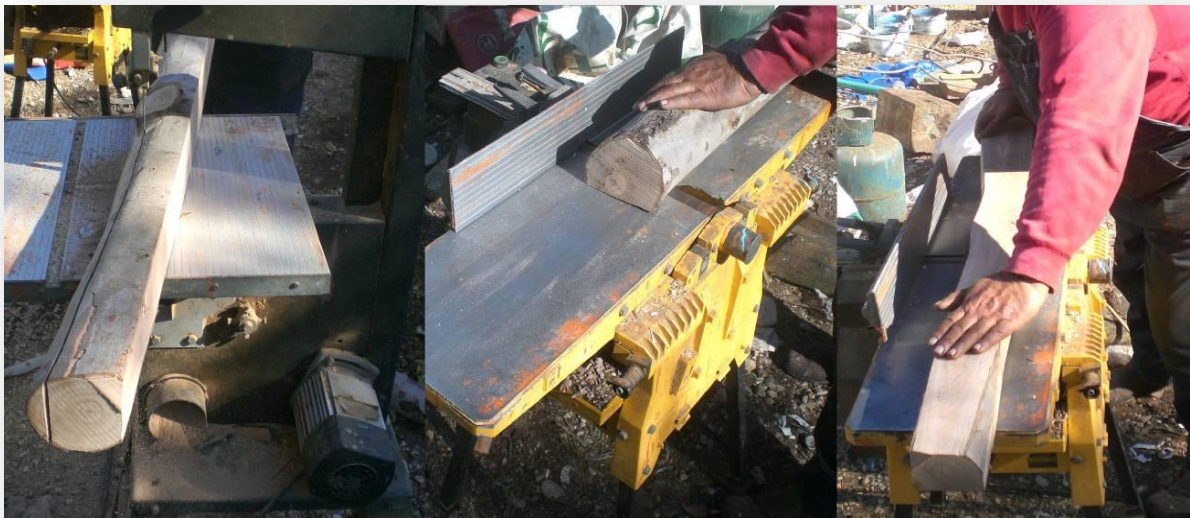
Εικόνα 4.43 Κατασκευή κόντρα-καρίνας, από ξύλο ευκαλύπτου. Κοπή σε επιδαπέδια κορδέλα και πλανάρισμα
