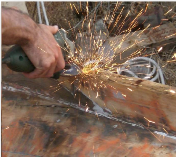
Εικόνα 4.16 Με τροχό για να χωρίσουμε τη περτσινωμένη τζαβέτα από το περικόχλιο
