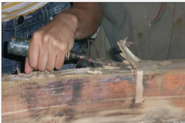
Εικόνα 4.15 Με σκαρπέλο σκάφτηκε η καρίνα για να επέμβουμε στο περικόχλιο της τζαβέτας.
