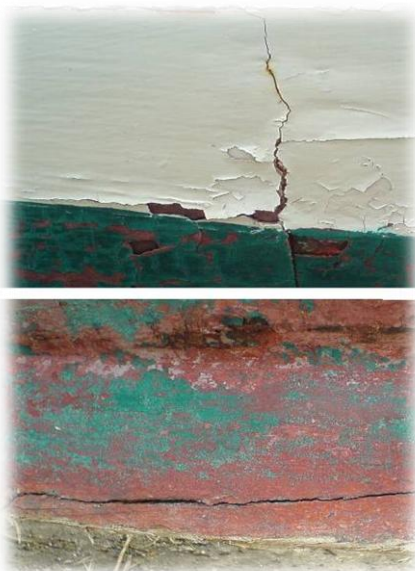
Εικόνα 4.3 Ρίκνωση στα σόκορα και σχάση στη καρίνα.
