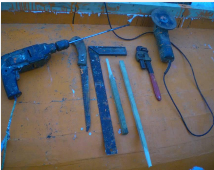
Εικόνα 4.52 Εργαλεία που χρησιμοποιήθηκαν στη τοποθέτηση της κόντρα-καρίνας
