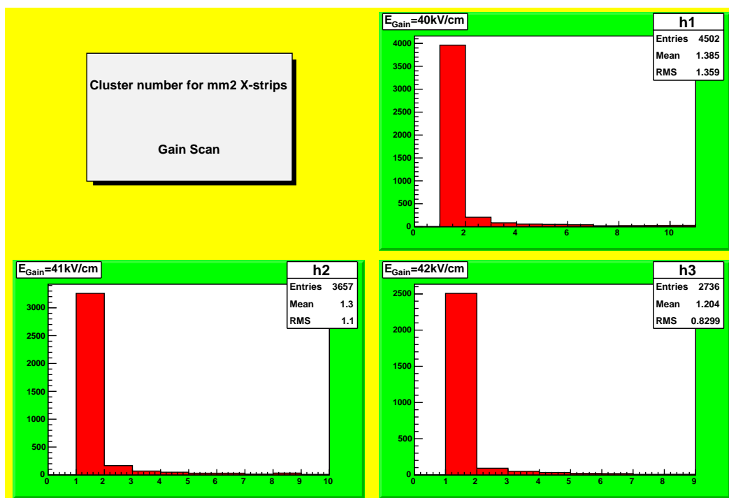
Σχήμα 6.46: Αριθμός clusters για τα X - strips του RD51Tmm2 για διαφορετικά πεδία ενίσχυσης
