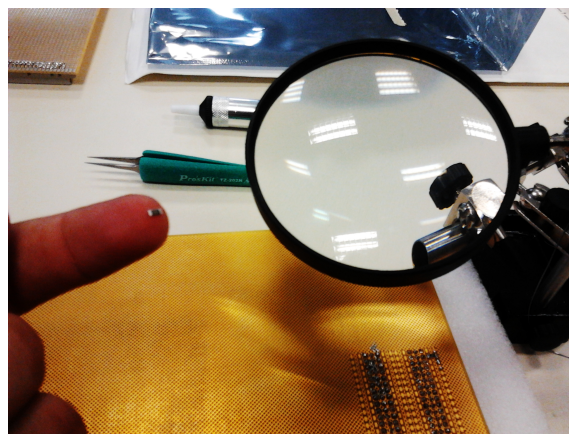
(β) Συγκόλληση αντιστάσεων SMD
