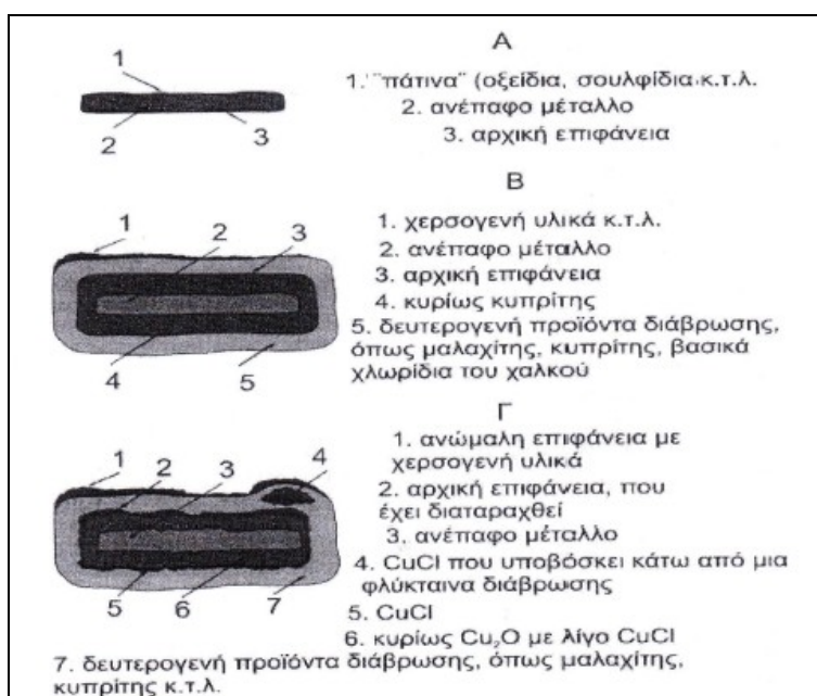
Εικόνα 3-1 Σχηματική αναπαράσταση διαβρωμένων αντικειμένων [2]
