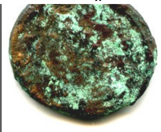
Εικόνα 5-1 Νόμισμα διαβρωμένο από την «ασθένεια του χαλκού»
