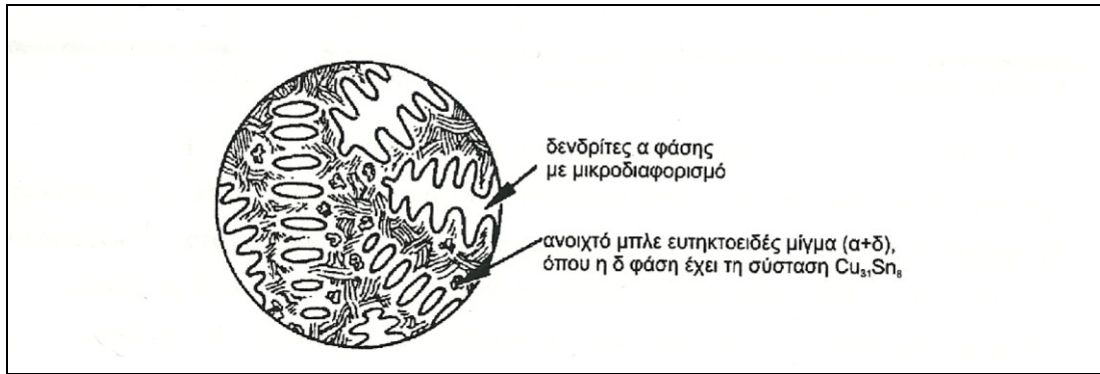
Εικόνα 1-5 μικροδομή ευτηκτοειδούς τύπου σε κράμα χαλκού-κασσιτέρου [11]
