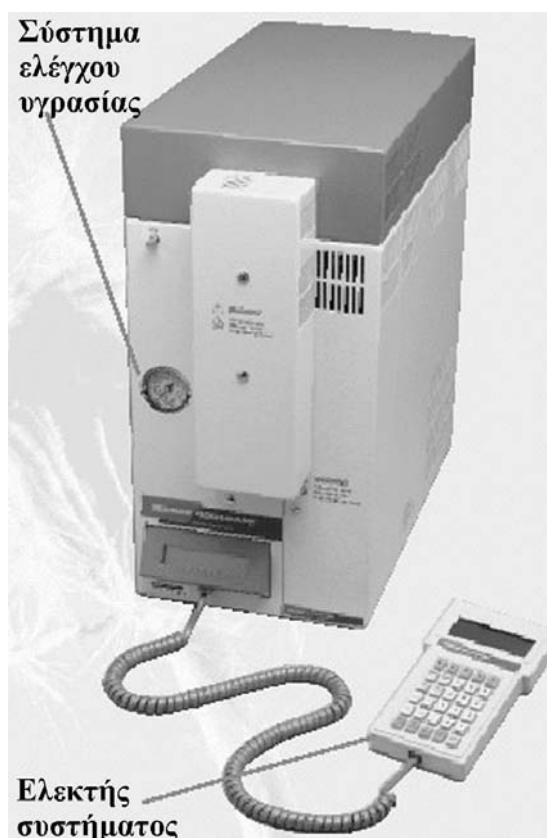
Εικόνα 3.7: Η εξωτερική όψη του θερμικού εκροφητή AEROTrap 6000 της εταιρείας Tekmar.
