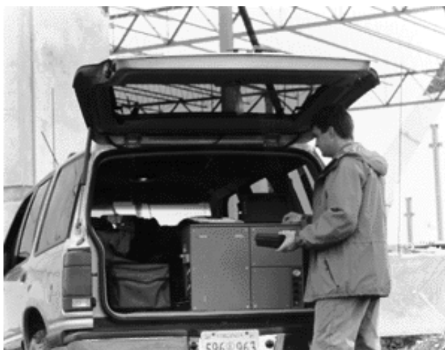
Εικόνα 1.5: Το μεταφερόμενο GC/MS, SpectraTrak 572, της εταιρείας Viking κατά την έναρξη της τοποθέτησης στο πεδίο
