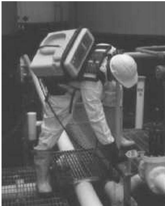
Εικόνα 1.7: Το φορητό GC/MS HAPSITE, όπως μεταφέρεται και λειτουργεί στο πεδίο.
