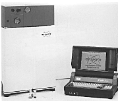
Εικόνα 1.4.: Το κινητό GC/MS EM640 της Bruker
