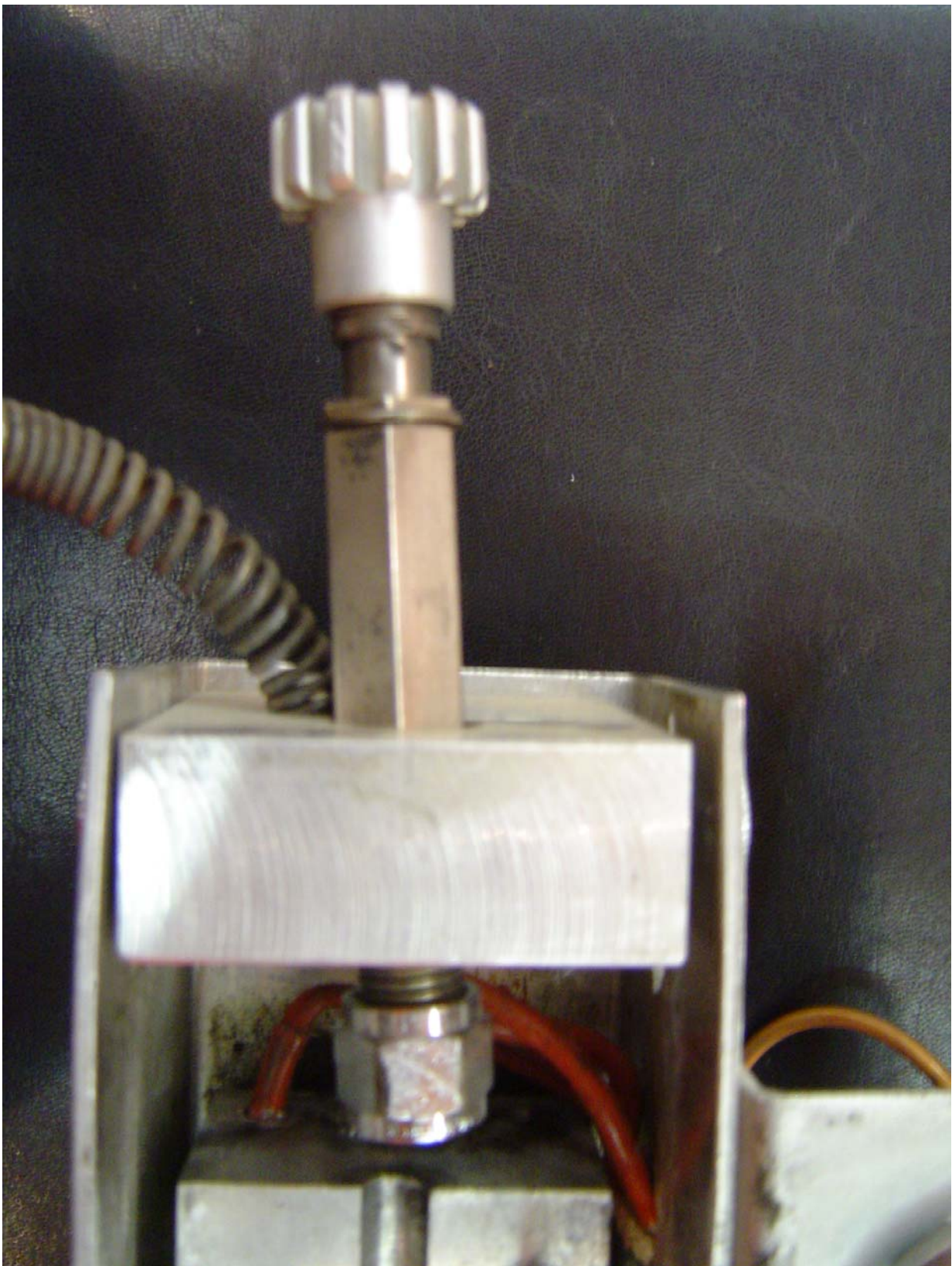
Εικόνα Π.3.6: Άνω μέρος του thermal desorption block. Στο πάνω μέρος φαίνεται η βιδωτή υποδοχή για septum ώστε να μπορούν να γίνουν ενέσεις υγρών.
