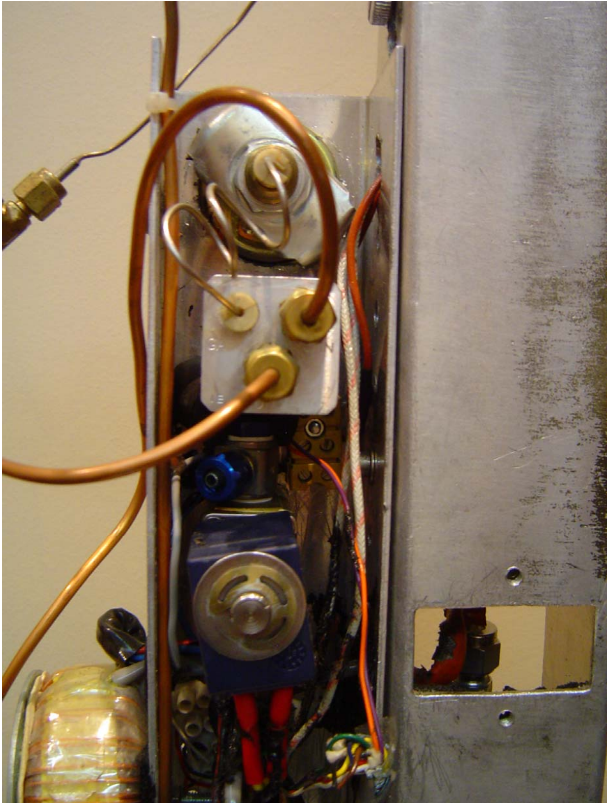
Εικόνα Π.3.2: Πίσω όψη του οργάνου. Στο πάνω μέρος φαίνεται ο ρυθμιστής πίεσης, το μανόμετρο και η βαλβίδα on/ off του υγρού αζώτου.
