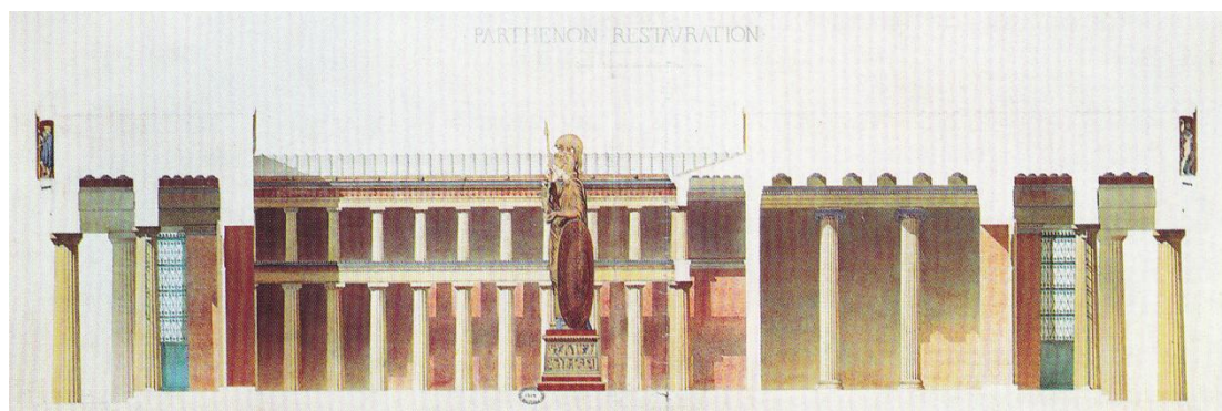
Εικ.1.1: Σχεδιαστική αποκατάσταση της κατά μήκος τομής του Παρθενώνα. [1]
