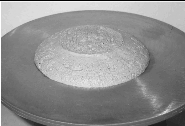
Εικ.V.4.: Δοκιμή Εξάπλωσης
