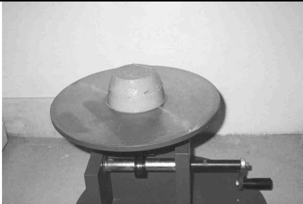
Εικ.V.3.: Δοκιμή Εξάπλωσης
