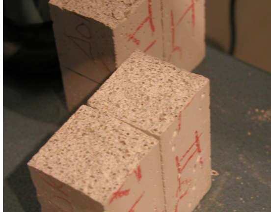
Εικ.V.17.: Δοκιμή αντοχής σε κάμψη
