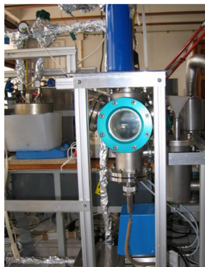
Σχήμα 5: Αντιδραστήρας ψυχρών τοιχωμάτων μονού υποστρώματος στο CIRIMAT-CNRS, ENSIACET, Toulouse (παρόμοιος με του σχήματος 4)
