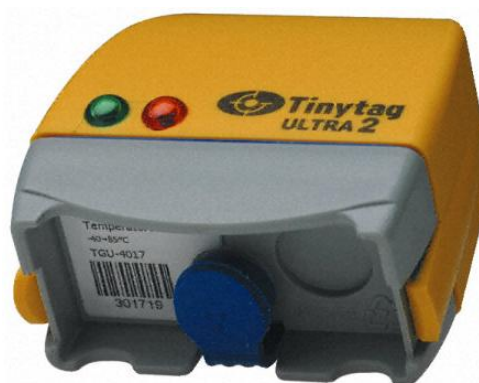
Εικόνα 4.1: Θερμοϋγρόμετρο «Tinytag Ultra 2»[31]
