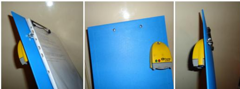
Εικόνα 4.7: Σημειωματάρια με θερμοϋγρόμετρο στο πίσω μέρος που χρησιμοποιήθηκε στις μετρήσεις
