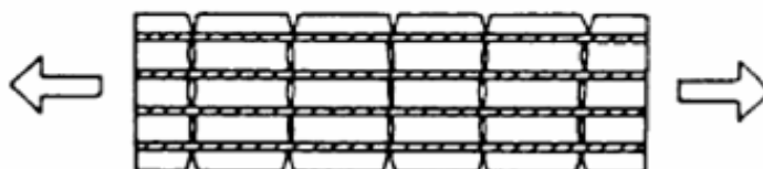
Σχήμα α: Ρηγμάτωση ρητίνης πριν τη θραύση των ινών
